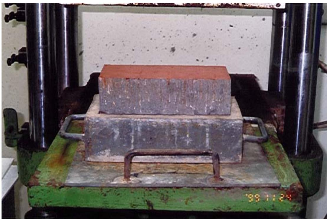
照片 4.3：高壓地磚壓製情形
