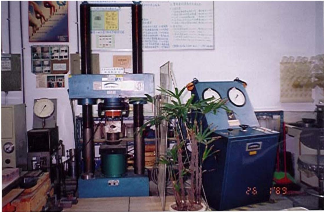
照片 4.7：岩石 200ton 油壓壓縮機
