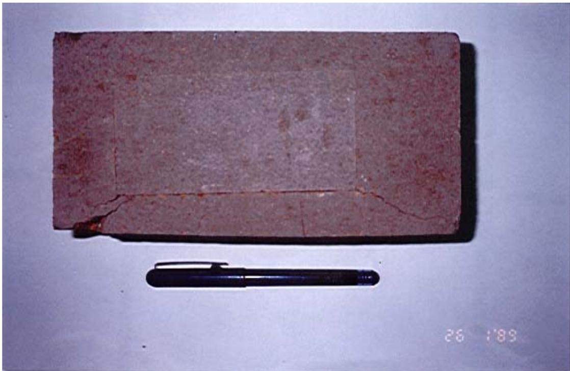
照片 4.8：經抗壓強度測試後之樣品
