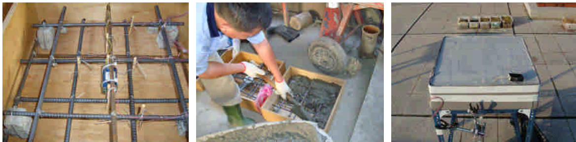
圖 3-12 研究團隊對於鋼筋混凝土實驗試體之施作經驗
