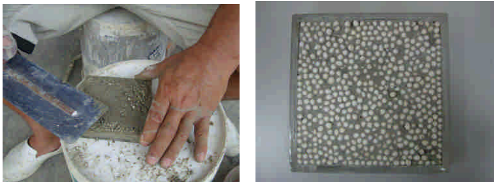
圖 5-3 macroPCM 抵石層施作過程(左)與成品(右) (資料來源：本研究整理)
