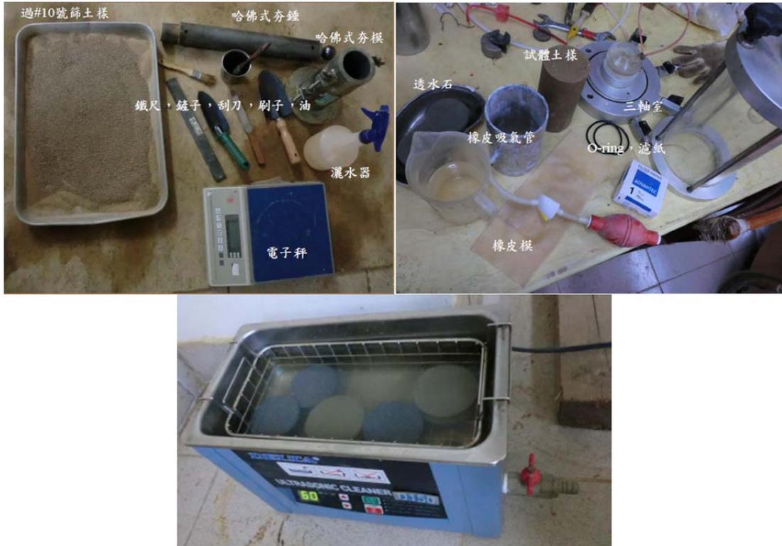
圖 3-6 砂質土壤滲透試驗儀器
