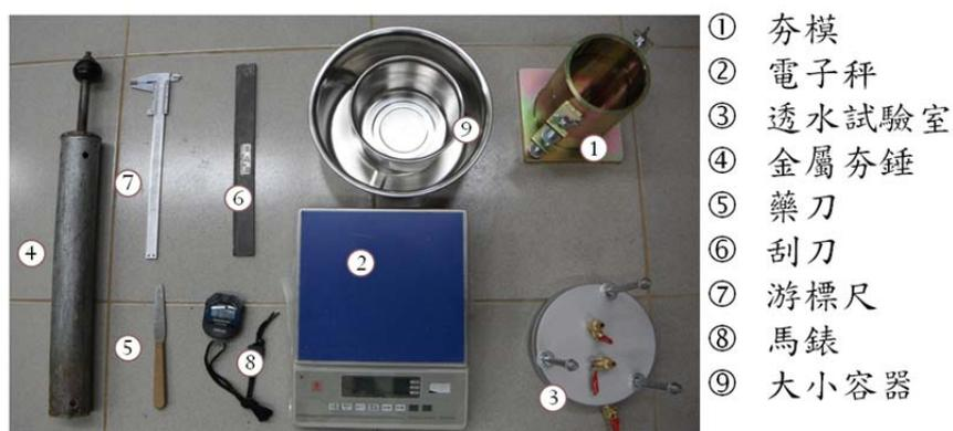
圖 3-3 砂質土壤滲透試驗(一)
