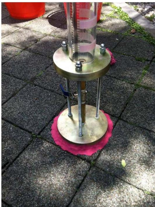
圖 4-1 油性黏土固定透水試驗儀
