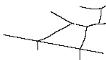
混凝土初期乾燥產生的龜裂
