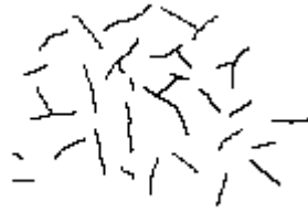
因水泥異常而產生的龜裂
