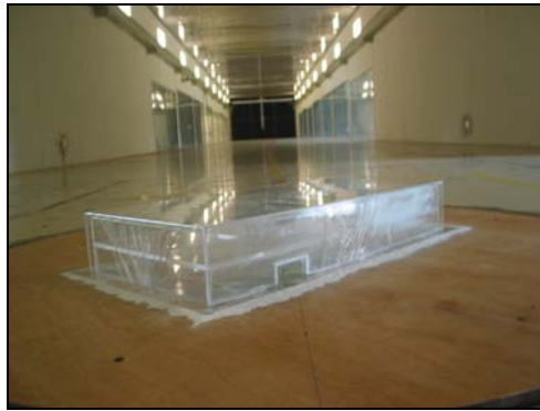
圖 3-3. 雙層矩形廠房模型試驗設置圖 資料來源：本研究整理
