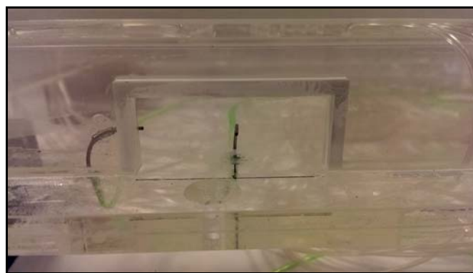
圖 3-8. 矩形廠房模型模型進風口壓力管設置圖 資料來源：本研究整理
