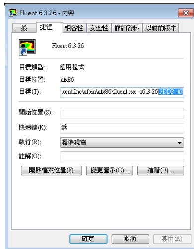
圖 4-3. FLUENT 求解器六核心運算設定 資料來源：本研究整理
