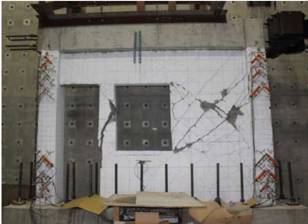
圖 4- 52 試體三在+1.5% drift 下裂縫情況
