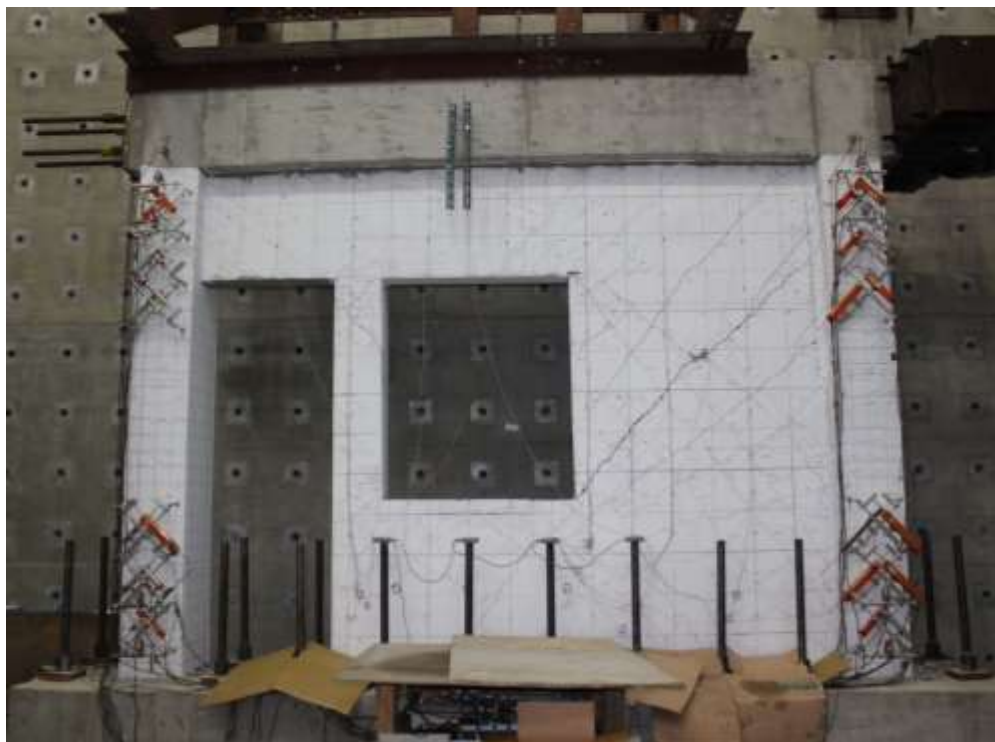
圖 4- 40 試體三在+0.5% drift 下裂縫情況
