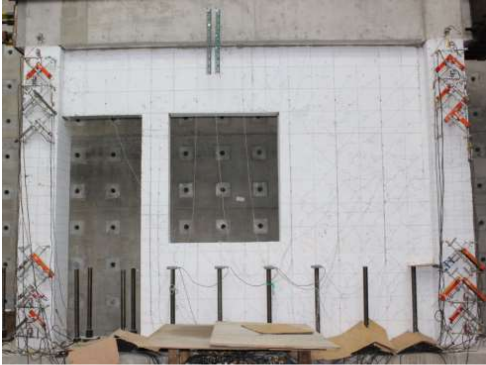
圖 4- 70 試體六在 -0.25% drift 下裂縫情況
