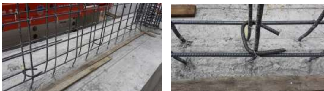
圖 3- 53 試體一至四牆體繫筋，模擬典型街屋間距
