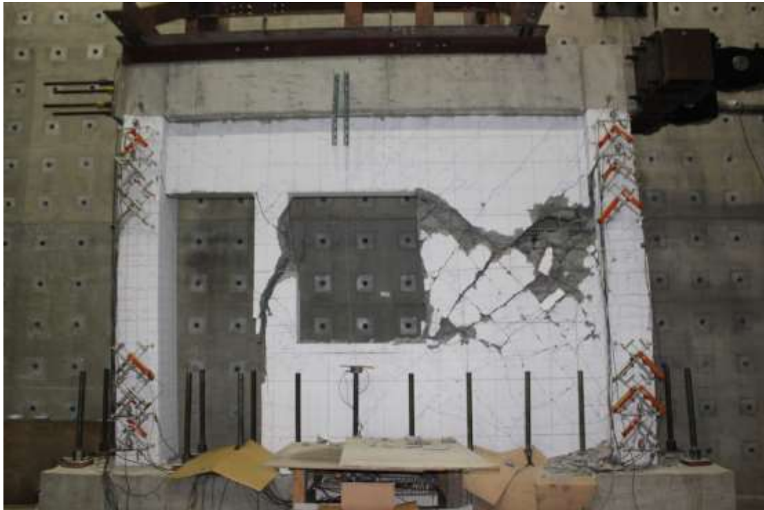
圖 4- 64 試體三在 -3.0% drift 下裂縫情況
