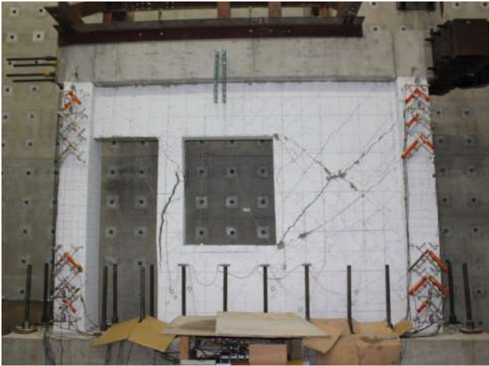
圖 4- 44 試體三在+0.75% drift 下裂縫情況
