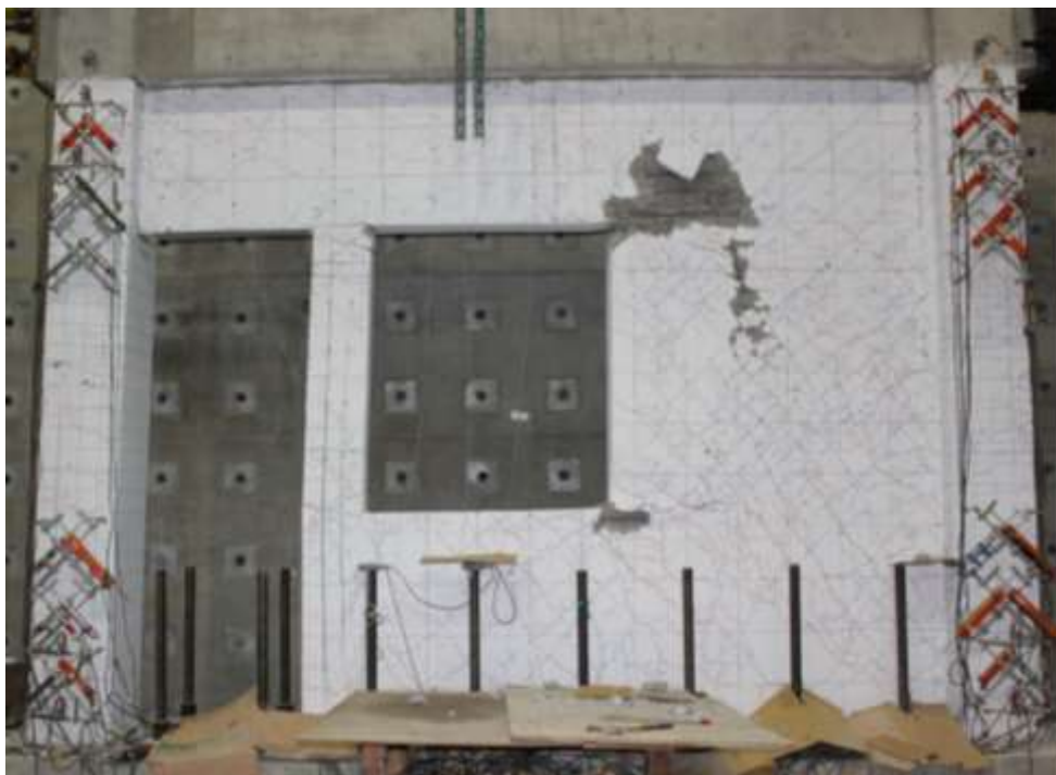
圖 4- 95 試體六在-1.5% drift 下裂縫情況
