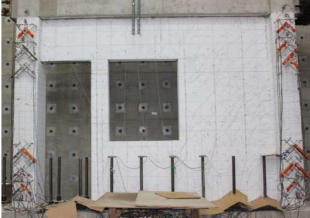
圖 4- 73 試體六在+0.375% drift 下裂縫情況
