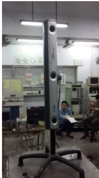
圖 3- 19 架設 NDI 量測受拉鋼筋之伸長率
