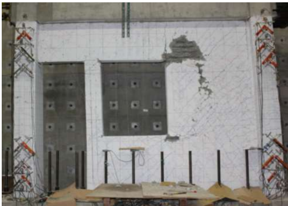
圖 4- 98 試體六在+2.0% drift 下裂縫情況
