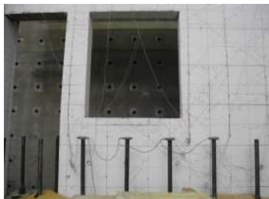
圖 4- 31 試體 -0.25% drift 窗裂縫
