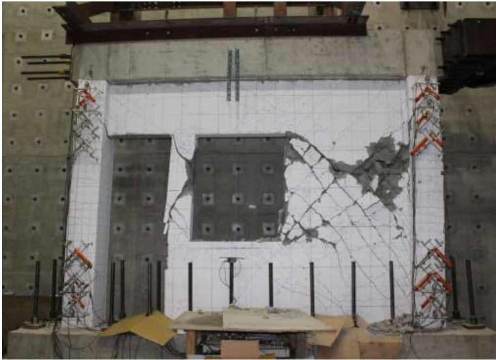
圖 4- 60 試體三在 -2.0% drift 下裂縫情況
