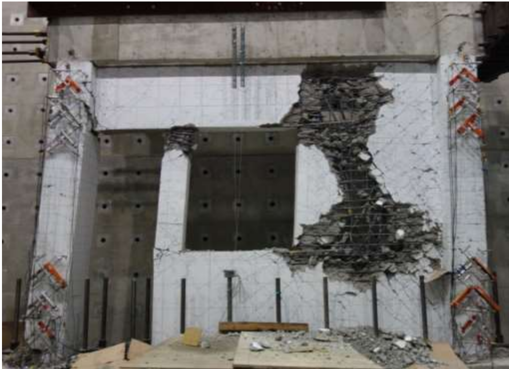
圖 4- 122 試體六在-5.0% drift 下裂縫情況
