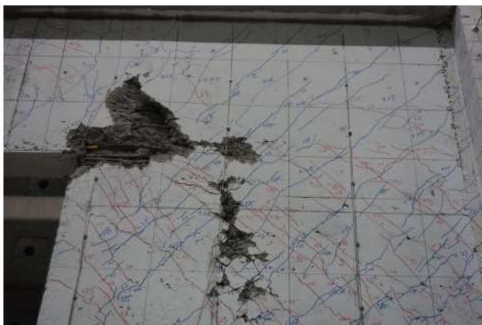
圖 4- 95 試體六在-1.5% drift 下裂縫情況
