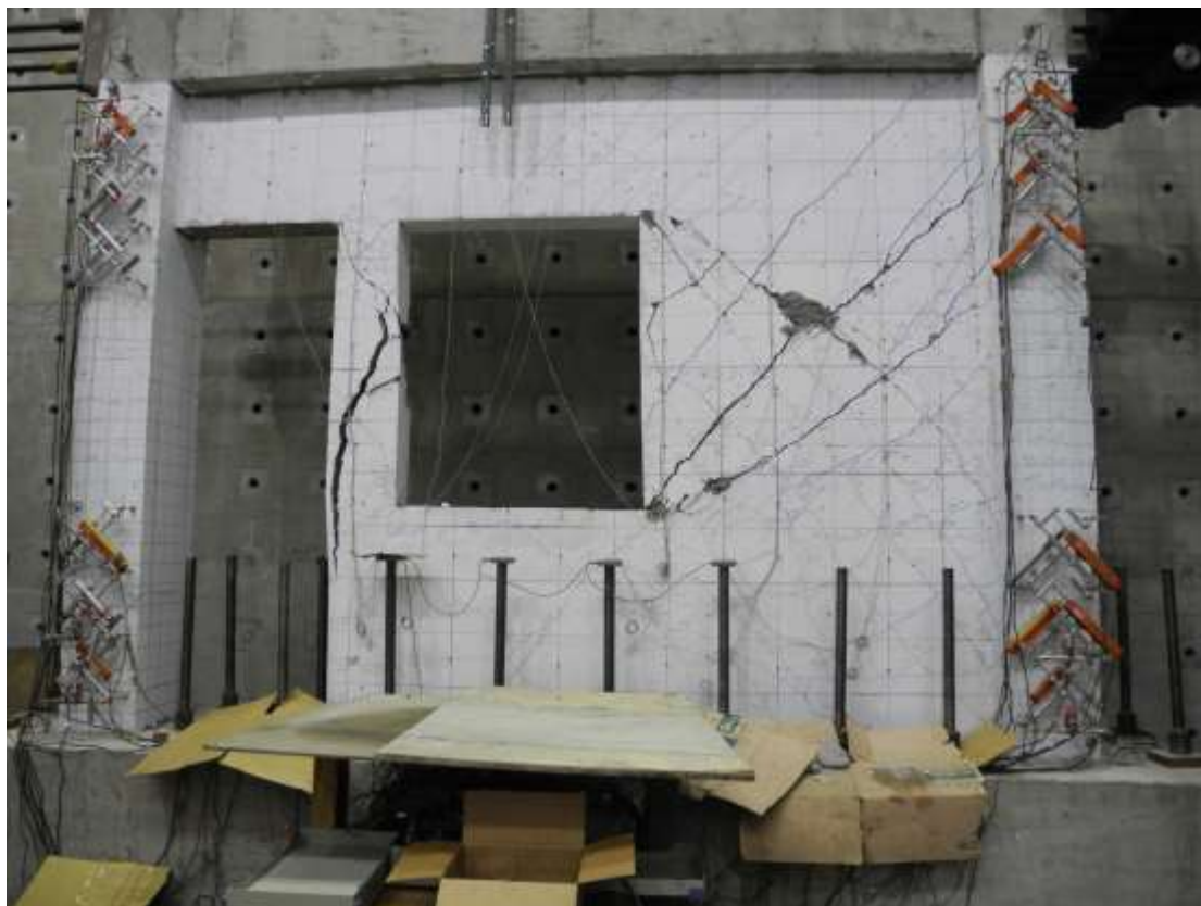
圖 4- 48 試體三在+1.0% drift 下裂縫情況
