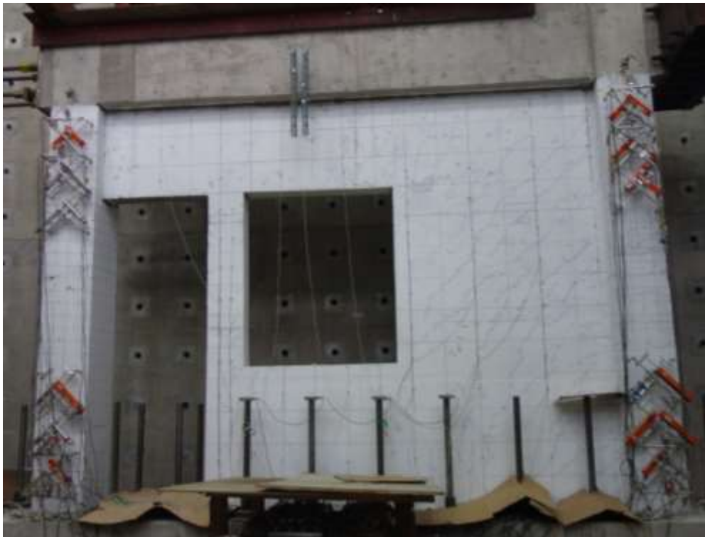
圖 4- 66 試體六在+0.25% drift 下裂縫情況
