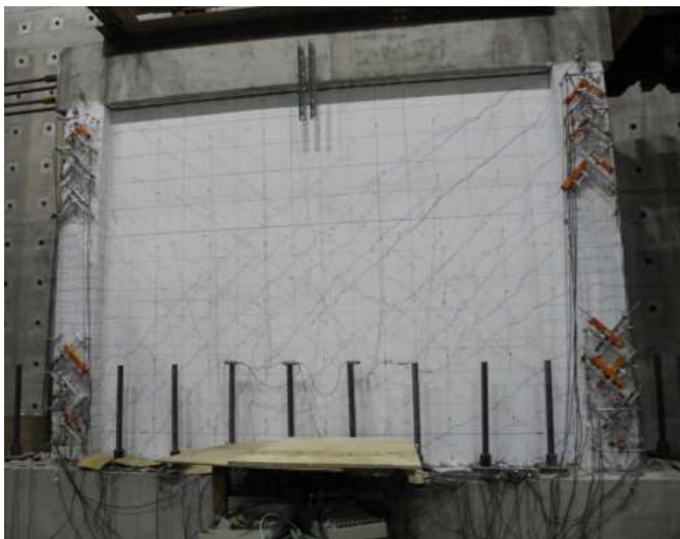
圖 4- 21 試體二在+1.0% drift 下裂縫情況
