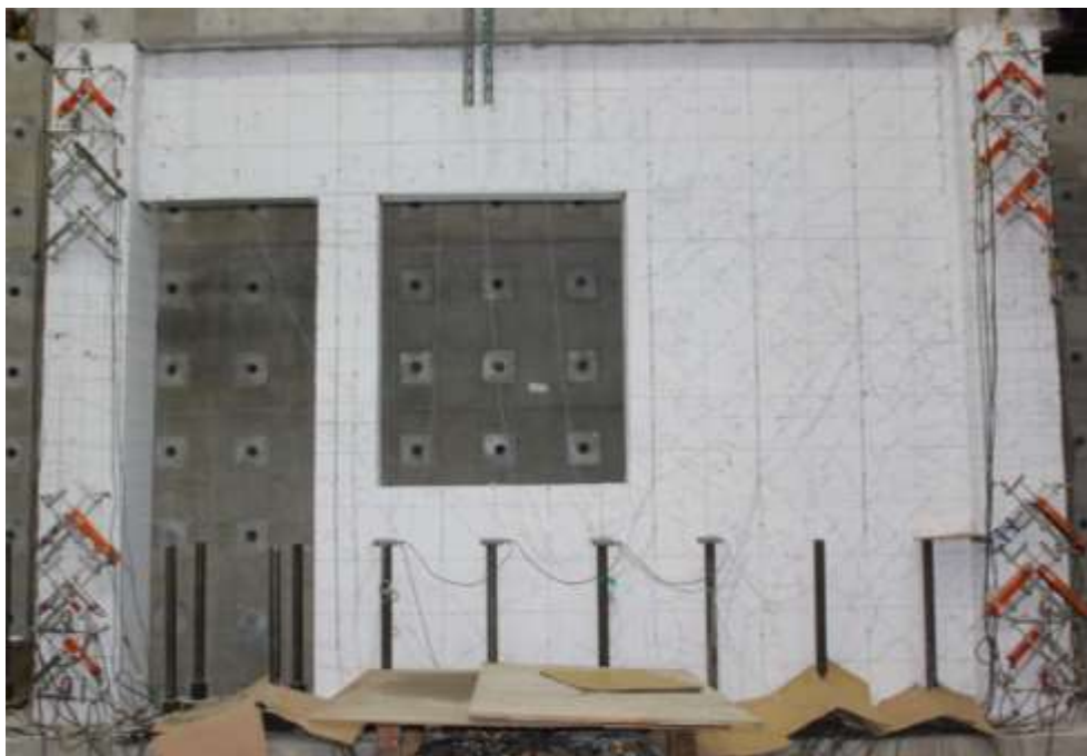
圖 4- 75 試體六在-0.375% drift 下裂縫情況
