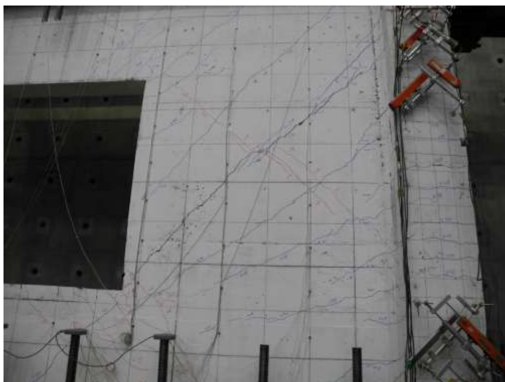
圖 4- 35 試體+0.375% drift 窗裂縫情況
