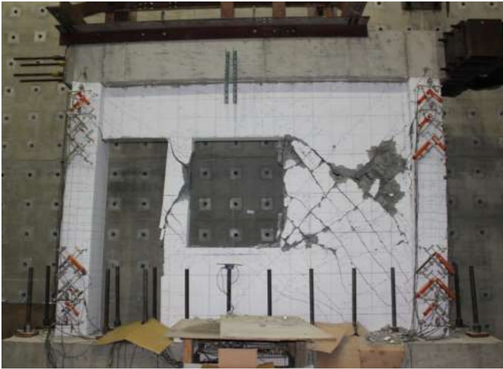
圖 4- 58 試體三在+2.0% drift 下裂縫情況
