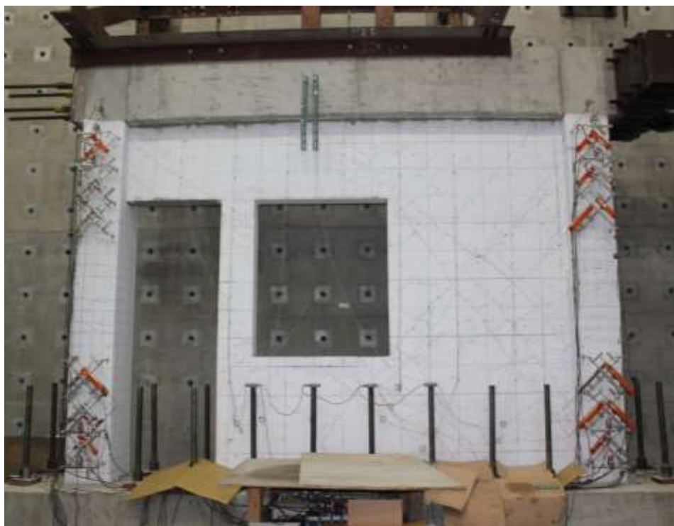
圖 4- 38 試體三在-0.375% drift 下裂縫情況
