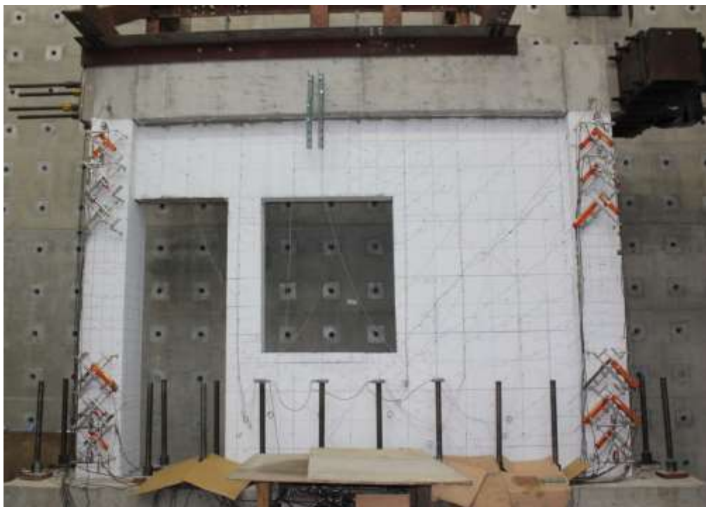
圖 4- 34 試體三在+0.375% drift 下裂縫情況
