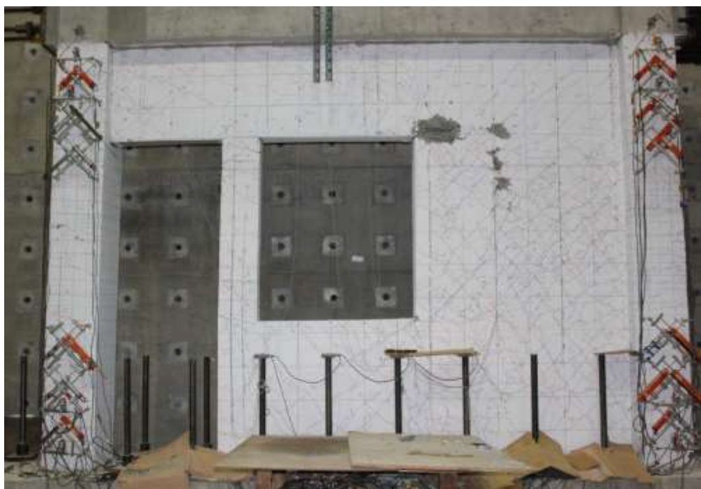
圖 4- 89 試體六在-1.0% drift 下裂縫情況
