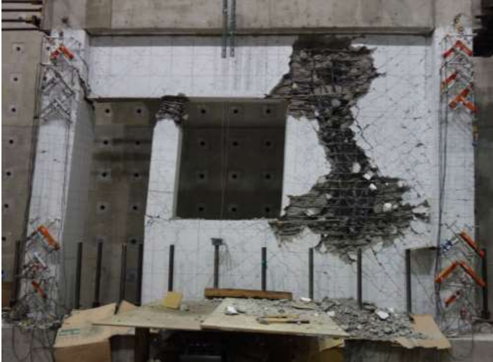
圖 4- 115 試體六在-4.0% drift 下裂縫情況
