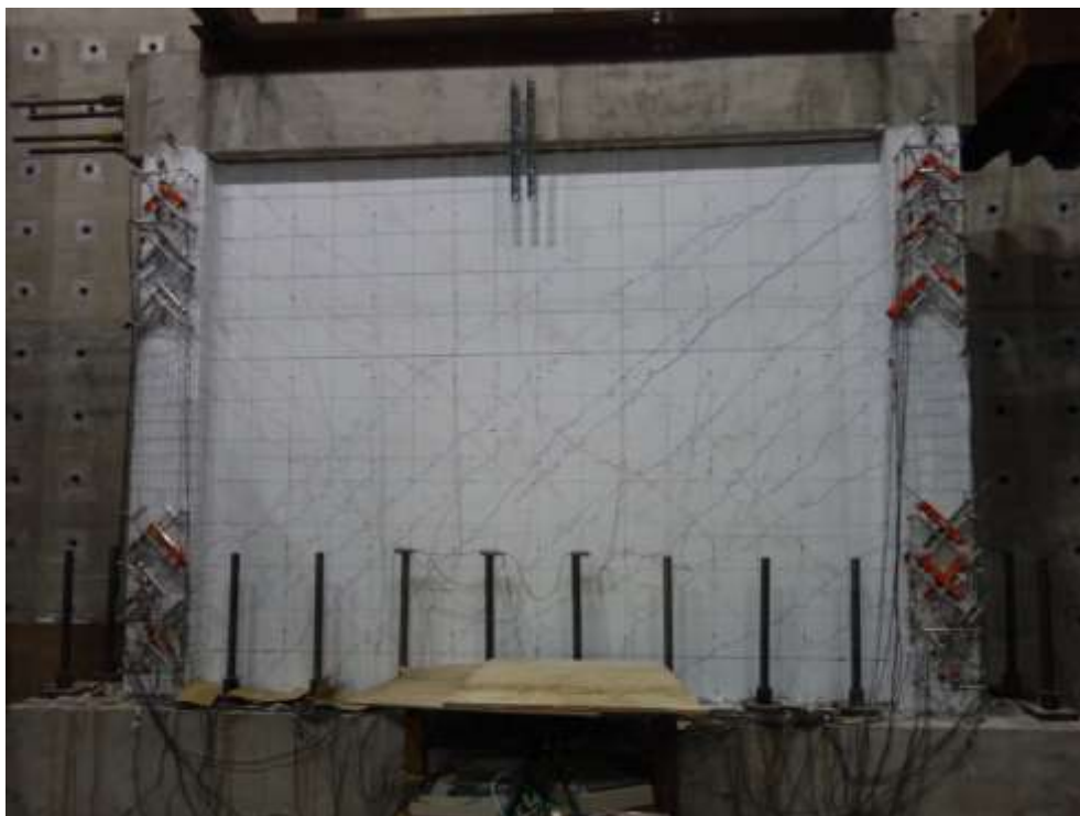
圖 4- 16 試體二在+0.75% drift 下裂縫情況
