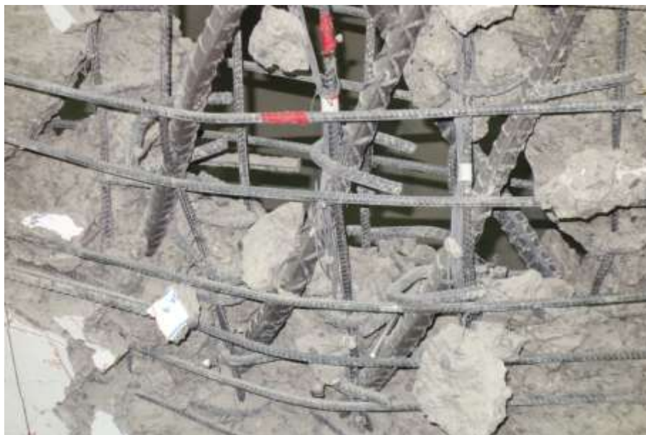
圖 4- 110 中間對角向鋼筋斷裂
