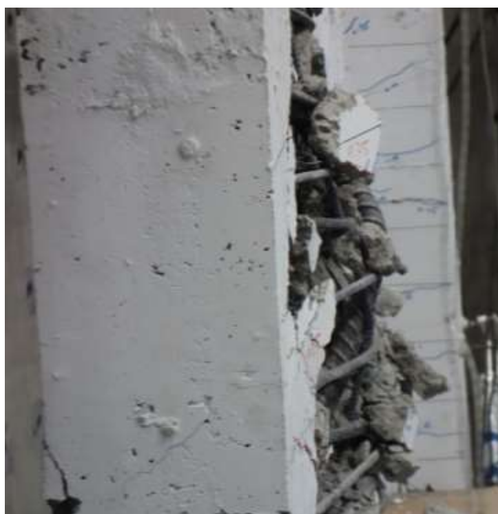
圖 4- 110 中間對角向鋼筋斷裂
