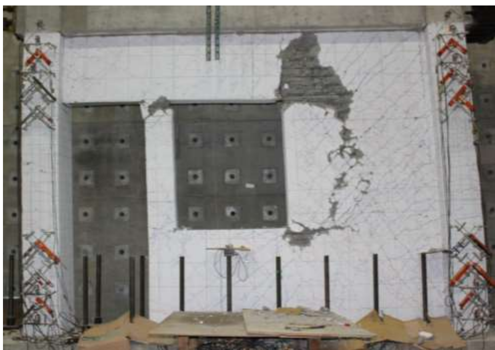
圖 4- 105 試體六在+3.0% drift 下裂縫情況
