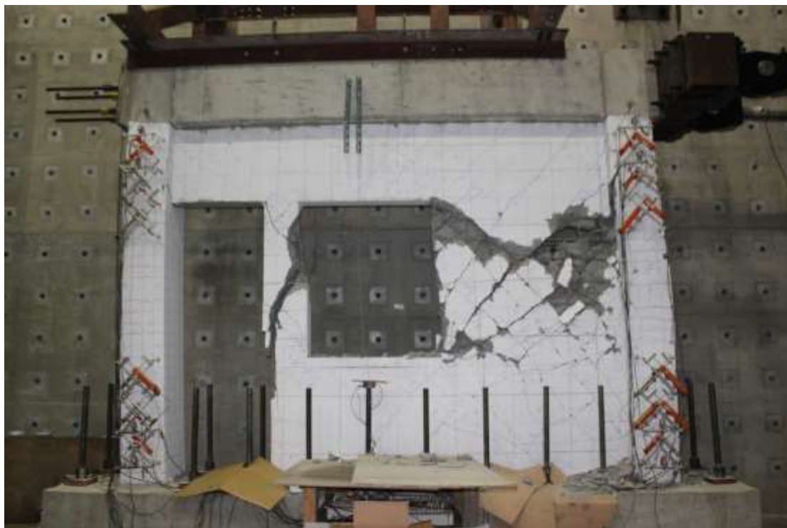
圖 4- 62 試體三在+3.0% drift 下裂縫情況
