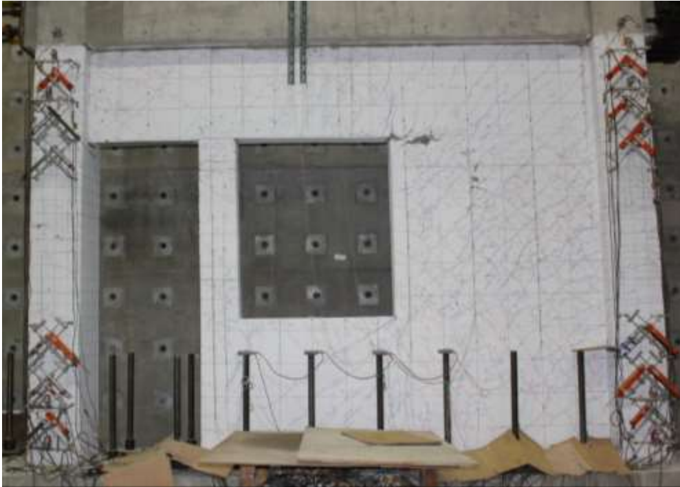
圖 4- 87 試體六在+1.0% drift 下裂縫情況
