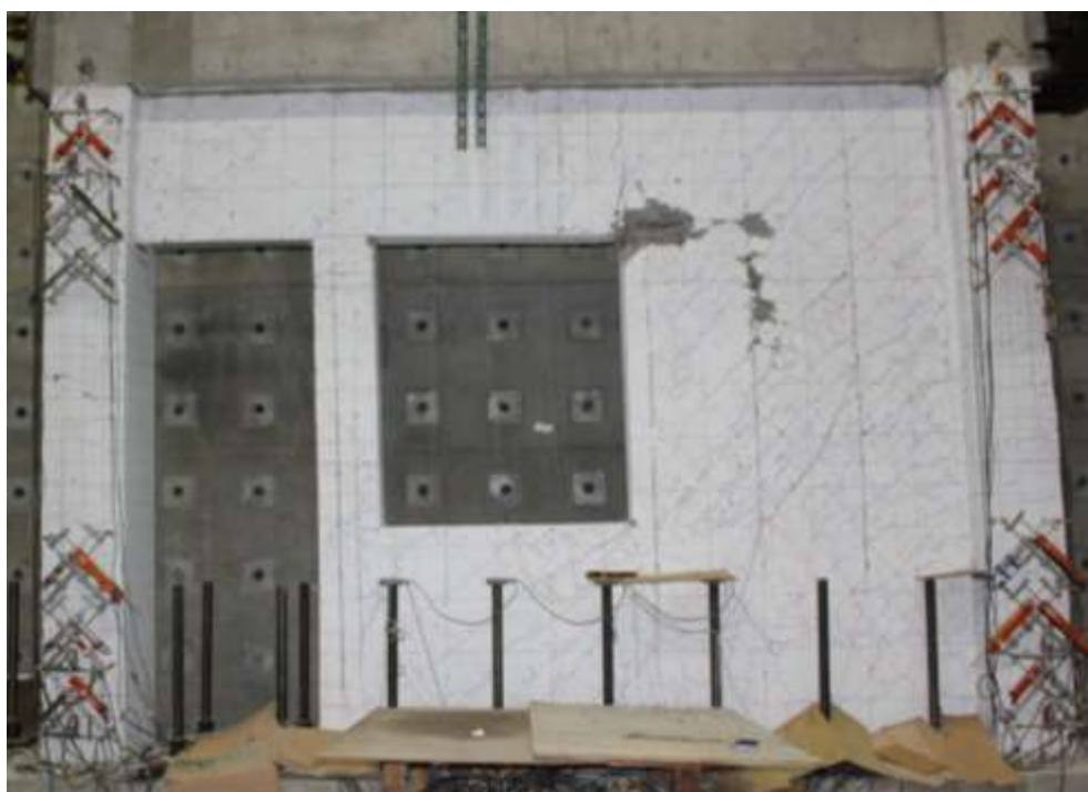
圖 4- 92 試體六在 +1.5% drift 下裂縫情況
