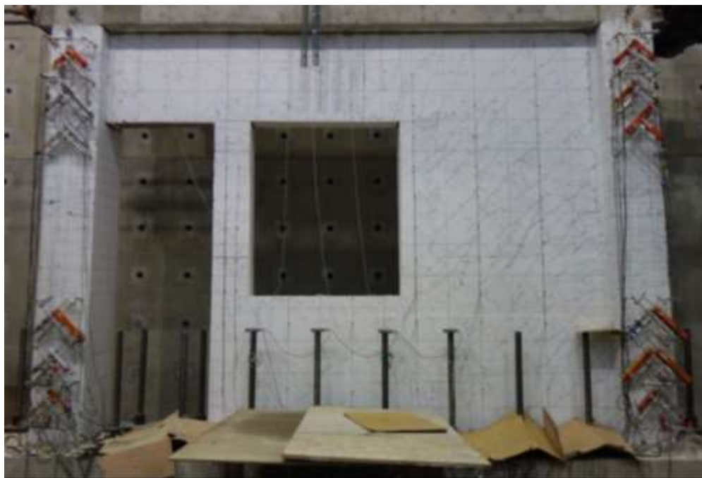
圖 4- 77 試體二在+0.5% drift 下裂縫情況
