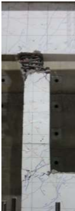
圖 4- 113 門及窗間之小柱，速鉸區破壞情形
