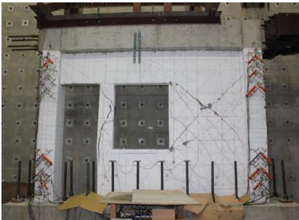
圖 4- 46 試體三在-0.75% drift 下裂縫情況
