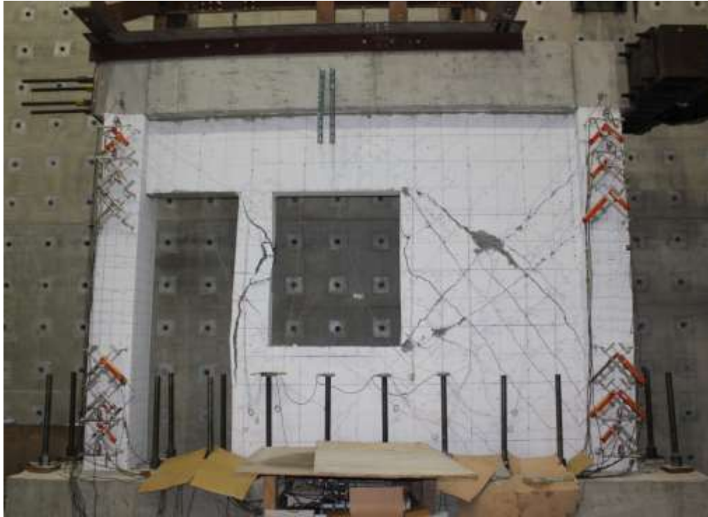
圖 4- 50 試體三在-1.0% drift 下裂縫情況
