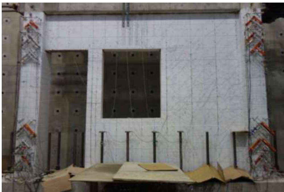
圖 4- 80 試體六在 -0.5% drift 下裂縫情況
