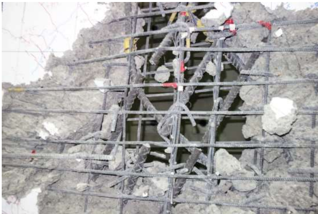
圖 4- 123 對角向鋼筋全斷
