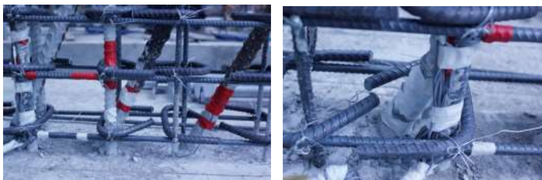
圖 3-28 對角向鋼筋底緣應變計及由底部順線
