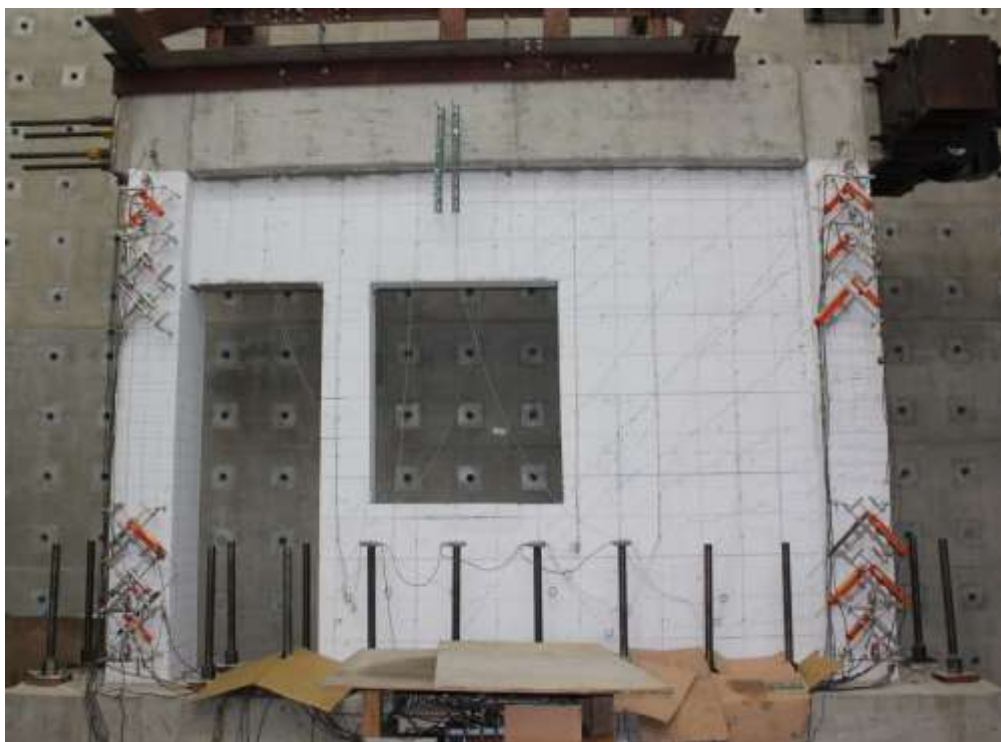
圖 4- 27 試體三在+0.25% drift 下裂縫情況
