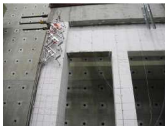
圖 4- 30 試體三在 -0.25% drift 下裂縫情況
