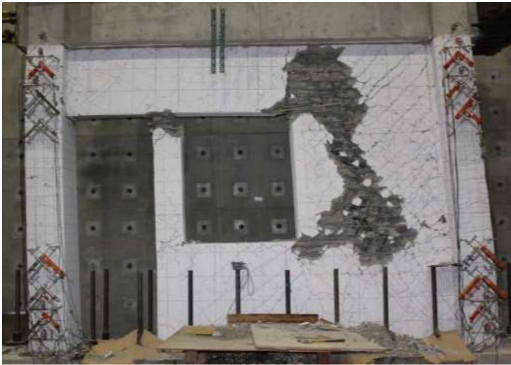
圖 4- 109 試體六在+4.0% drift 下裂縫情況
