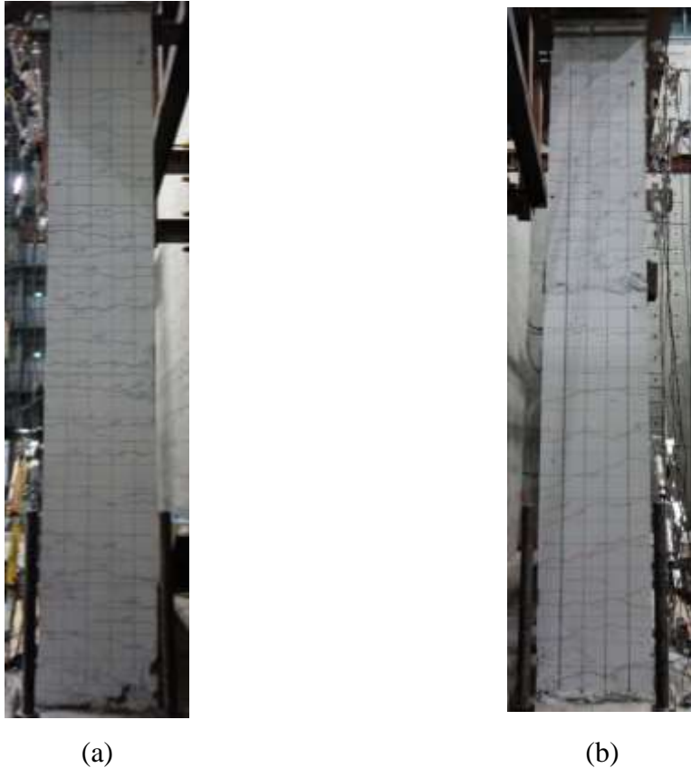
圖 4- 97 試體六在 -1.5% drift 下裂縫情況(a)右柱面(b)左柱面 (資料來源：本研究拍攝)
