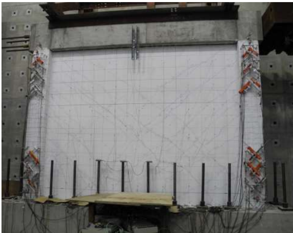
圖 4-13 試體二在-0.5% drift 下裂縫情況
