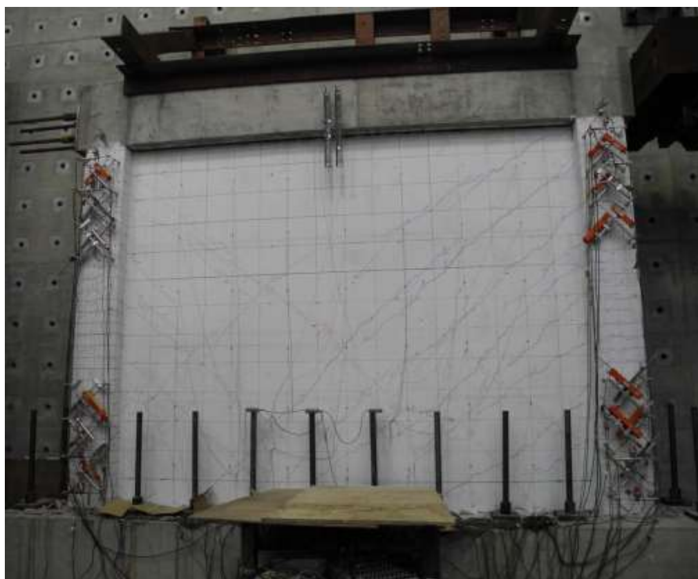
圖 4- 10 試體二在+0.5% drift 下裂縫情況
