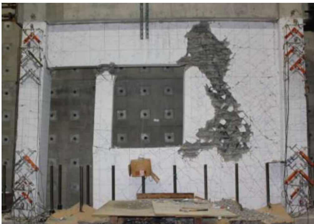
圖 4- 107 試體六在-3.0% drift 下裂縫情況
