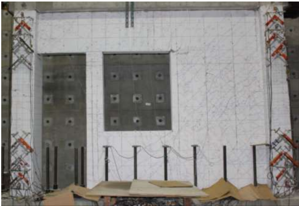
圖 4- 82 試體六在+0.75% drift 下裂縫情況
