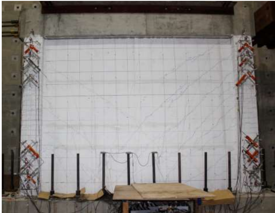
圖 4- 6 試體二在+0.375% drift 下裂縫情況
