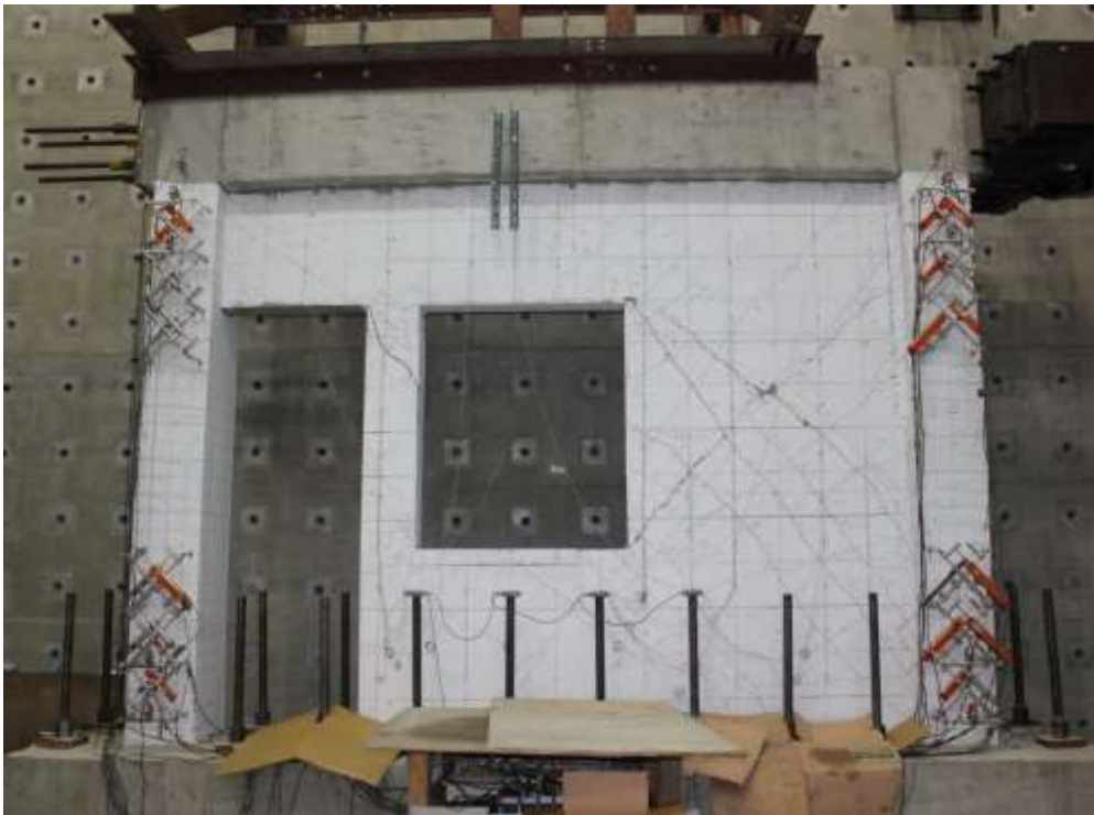
圖 4- 42 試體三在 -0.5% drift 下裂縫情況
