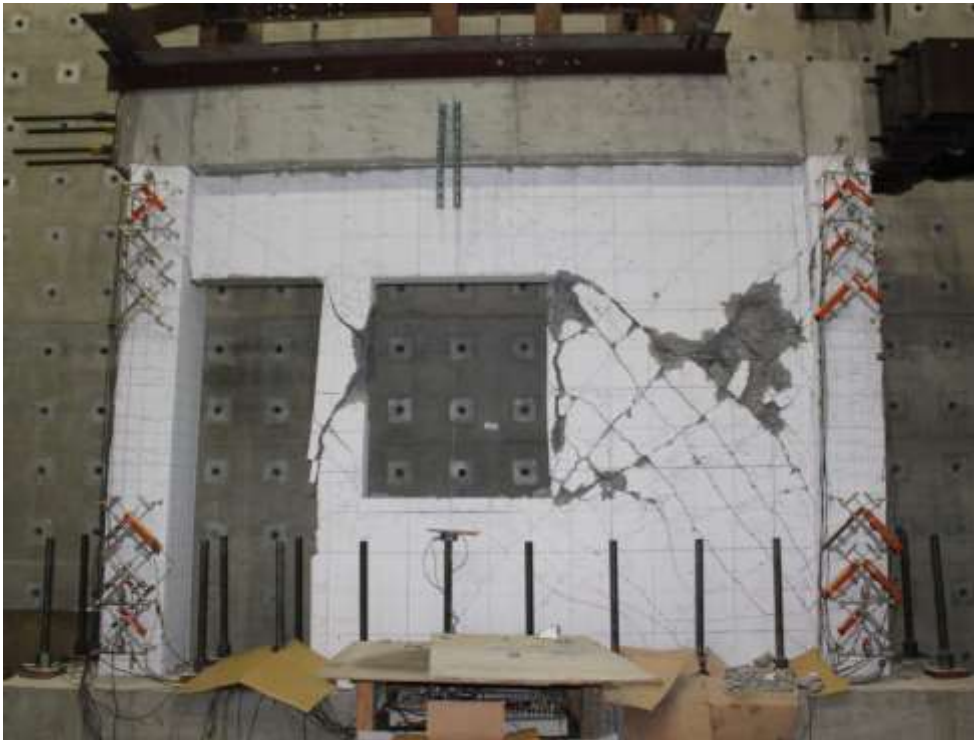
圖 4- 55 試體三在 -1.5% drift 下裂縫情況
