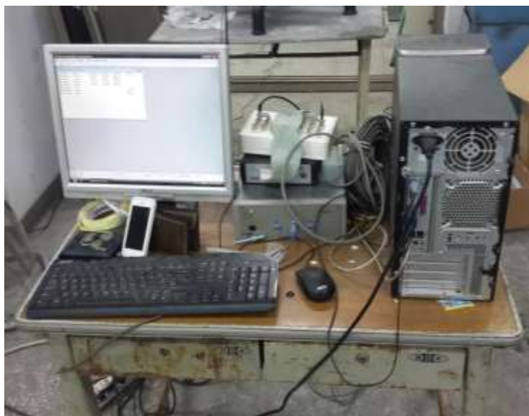
圖 3-20 力量(萬能試驗機讀數)與位移(NDI 讀數)同步接收數據 資料來源:本研究拍攝
