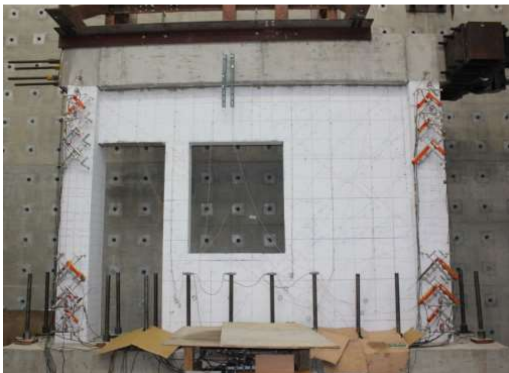
圖 4- 30 試體三在 -0.25% drift 下裂縫情況
