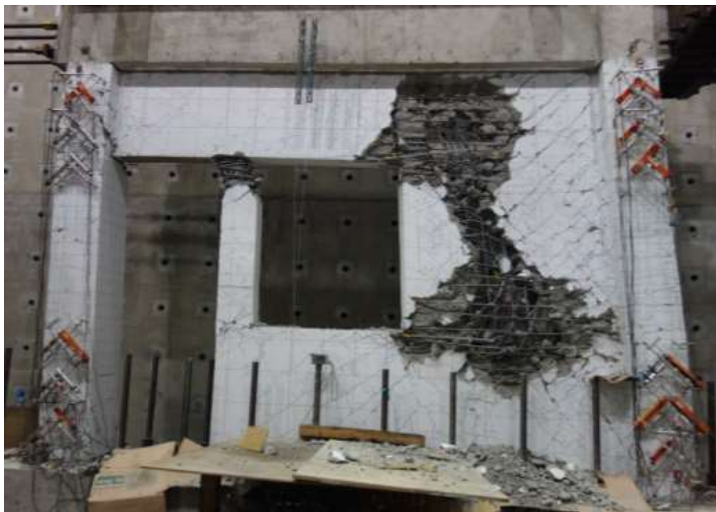
圖 4- 120 試體六在+5.0% drift 下裂縫情況
