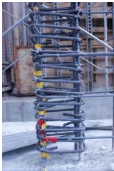
圖 3-26 邊界構材底部應變計黏貼並由底部順線接附接收器 資料來源:本研究拍攝
