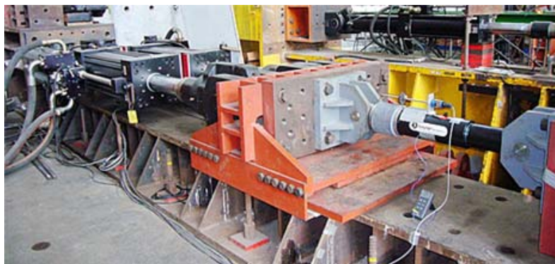
圖 6-2 NCREE 減震消能元件測試系統 (資料來源：國家地震工程研究中心)
