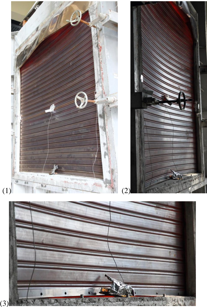
圖 5-4 捲門實驗中表面狀態變化情形 (1)捲門捲箱變形凸出，(2)捲門葉片內凹，(3) 捲門底座上拱) (資料來源：本研究自行拍攝)
