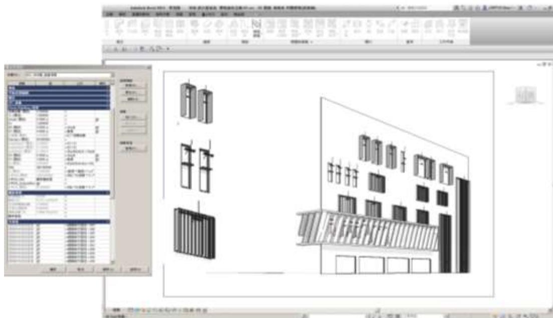
圖 7-14：本計畫在期中階段所建置的三種 AWSG 的基本典型遮陽元件(圖片來源：本計畫繪製)
