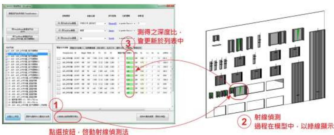
圖 7-6：API 射線法操作步驟(本研究製作)
