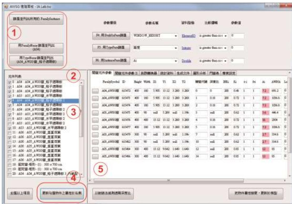
圖 7-4：介面操作步驟，①點選篩選條件②左側欄顯示符合篩選條件之物件③勾選欲檢索之物件④點選按鈕，把勾選物件顯示於右側⑤右側欄位列示被勾選物件之各項屬性(本研究製作)
