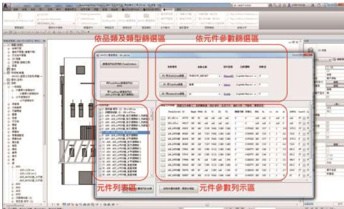
圖 7-3：Revit API 整合介，面一個整合篩選器與參數檢索的物件管理介面(本研究製作)
