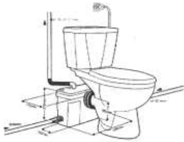
圖 4-8 機械式排水設備
