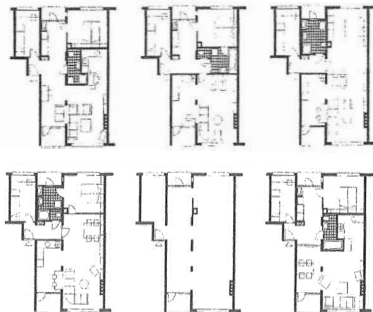
案例二 住戶覺得現有配置不符使用而決定進行更新 以三個人的工作小組來說，約十個工作天可以完成填充體系統之安裝。 住戶可以付額外的錢使用較高品質的家用設備。 (資料來源：Habracken，1994)
