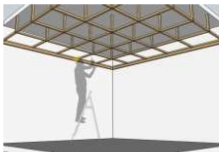
Step4 釘垂直吊筋並將固定角材釘於 RC 樓板
