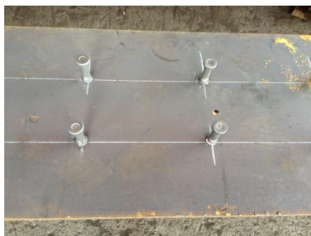
圖 3-7 箱型鋼柱之剪力釘鉸製
