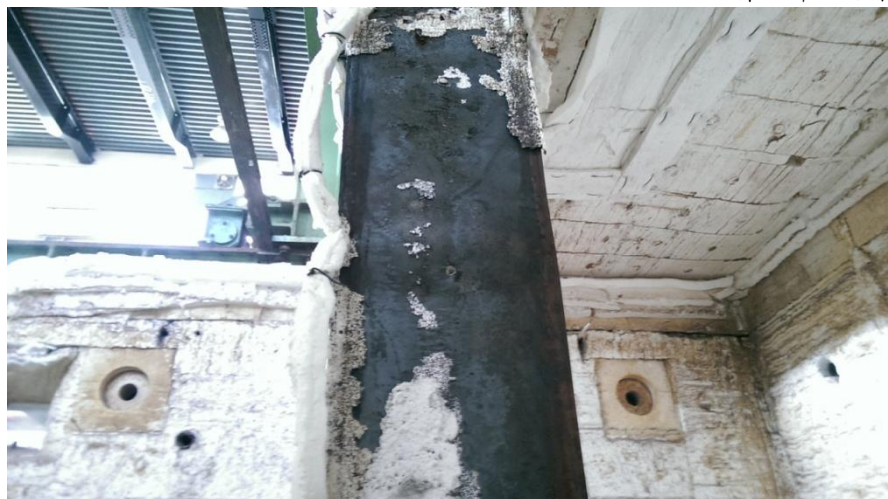
圖 4-6 試體 B3 之局部挫屈情形(無焊道開裂)
