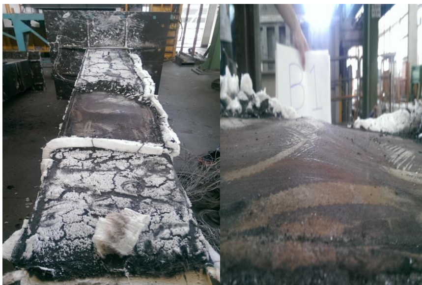
圖 4-4 試體 B1 之局部挫屈情形
