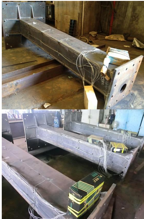
圖 3-11 箱型鋼柱試體柱面熱電偶測點
