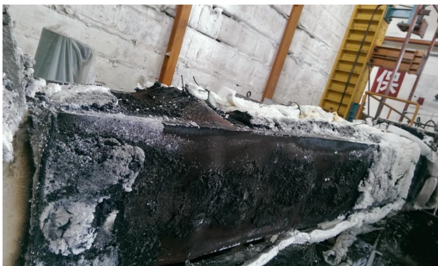
圖 4-5 試體 B2 之局部挫屈情形
