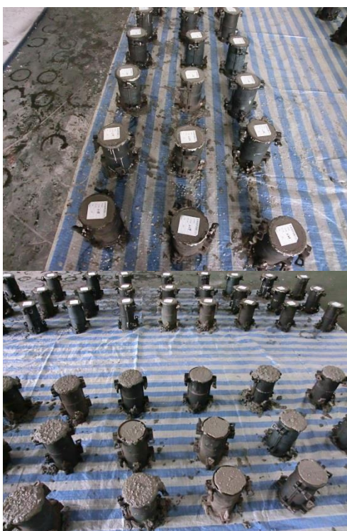
圖 3-15 混凝土圓柱試體之製作
