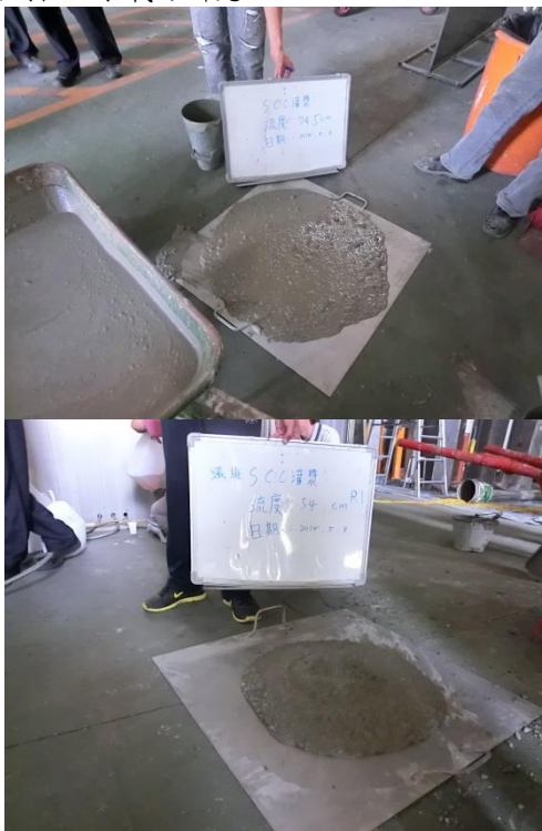
圖 3-14 混凝土之坍度與坍流度之量測
