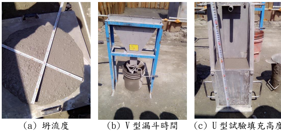
圖 3-12 混凝土新拌性質測試
