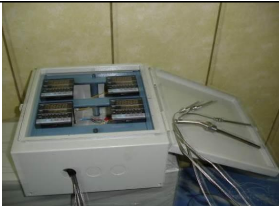
(c)電子溫控器與感溫棒(一式 4 組)
