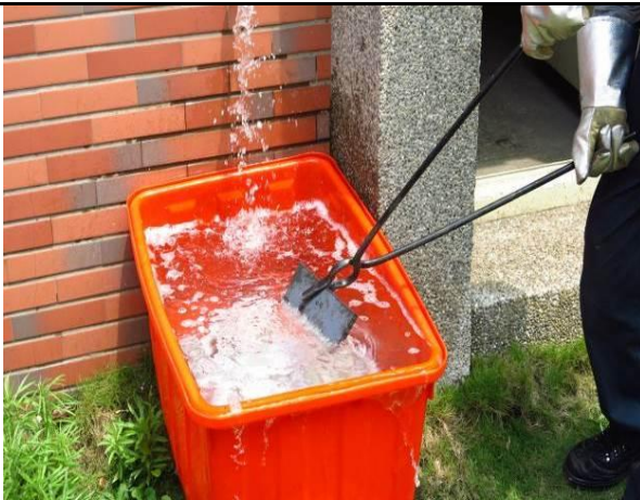
將試片置入淬火槽
