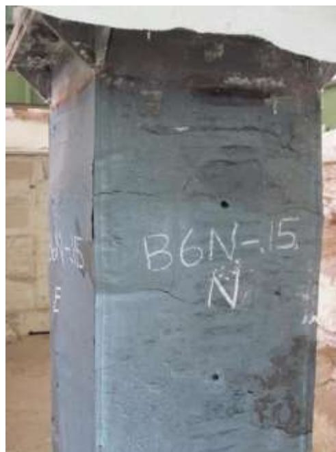
圖 4-6 試體 B6N-.15 柱板局部挫屈
