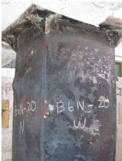
圖 4-11 試體 B6N-.20 柱板局部挫屈
