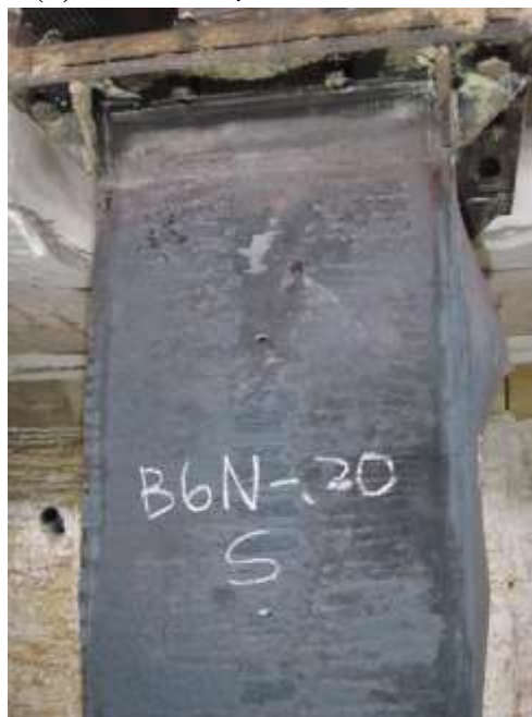
圖 4-11 試體 B6N-.20 柱板局部挫屈
