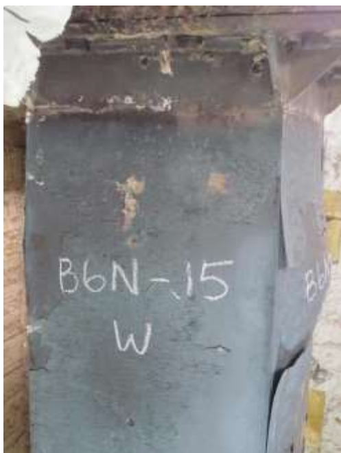
圖 4-6 試體 B6N-.15 柱板局部挫屈
