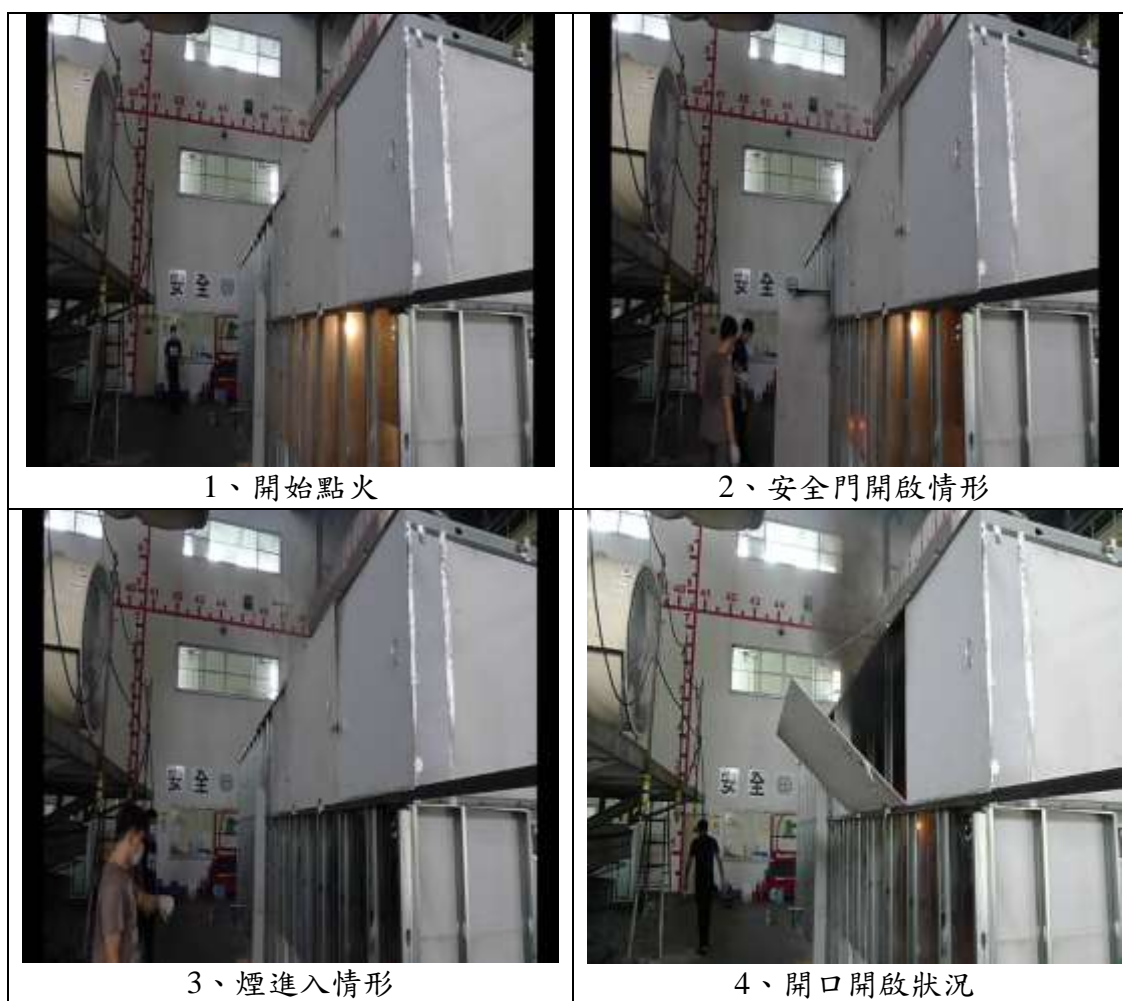
CASE1-45-A0 排煙室照片摘錄 (長向排煙口置中開口 45 度 外部風速 0 m/s)
