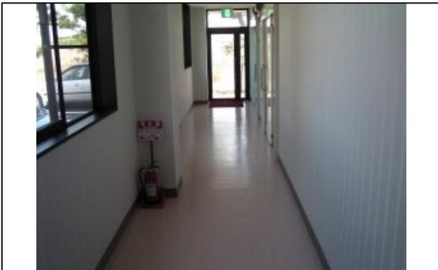
**圖 3-11 廊道保持至少 120cm 寬並考量結構與消防設施的設置**
