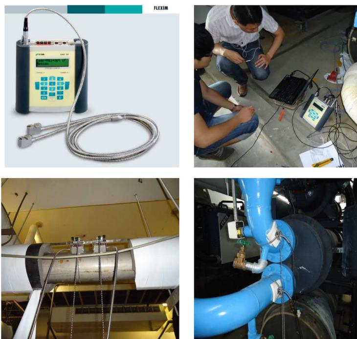
圖 2-4 量測儀器本體與現場儀器架設實況圖
