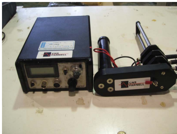
圖 3.4 四極式電阻量測儀
