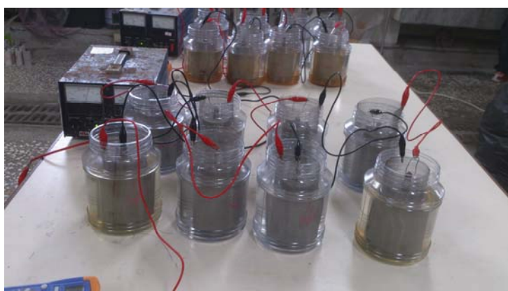
圖 3.7 加速腐蝕裝置圖
