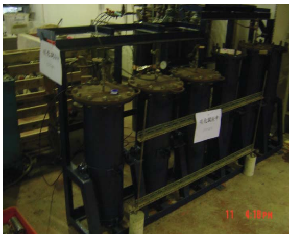
圖 3.1 加速中性化試驗儀
