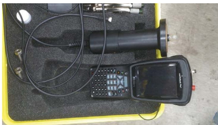
圖 3.5 CORROMAP 鋼筋腐蝕電位量測儀
