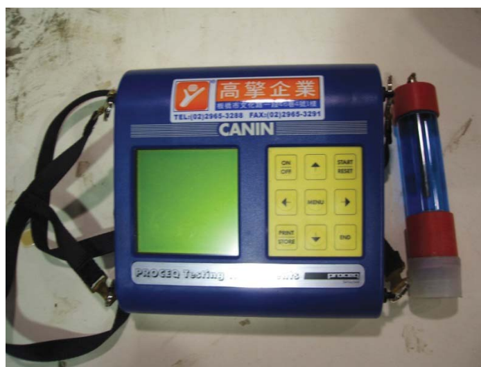
圖 3.2 半電池電位量測儀( \text{Cu}/\text{CuSO}_4 )
