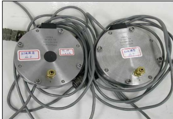
圖 4-6. 薄膜式壓力轉換器
