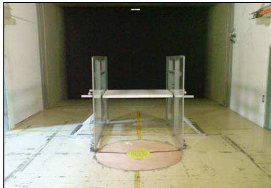
圖 4-2. 斷面模型試驗設置圖
