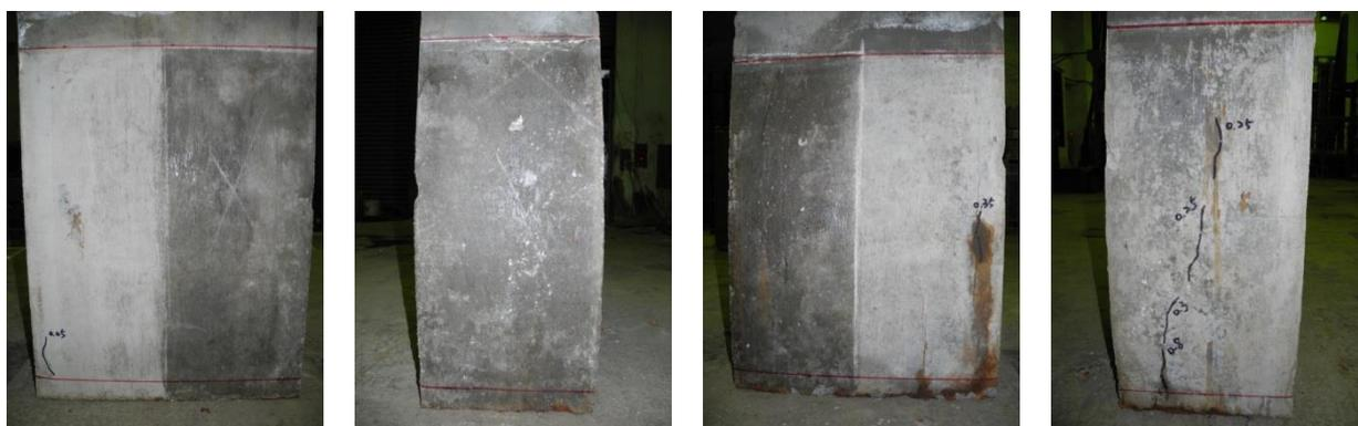
圖 2 - 16 單側試體主筋腐蝕裂縫發展
