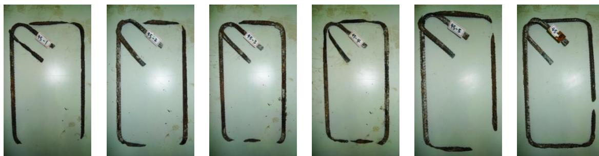
圖 2 - 13 箍筋腐蝕情形(腐蝕率 35 %)
