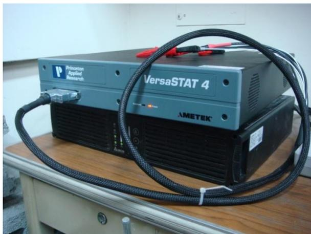
圖 3-4 VersaSTAT 恆電位恆電流儀
