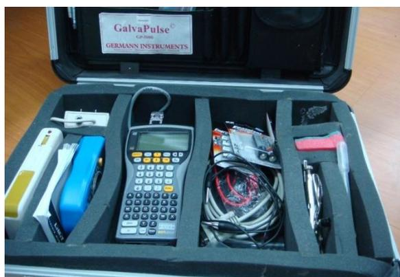
**圖 3-3 GalvaPulse 腐蝕量測儀**
