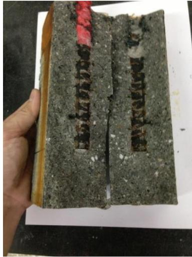
圖 3 - 10 試體中的腐蝕鋼筋
