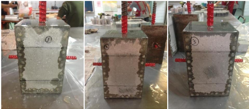
圖 3 - 11 含交疊鋼筋試體
