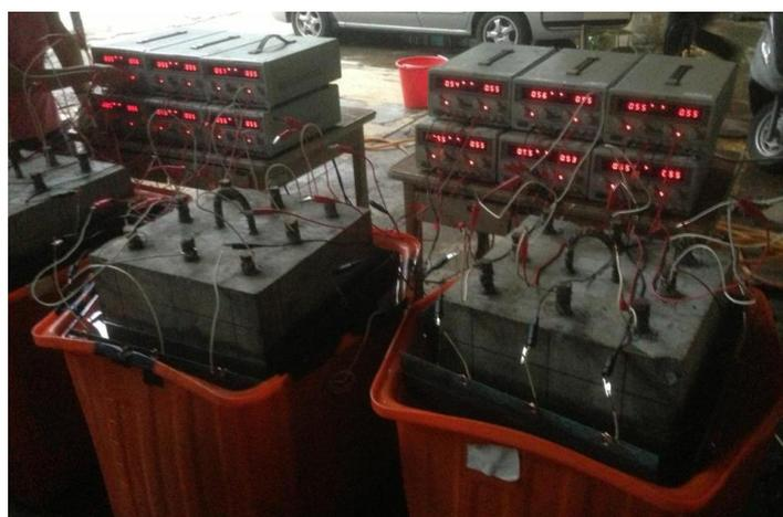
圖 4-5 加速腐蝕試體實際通電設置
