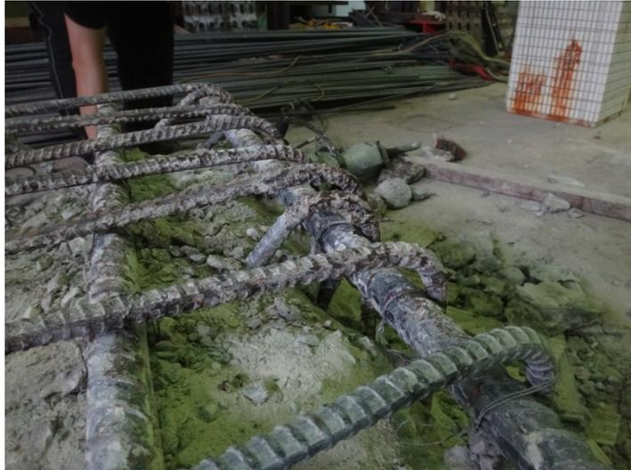
圖 4 - 35 貼磚足尺寸試體敲除混凝土後的腐蝕形態
