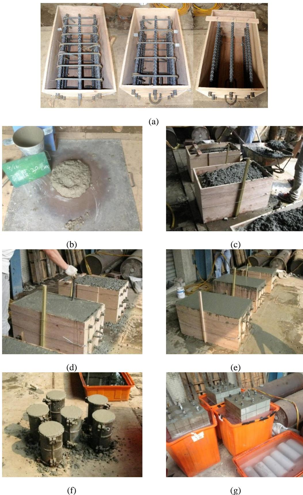
圖 4-3 試體製作過程：(a)綁紮情況與模板設置；(b)混凝土流度試驗；
