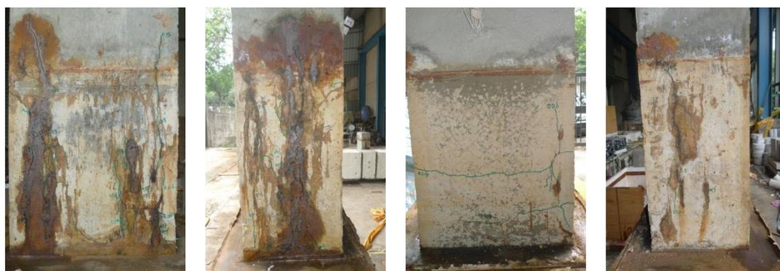
圖 2 - 14 試體箍筋腐蝕裂縫發展
