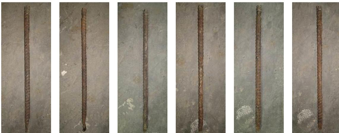
圖 2 - 15 試體主筋腐蝕狀況
