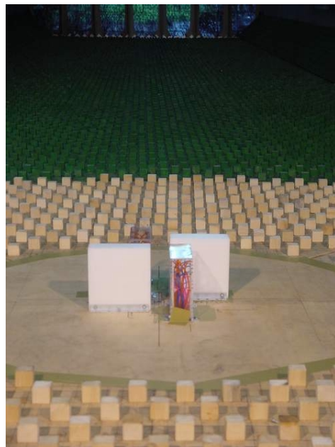
圖 4-2. 模型表面壓力量測系統配置
