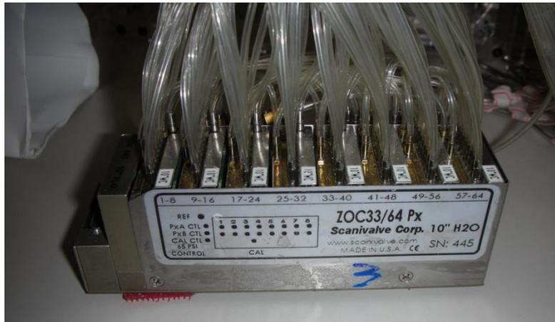
圖 3-2 電子式壓力掃描模組
