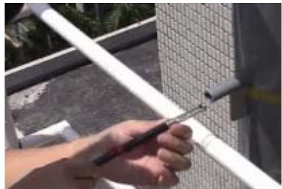
插入熱線風速計於通氣管
