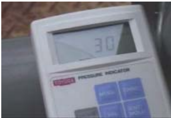
空壓機加壓停止後，管內壓力逐漸下降
