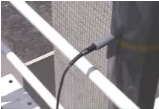
插入入熱線風速計於通氣管後
