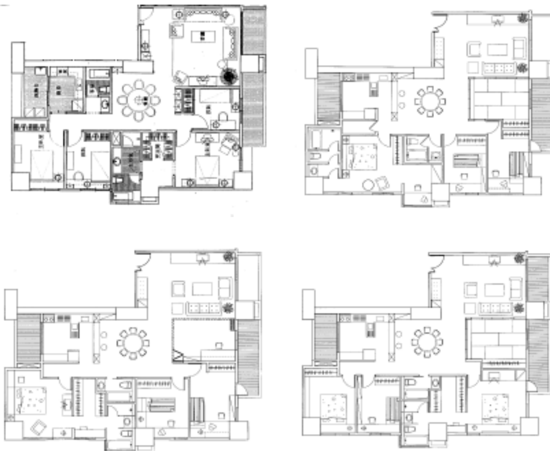
圖 4.9 採用局部雙層樓板可增加室內格局之彈性：四種可能的平面格局
