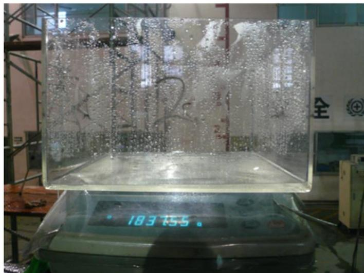
圖 3-17 集水盤與磅秤量測圖
