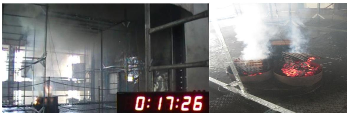
圖 4-22 情境十三撒水頭作動十分鐘與火源最後情形
