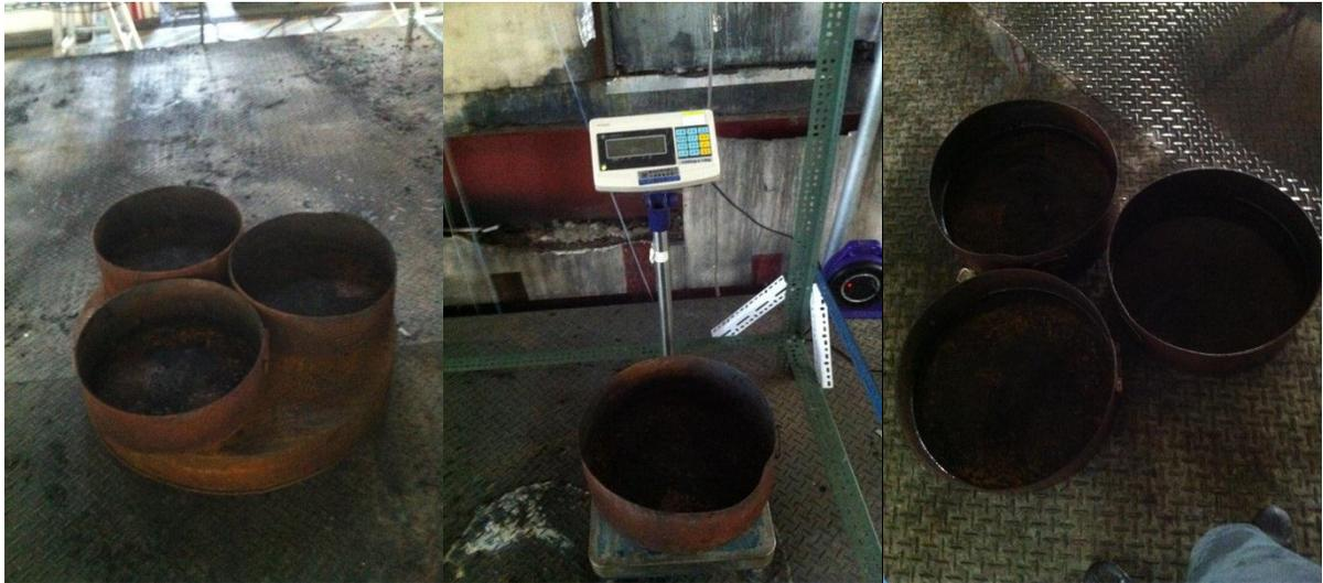
圖 4-33 油盤水量蒐集測試
