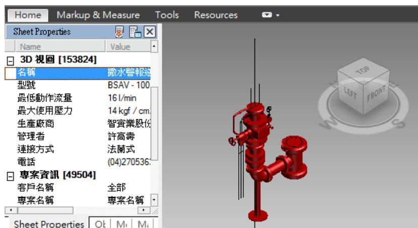
圖 35 灑水警報逆止閥模型
