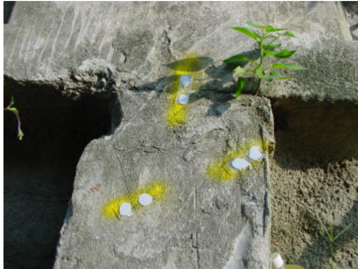
圖 3.10 簡易安全檢視系統-玻璃片
