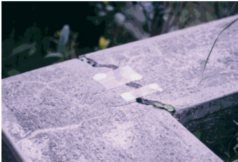
圖 3.6 裂縫計(玻璃片)
