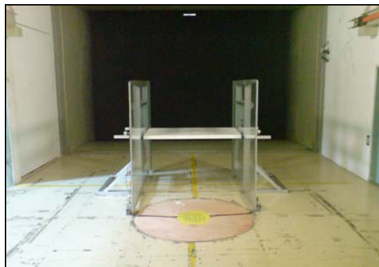
圖 4-2. 斷面模型試驗設置圖
