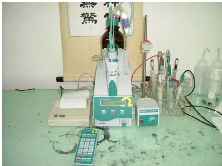
圖 3-7 氯離子滴定儀 (資料來源：本研究繪製)
