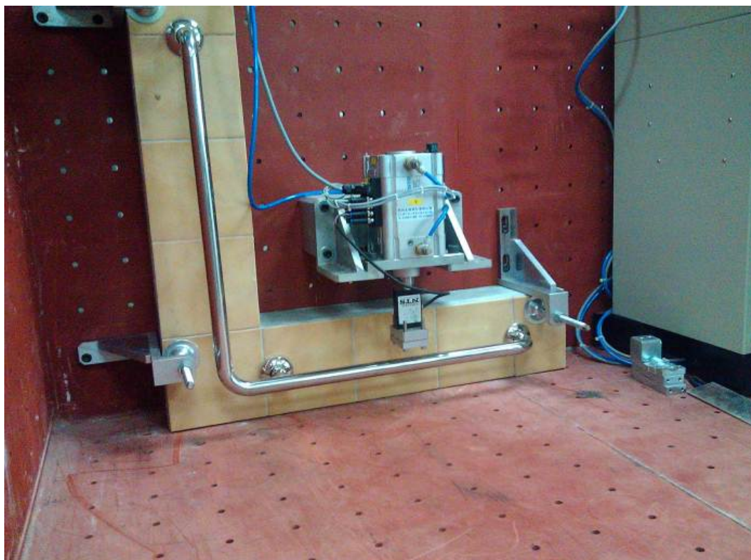
圖 4-1 L 型輔助扶手試件之非常態負載實驗
