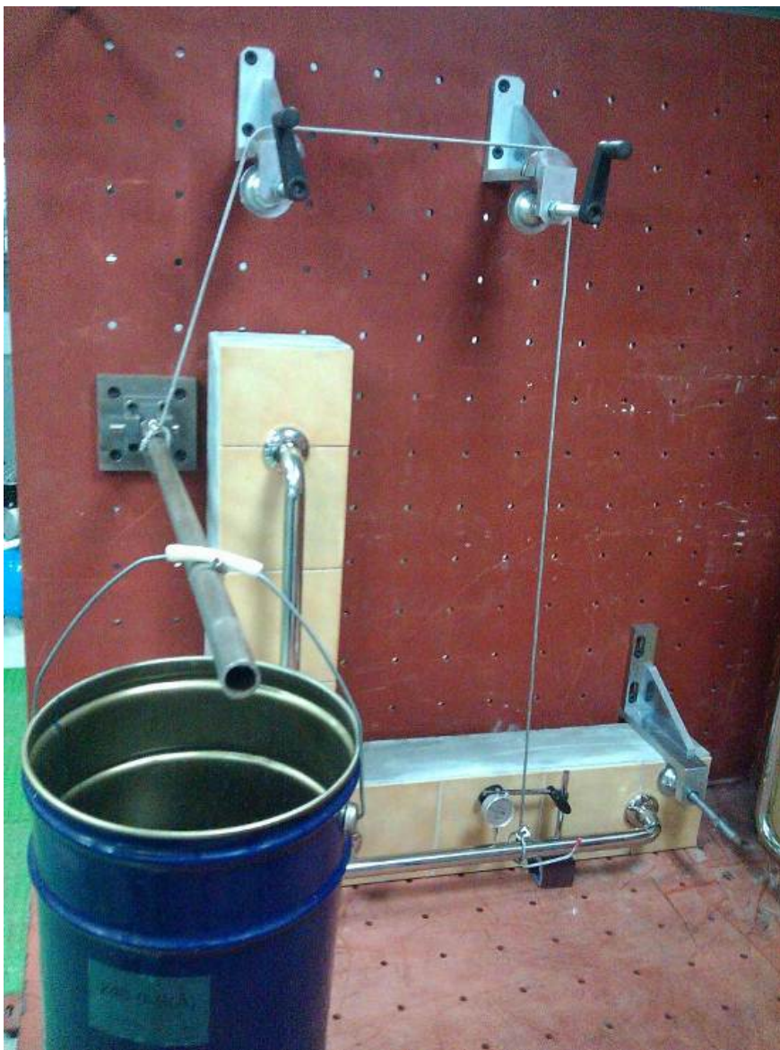
圖 4-6 L 型輔助扶手試件承受常態垂直載重之實驗
