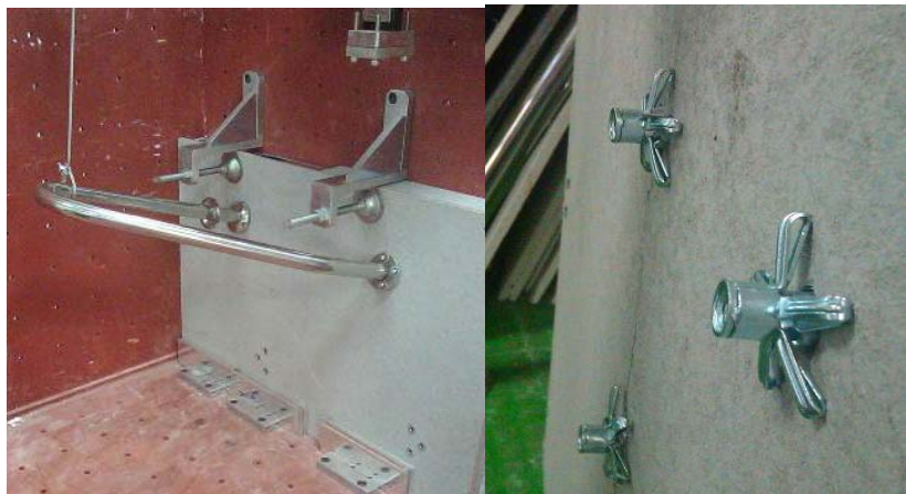
圖 3-6 水泥纖維板承受常態水平載重試驗所產生之破壞
