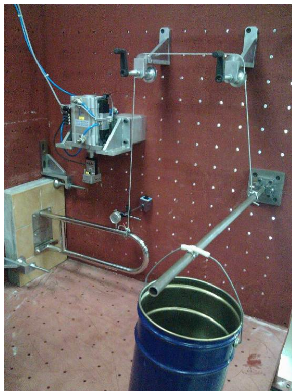
圖 4-10 活動型輔助扶手試件承受垂直力常態負載之實驗
