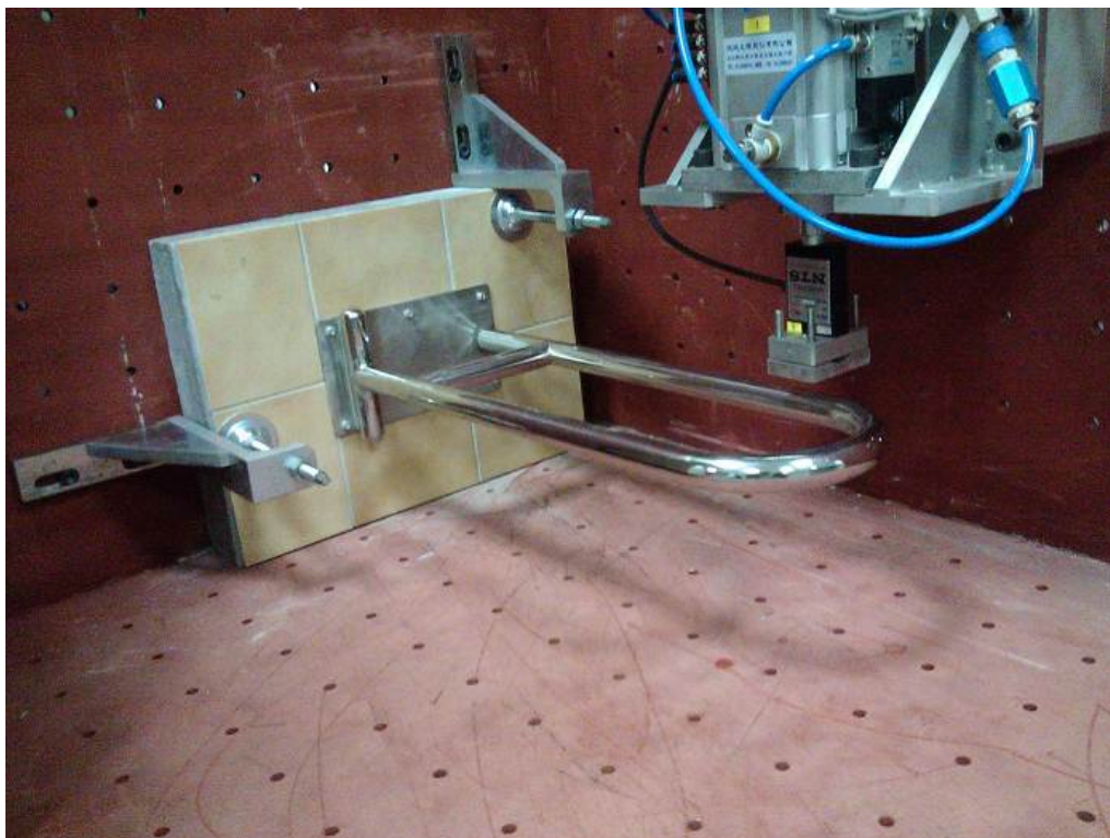
圖 4-3 活動型輔助扶手承受水平負載之實驗
