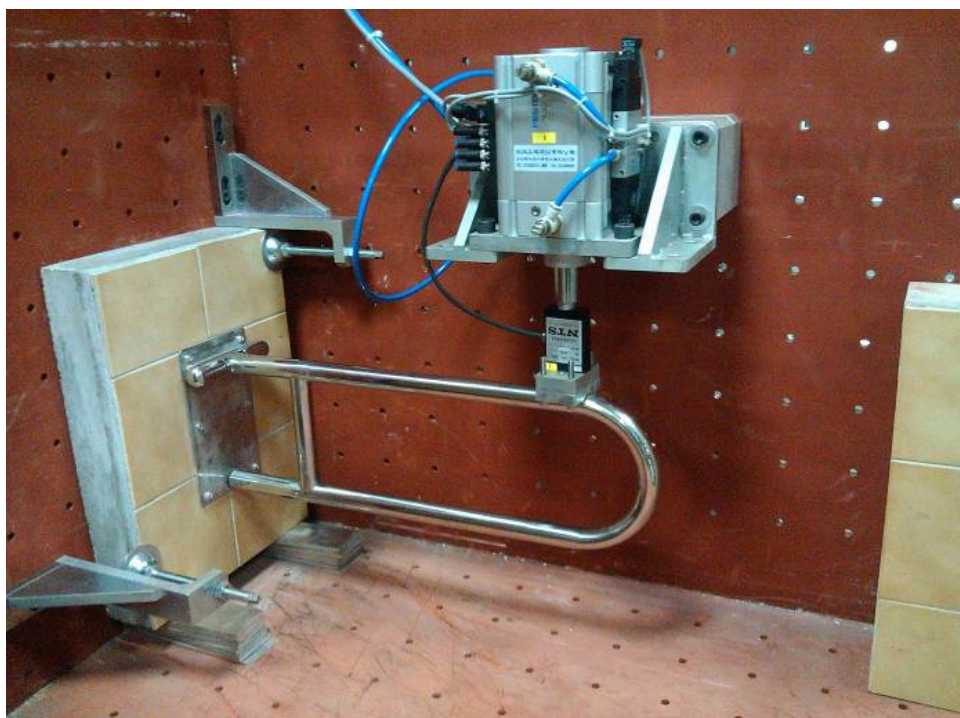
圖 4-14 活動型輔助扶手承受垂直反覆式負載的實驗
