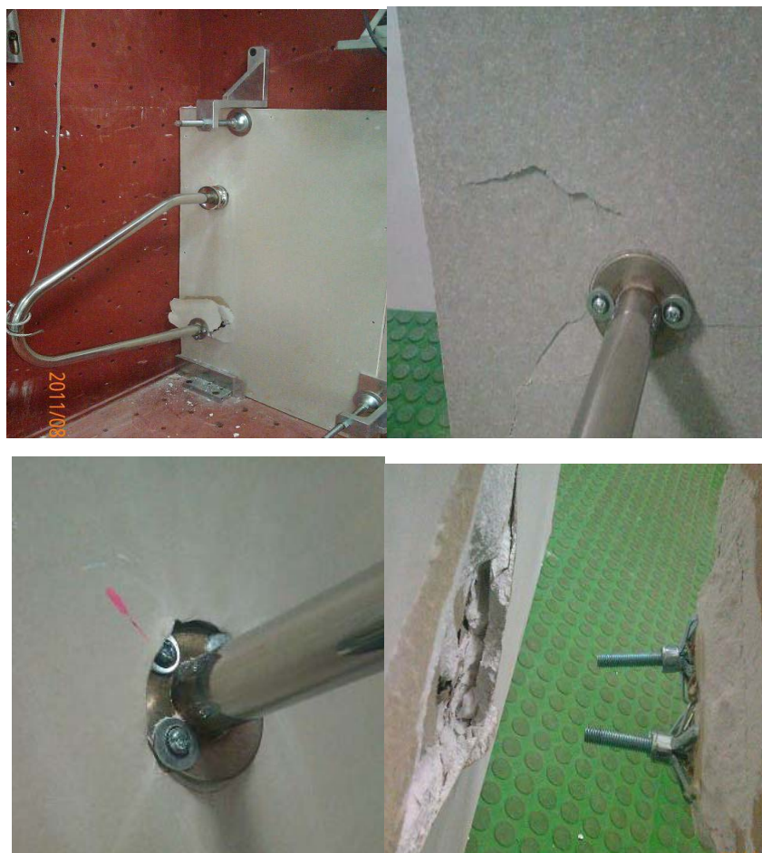
圖 3-7 石膏板承受常態載重試驗之破壞
