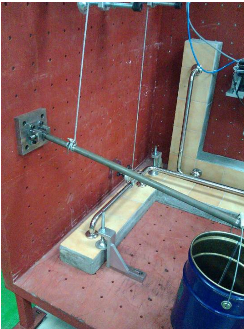
圖 4-7 L 型輔助扶手試件承受常態水平載重之實驗
