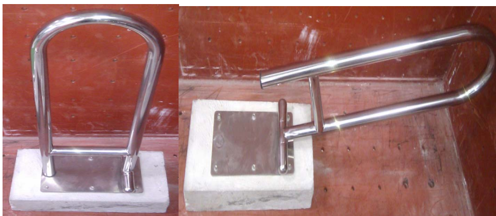
圖 3-9 馬桶上掀活動型輔助扶手實驗試件(基材無貼面材)
