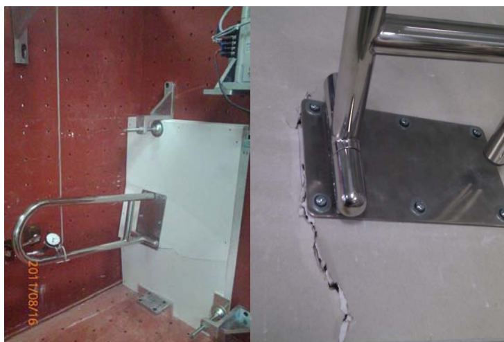
圖 3-4 矽酸鈣板常態載重試驗產生明顯之破壞
