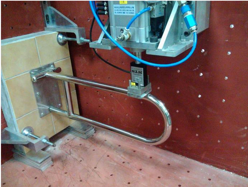
圖 4-2 活動型輔助扶手承受垂直負載之實驗
