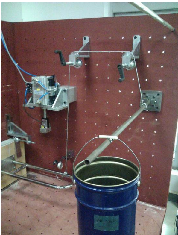
圖 4-11 活動型輔助扶手試件承受水平力常態負載之實驗
