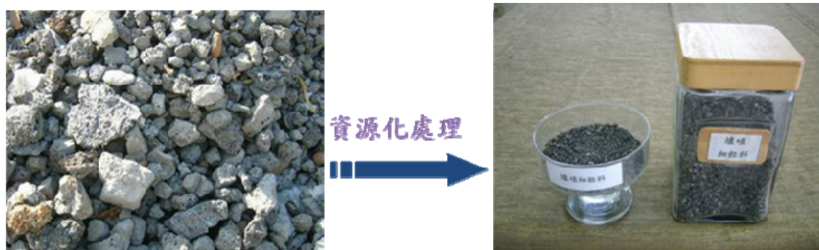
圖 4-19 電弧爐渣製備細粒料
