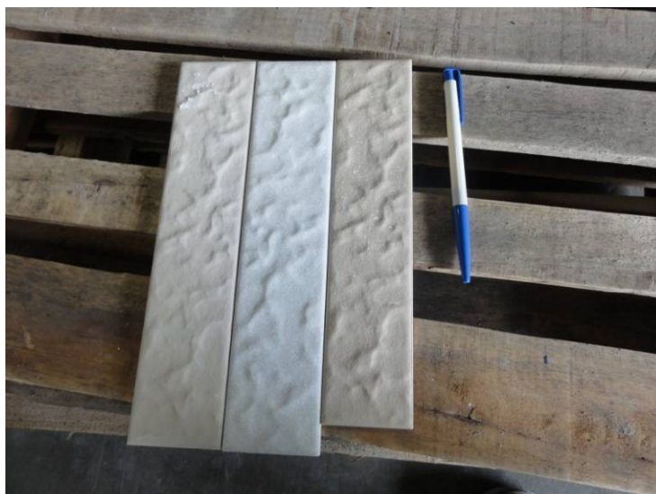
圖 4-11 陶瓷面磚製程各階段之收縮變化
