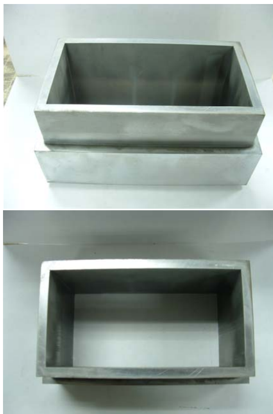
模具設計圖 模具實際照片 圖 3-19 冷結型高壓地磚模具設計圖與實際照片 (外模)
