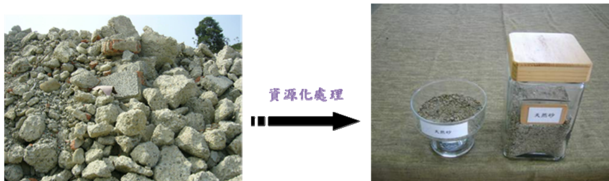
圖 4-21 營建剩餘土石方製備細粒料
