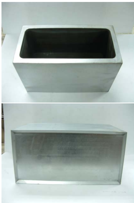
模具設計圖 模具實際照片 圖 3-20 冷結型高壓地磚模具設計圖與實際照片 (加壓模)
