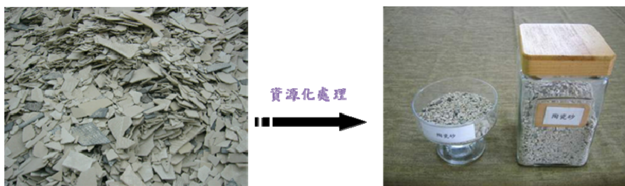
圖 4-20 廢陶瓷製備細粒料
