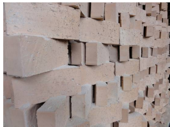
燒結完成後之普通磚成品
