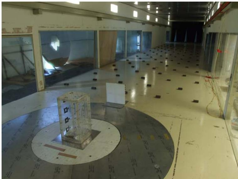
圖 4-3 建築物模型置於第一轉盤之照片圖
