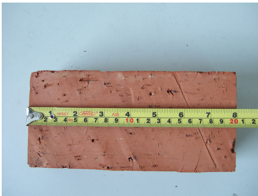
圖 3-7 本研究所使用之紅磚尺寸示意圖
