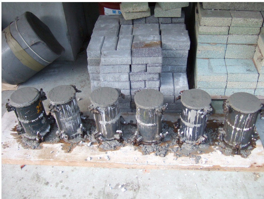
圖 3-20 混凝土標準圓柱試體製作
