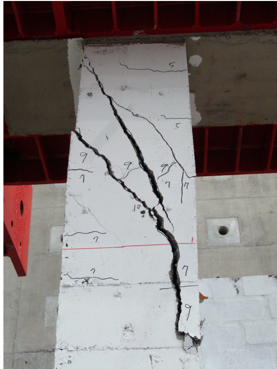
圖 5-19 試體 S3 於位移達 38.125mm 時剪力裂縫變寬且強度勁度驟降 (資料來源：本研究製作)
