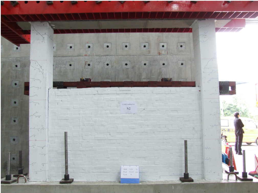
圖 5-11 試體 S2 於位移大於 30.5mm 時柱身有明顯的斜向裂縫開始產生 (資料來源：本研究製作)
