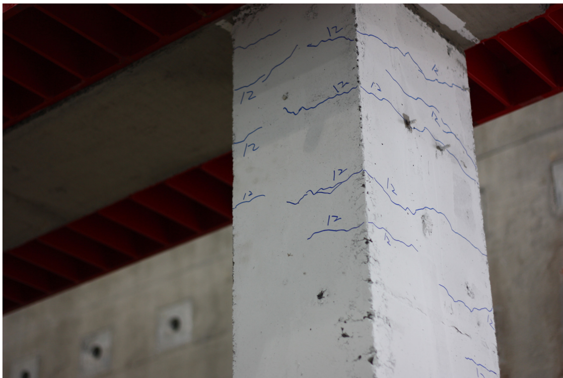
圖 5-6 試體 S1 於位移達 45.75mm 時柱頂塑鉸區裂縫開始發展 (資料來源：本研究製作)
