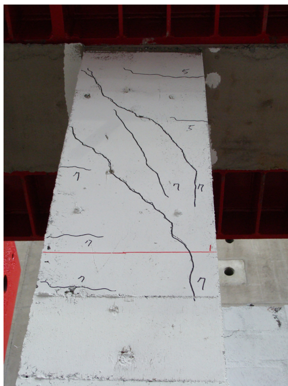
圖 5-18 試體 S3 於位移達 30.5mm 時於短柱處突然增現剪力裂縫 (資料來源：本研究製作)
