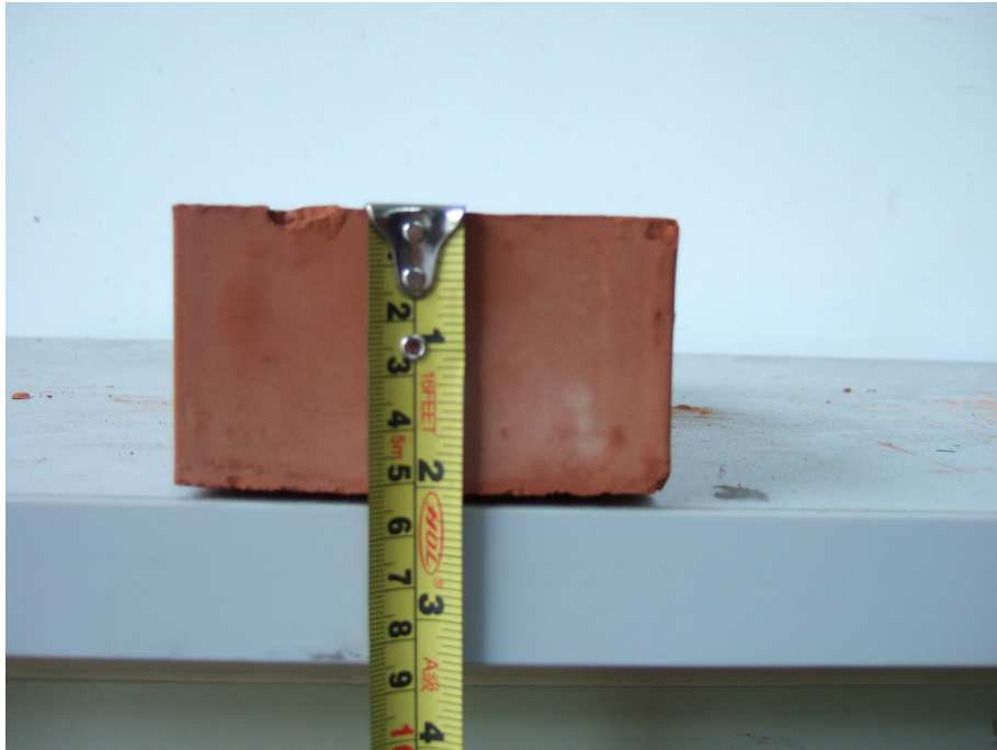
圖 3-9 本研究所使用之紅磚尺寸示意圖
