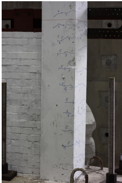
圖 5-2 試體 S1 於小位移時僅有撓曲裂縫產生 (資料來源：本研究製作)
