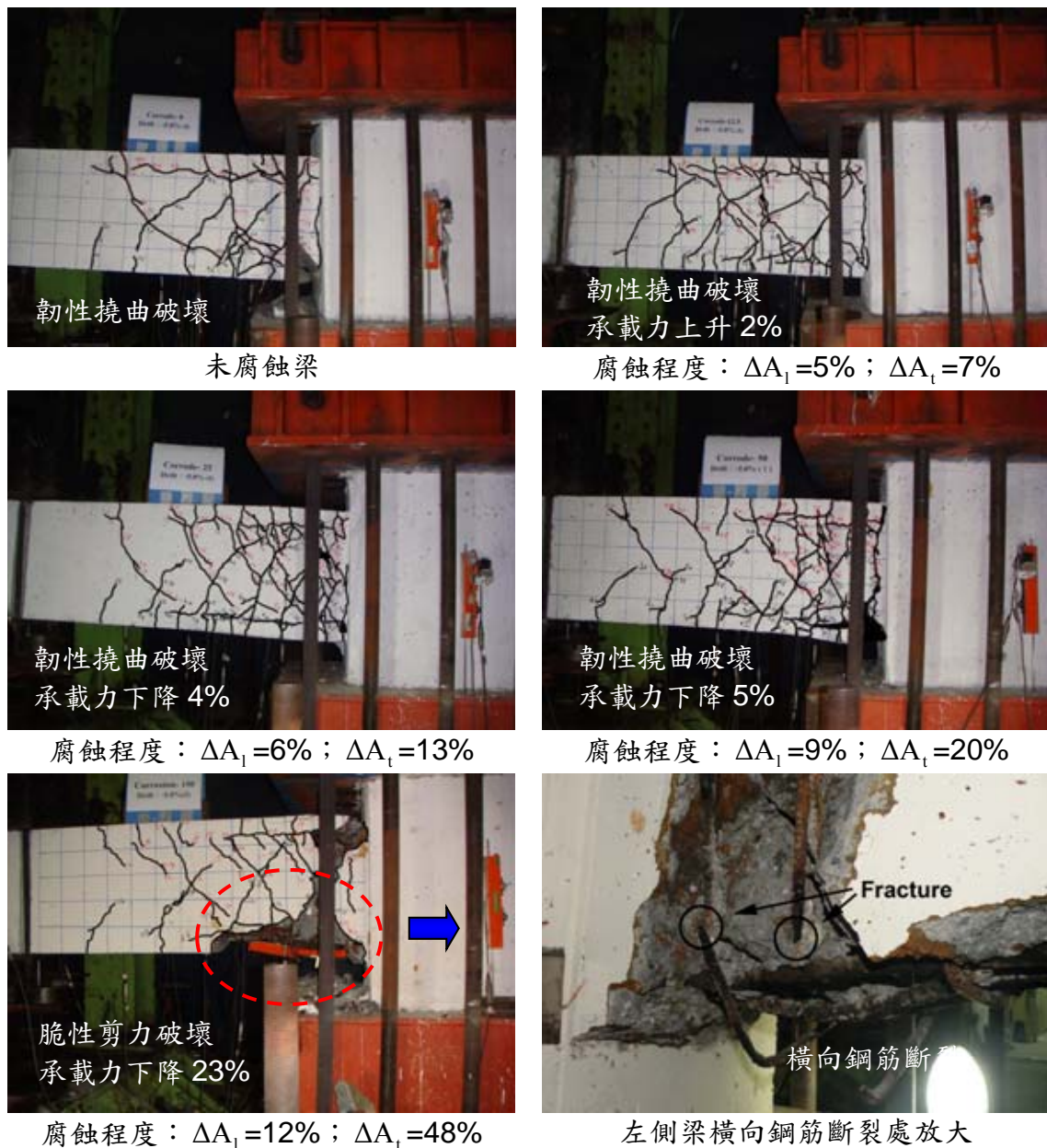
圖 2-5 試體在 4% 位移比裂縫發展與混凝土破壞狀態(何明錦 等 2009)。註： \Delta A_l = 縱向主筋最大斷面減少率； \Delta A_t = 橫向鋼筋最大斷面減少率
