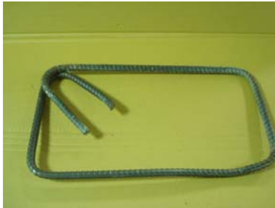
圖 5-22 將鋼筋取出除鏽
