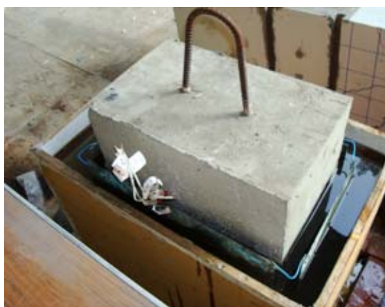
圖 5-17 梁結構構件浸泡於 5 % 的氯化鈉水溶液中
