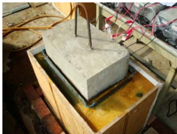
圖 5-20 梁結構構件出現鏽水
