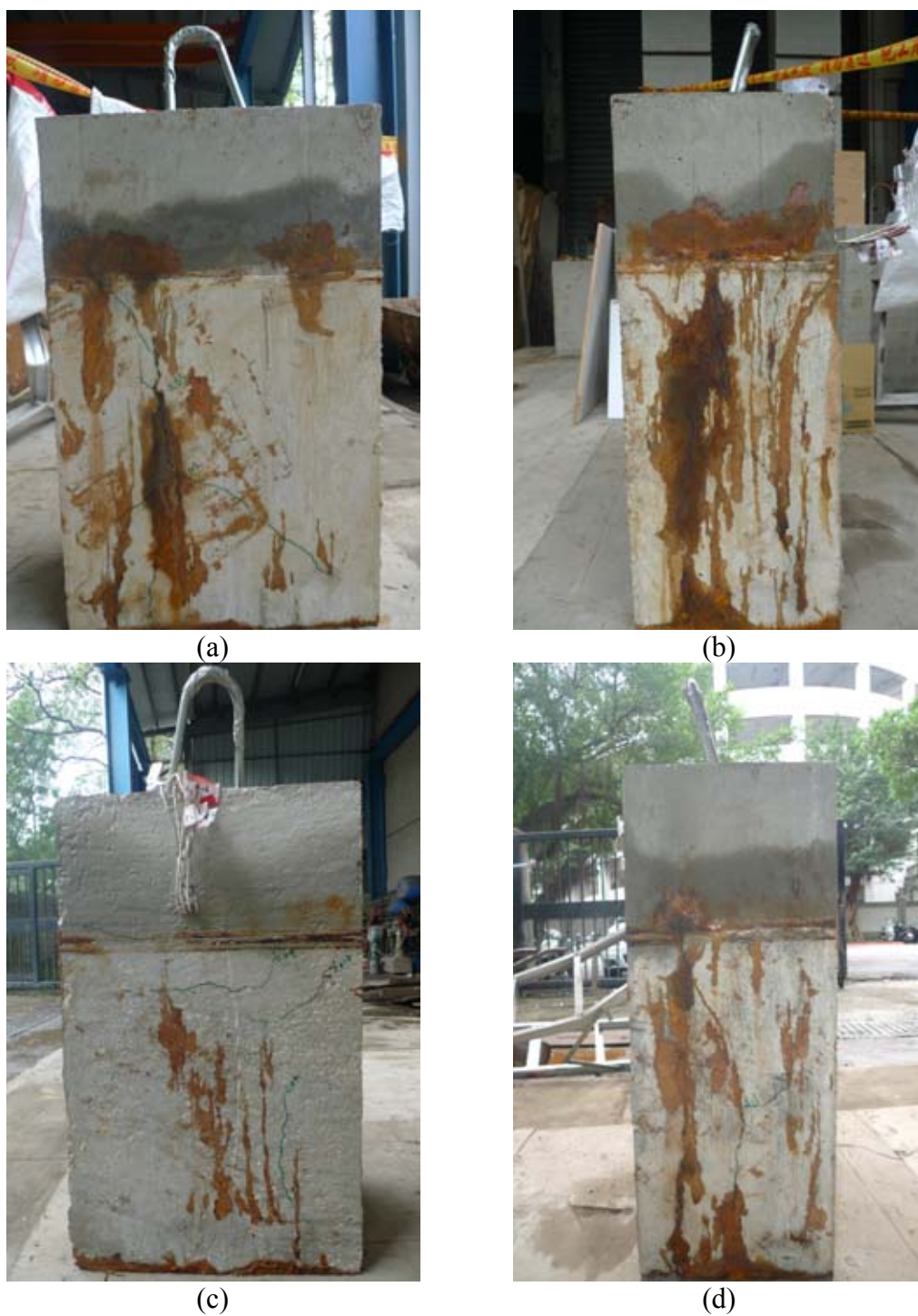
圖 3-23 腐蝕觀察試體橫向鋼筋-重量損失率 11%試體表面的裂縫發展情況：(a)試體前側；(b)試體左側；(c)試體後側；(d)試體右側
