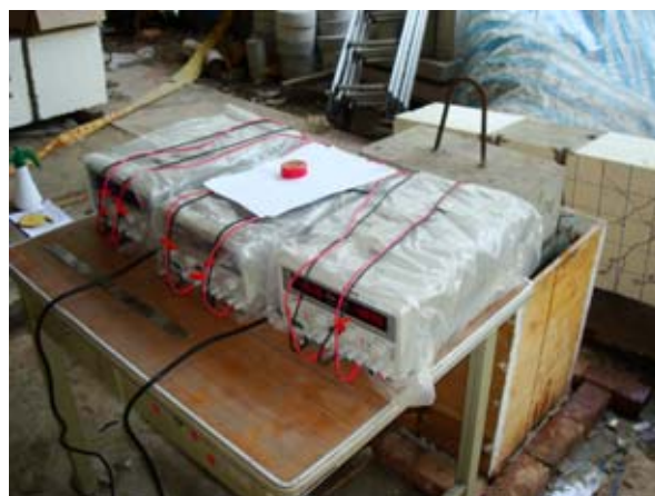
圖 5-18 梁結構構件以通電來加速腐蝕
