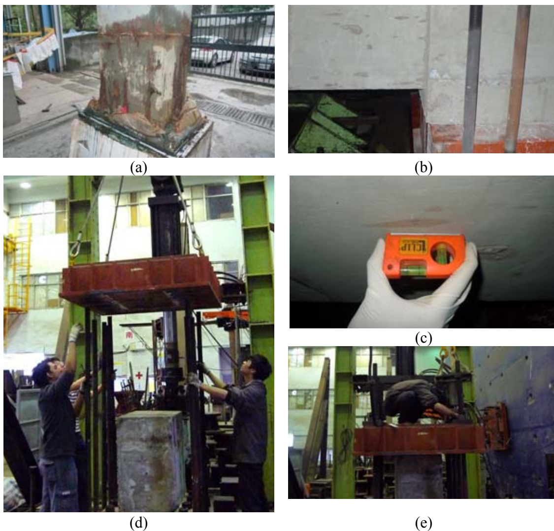
圖 3-15 試體架設程序圖：(a)清理試體表面；(b)試體架設定位；(c)使用水準器確認是否偏心；(d)蓋上上基座；(e)使用油壓機對桿施預力
