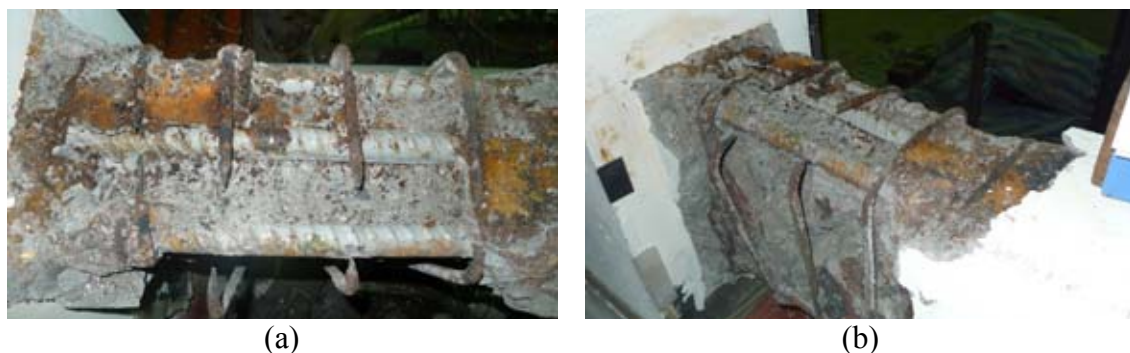
圖 3-53 B t -12 試體破壞情況(a)塑鉸區頂面橫向鋼筋斷裂；(b)塑鉸區頂面橫向鋼筋斷裂
