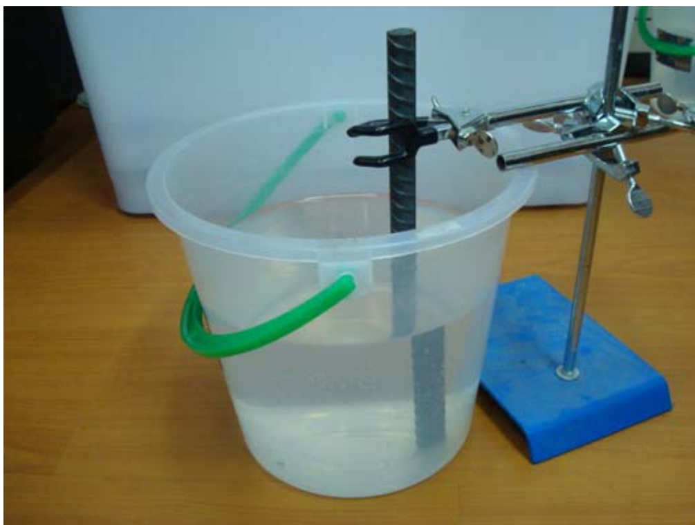
圖5-6 鋼筋固定於水溶液中
