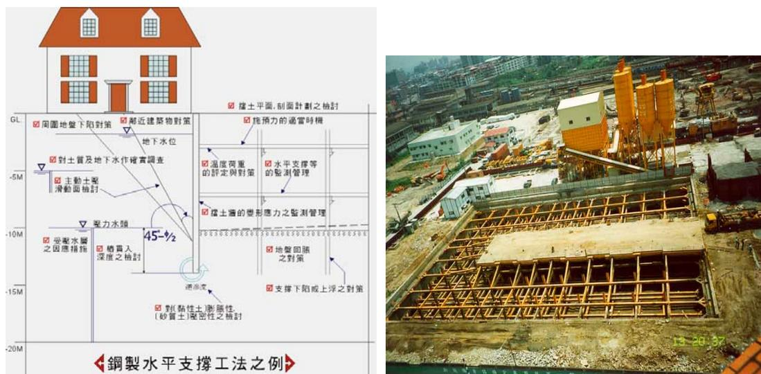
圖 8.5 支撐明挖工法示意圖
