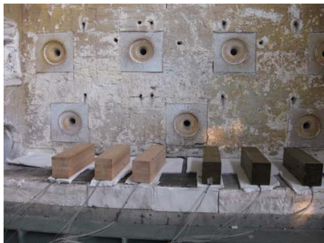
圖 4-1 積層材試體放置於試驗爐之現況
