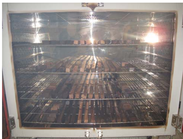
圖 3-12 200℃定溫加熱部份試體開始產生無焰燃燒的現象
