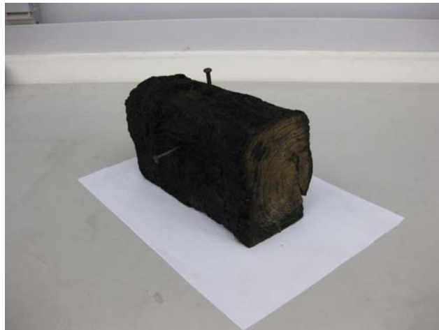
圖 3-10 預備實驗—30 分鐘加熱實驗後試體清除炭化層
