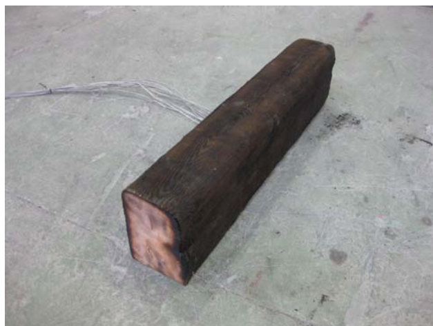
圖 4-6 CNS12514 溫度時間曲線加熱 30 分鐘後試體去除碳化層狀態
