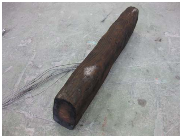
圖 4-5 CNS12514 溫度時間曲線加熱 60 分鐘後試體去除碳化層狀態
