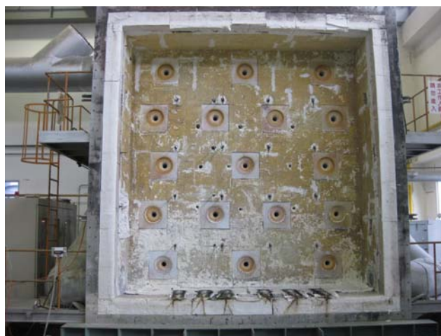
圖 3-2 大型門牆試驗爐
