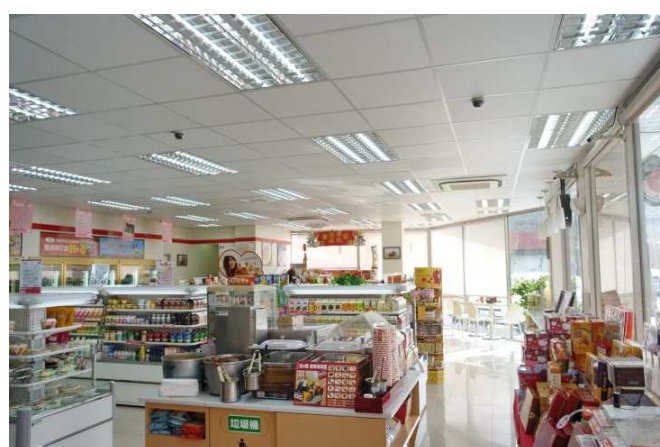
圖 5-20 熱煮設備的上方需避開冷氣出風口
