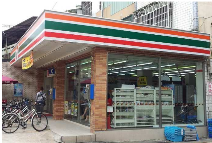
圖 5-18 騎樓或外遮陽深度若不足時應在內側加設遮光窗簾或隔熱紙
