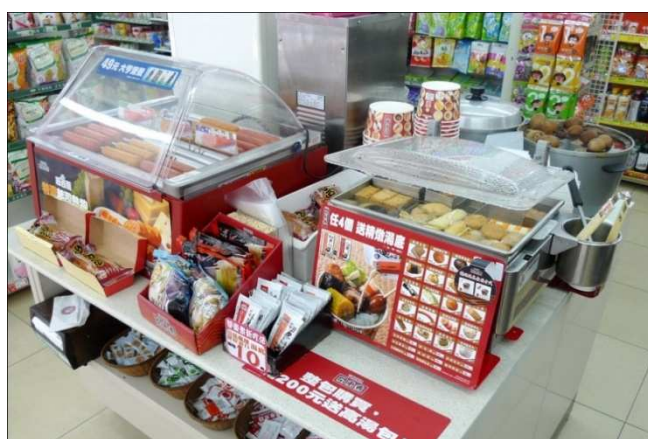
圖 5-19 熱源設備上蓋可降低室內溫度節省空調
