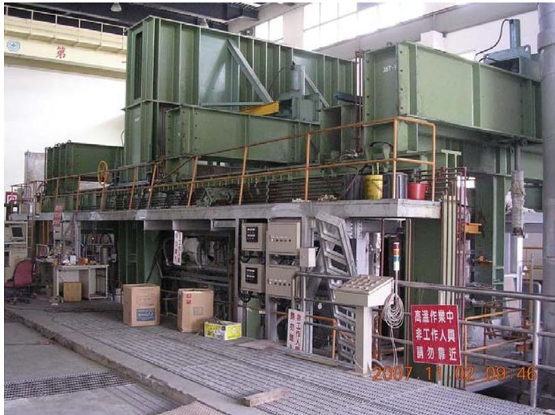
**圖 2-23 加載設備與大型高溫複合爐**
