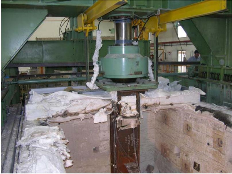
圖 2-21 2000 噸荷重元(Load Cell)
