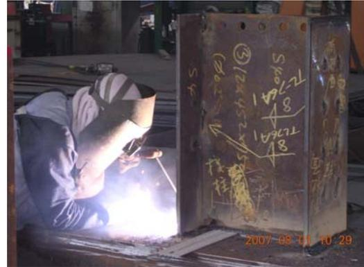
(d) 耐火鋼托梁翼板全滲透銲
