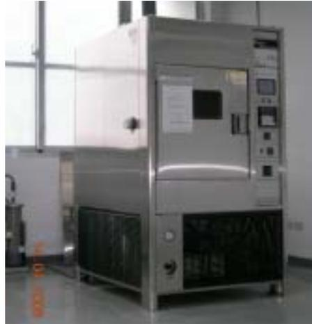
圖 3-1 氙弧燈式日光模擬機 - SUGA X75SC
