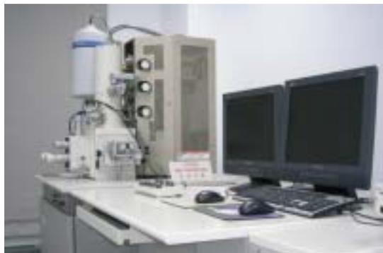
圖 3-3 掃描試電子顯微鏡(SEM)
