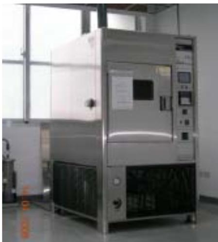
氙弧燈式耐候試驗機 - SUGA X75SC
