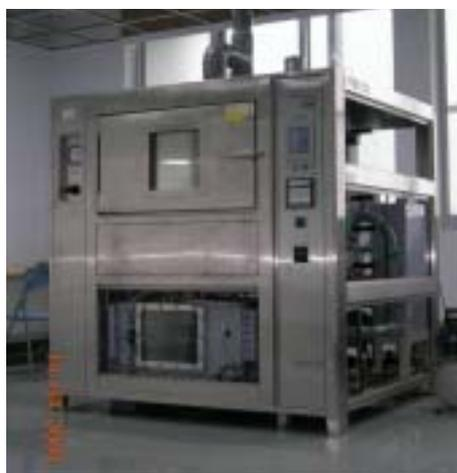
圖 3-2 鹽霧複合耐候試驗機 - SUGA CTP-96
