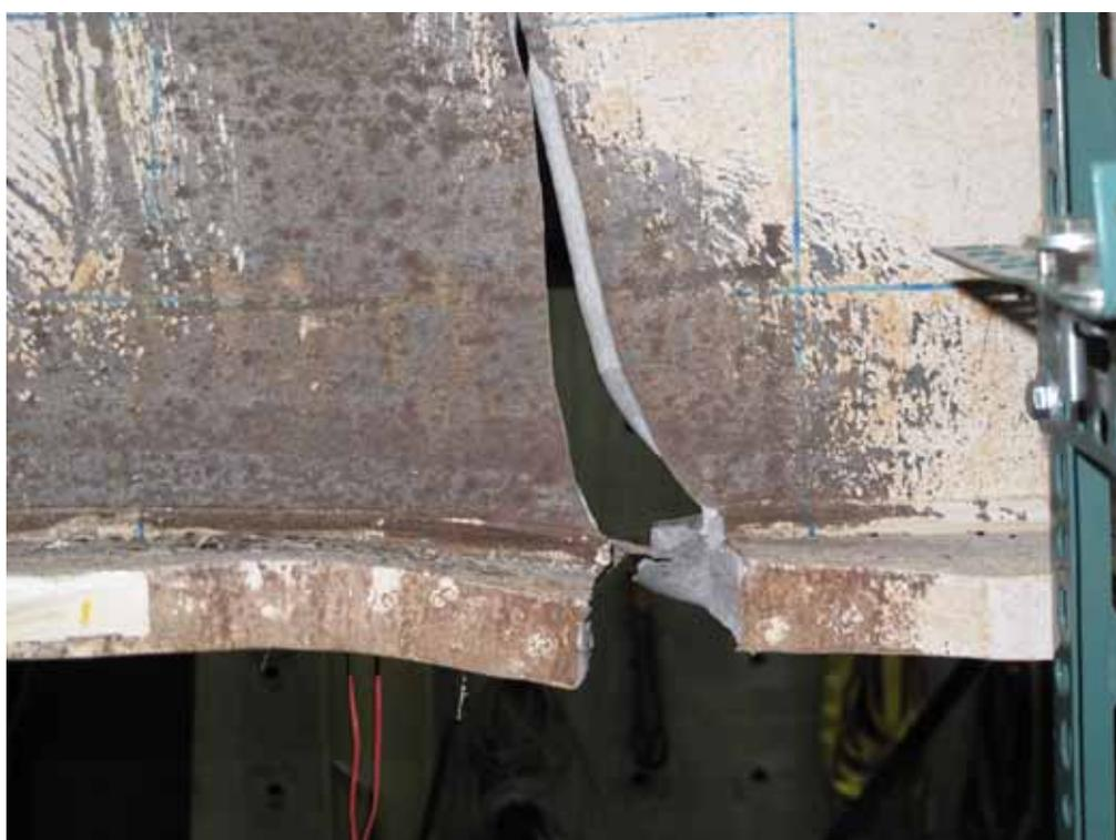
圖 4-23 梁 BM-EGLS 下翼板開裂且向上延伸至腹板
