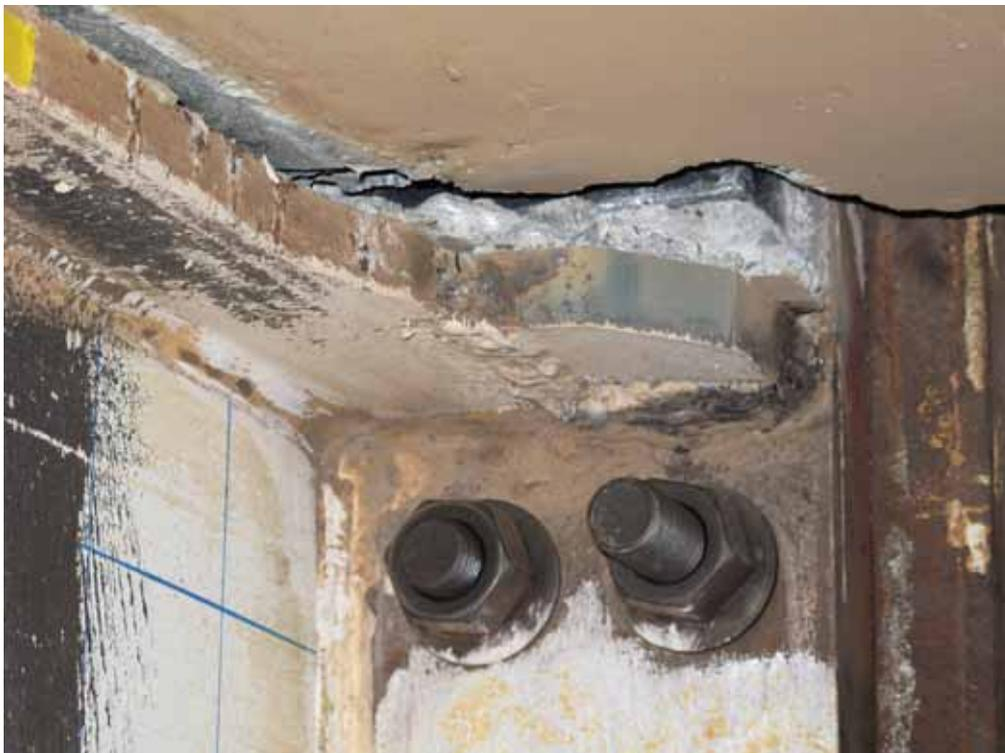
圖 4-18 梁 BM-CC 端點混凝土開裂
