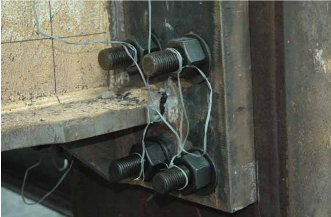
圖 4-16 梁 BM-CC-LS 下翼板與端板間鐸道破裂
