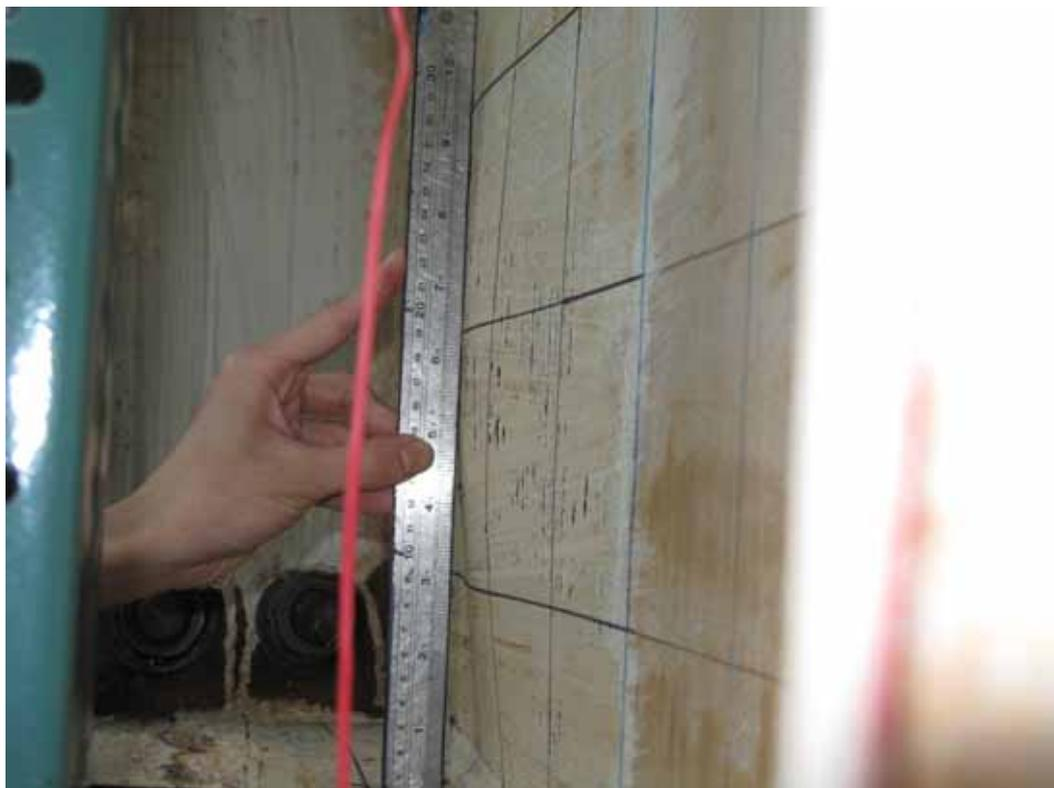
圖 4-24 梁 BM-CC-TS 腹板局部挫屈
