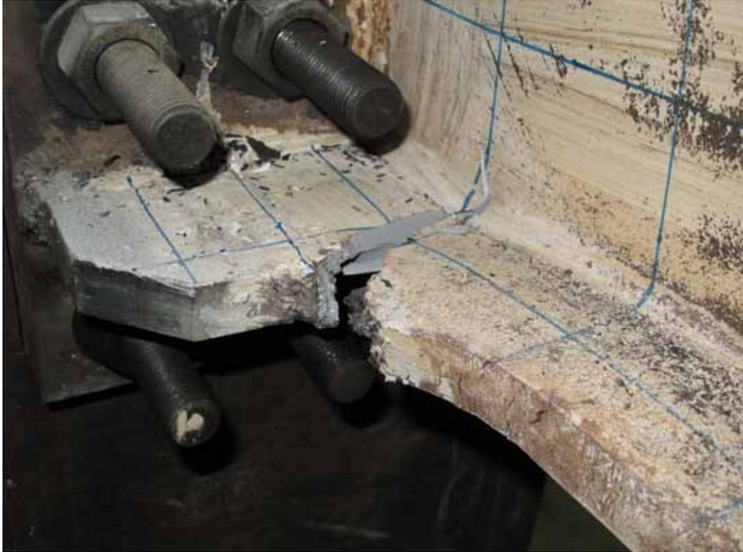
圖 4-19 梁 BM-CC 下翼板破裂
