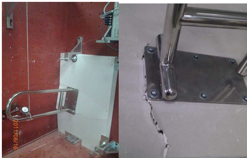
圖 4-10 矽酸鈣板常態載重試驗產生明顯之破壞
