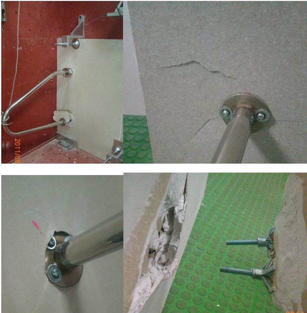
圖 4-13 石膏板承受常態載重試驗之破壞
