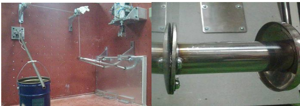
圖 4-14 強化鋁板承受水平載重之常態試驗之破壞
