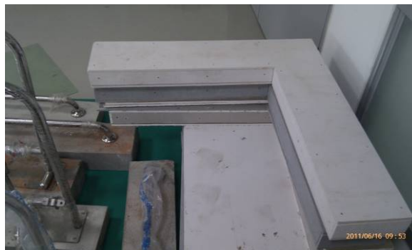
圖 3-10 輕隔間實驗試體與隔板(未安裝扶手)
