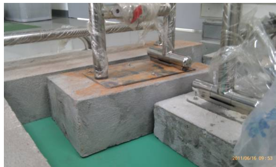
圖 3-13 基材厚度差異(左為磚塊基材、右為水泥基材)
