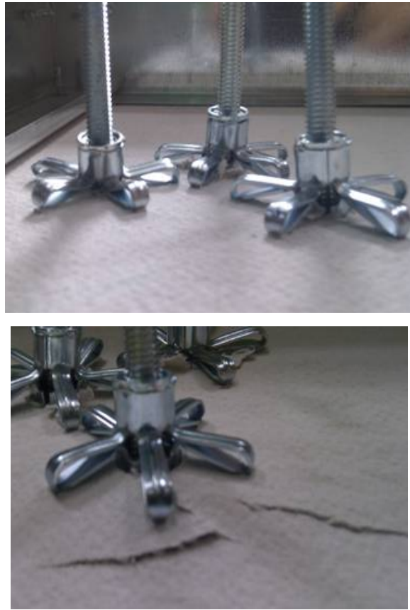
圖 4-3 承受垂直載重產生的拉釘變形與隔板龜裂(矽酸鈣隔板基材)
