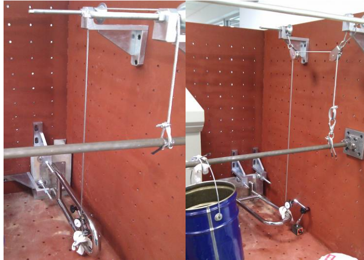
圖 3-33 活動扶手之常態載重測試(磚塊)
