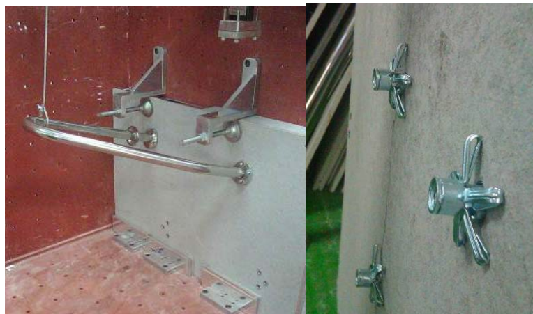
圖 4-12 水泥纖維板承受常態水平載重試驗所產生之破壞
