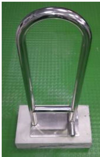
圖 3-11 活動式馬桶扶手實驗試體(水泥基材)
