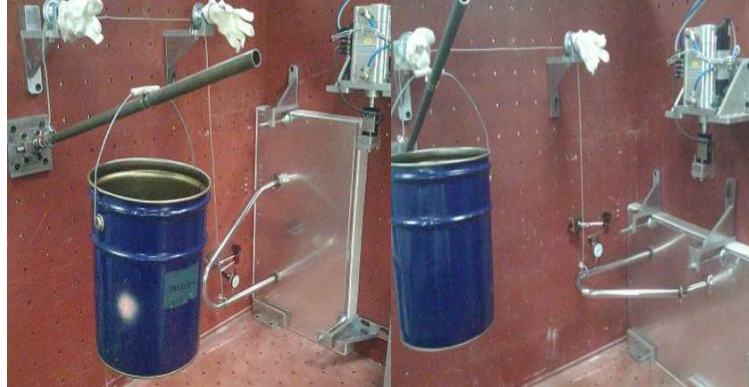
圖 3-35 C 型扶手之常態載重測試(鋁板強化)
