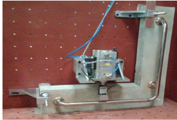
圖 3-21 L型扶手施加垂直載重之測試
