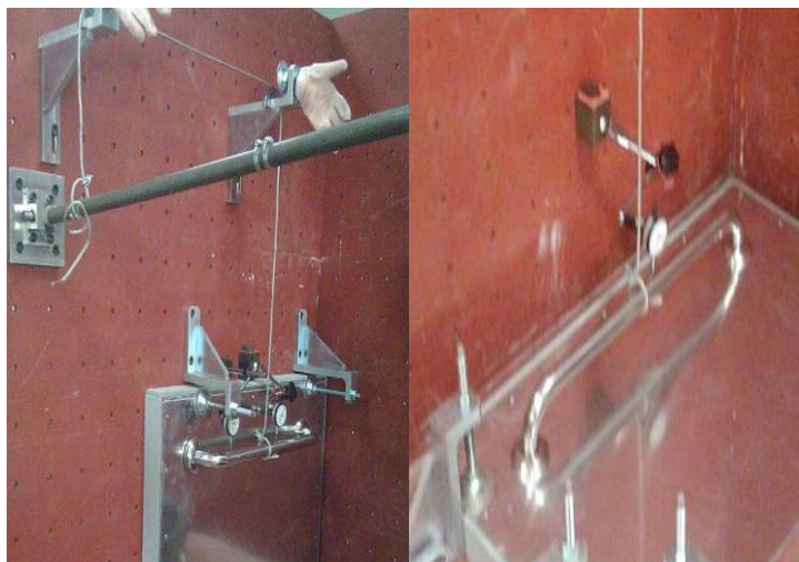
圖 3-34 鋁板強化下之 I 型扶手的常態載重測試
