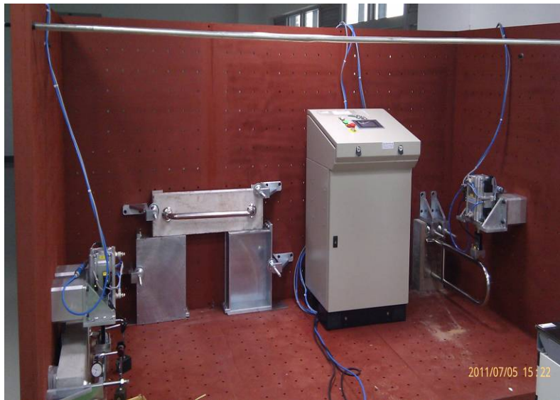
圖 3-1 扶手試驗設備
