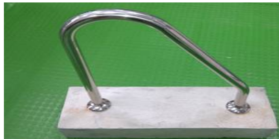
圖 3-8 C 型小便器扶手實驗試體(水泥基材)
