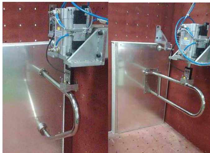
圖 3-23 鋁板強化基材之垂直載重測試
