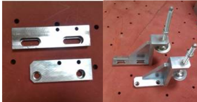
圖 3-16 基材緊迫固定座(兩圖的上方固定座為修改後之固定座)
