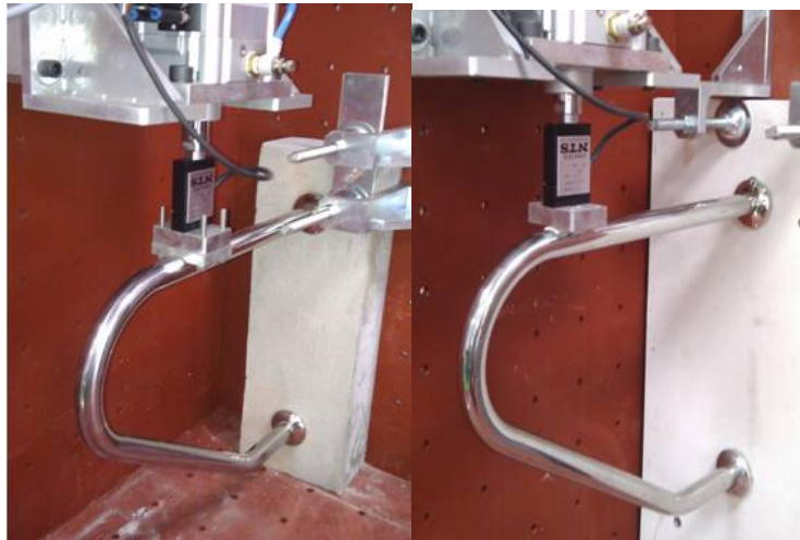
圖 3-18 C 型小便斗扶手施加垂直載重之測試(紅磚、矽酸鈣板)
