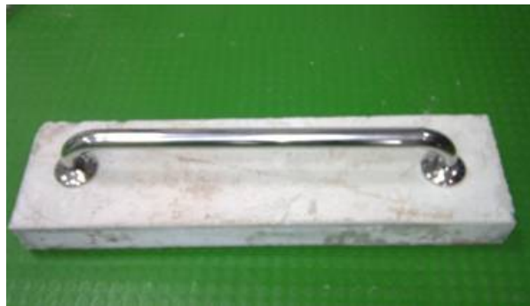
圖 3-7 I 型安全扶手實驗試體(水泥基材)
