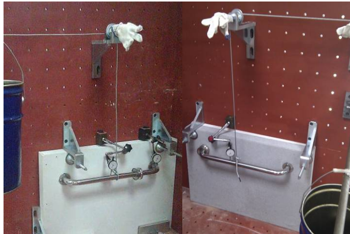
圖 3-29 I 型扶手施加垂直載重之常態載重測試(矽酸鈣板、纖維板)
