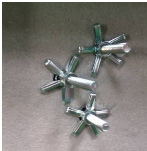
圖 4-6 拉釘結件因承受垂直載重產生的變形(纖維水泥隔板基材)
