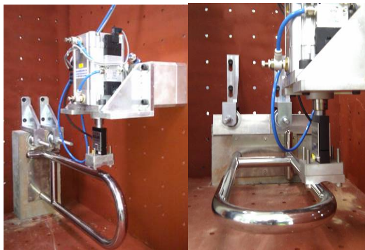
圖 3-20 活動式馬桶扶手施加载重之測試(水泥基材)
