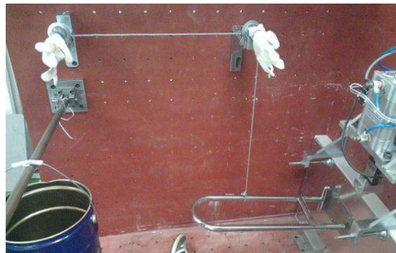
圖 3-36 活動扶手施加水平載重之常態載重測試(鋁板強化)
