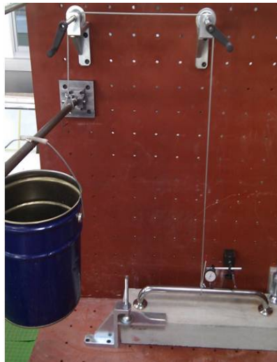
圖 3-30 I 型扶手施加水平載重之常態載重測試
