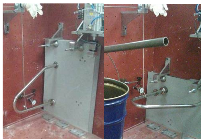
圖 3-32 C 型扶手之常態載重測試(水泥纖維板)
