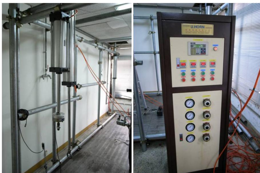
圖 4-2 左：鋼管反力構架及加載用氣壓缸 右：氣壓控制器單元
