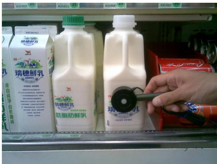
圖 3-2.4 賣場鮮乳製品垂直照度量測
