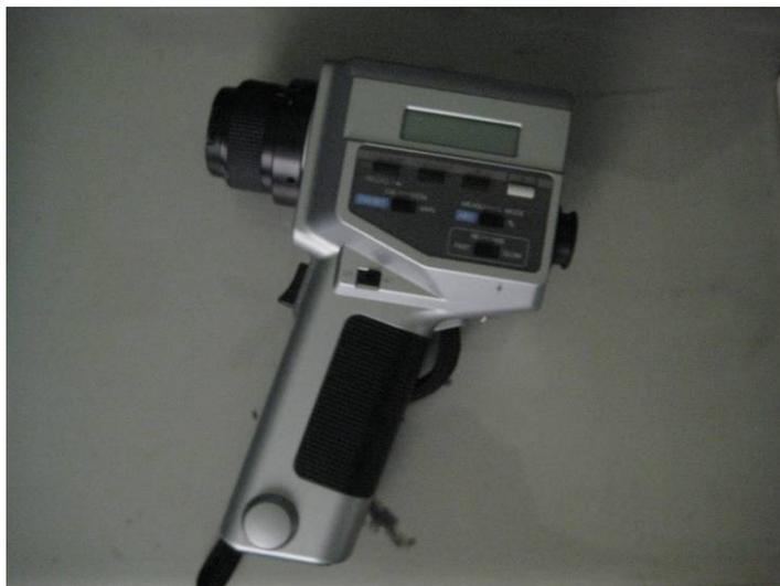
圖 3-2.2 Minolta LS-100 輝度計
