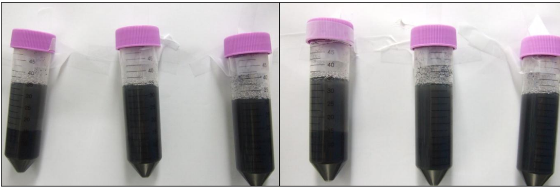
圖 3-6 經過 1.5 小時 左:3%, 2%, 1% 十二烷基苯磺酸鈉/奈米碳管
