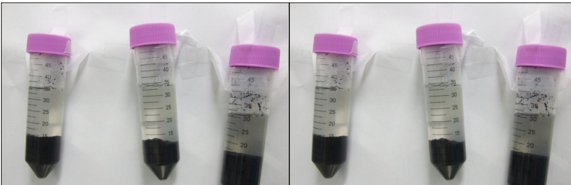
圖 3-7 經過 24 小時 左:3%, 2%, 1% 十二烷基苯磺酸鈉/奈米碳管
