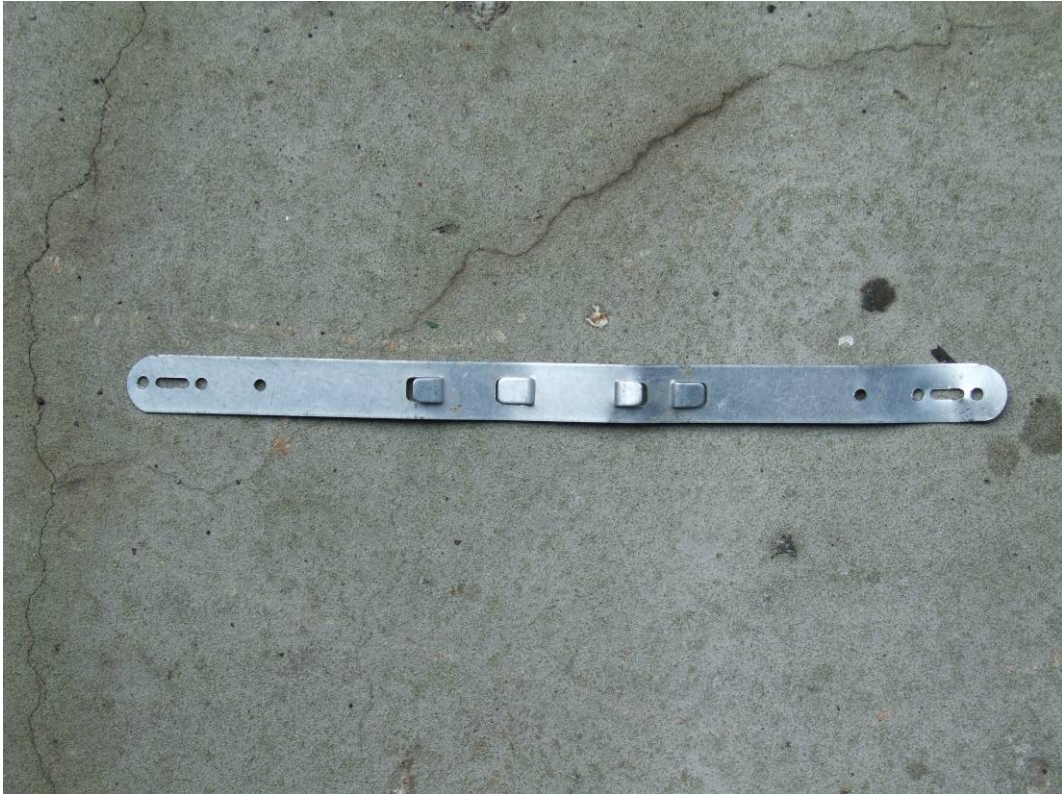
圖2-25 固定片以鋼釘固定於 RC 牆上
