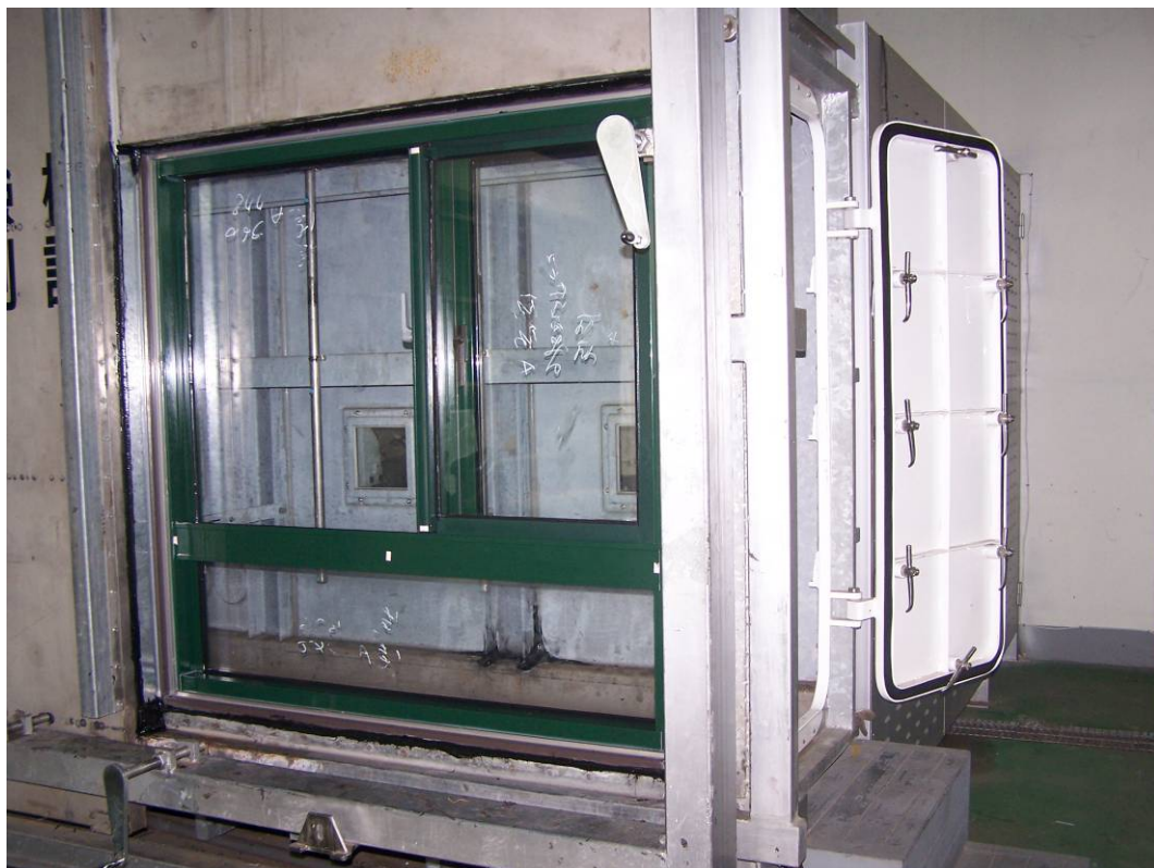
圖3-1 將艙門關起即成一密閉之測試艙
