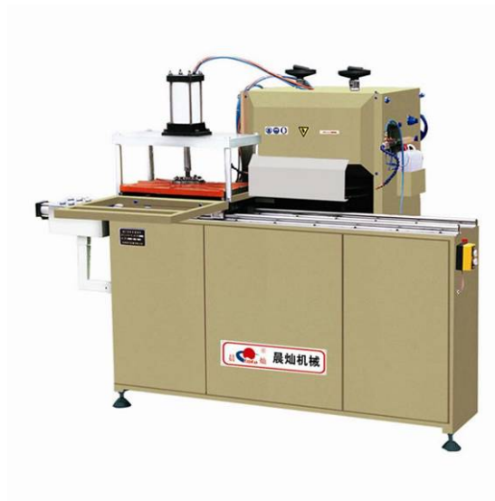
圖2-4 鋁擠型之加工裁切機械
