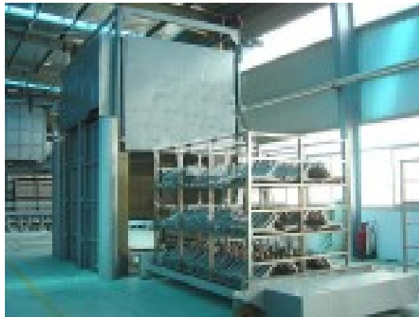
圖4-23 鋁擠型進時效爐加熱強化其強度
