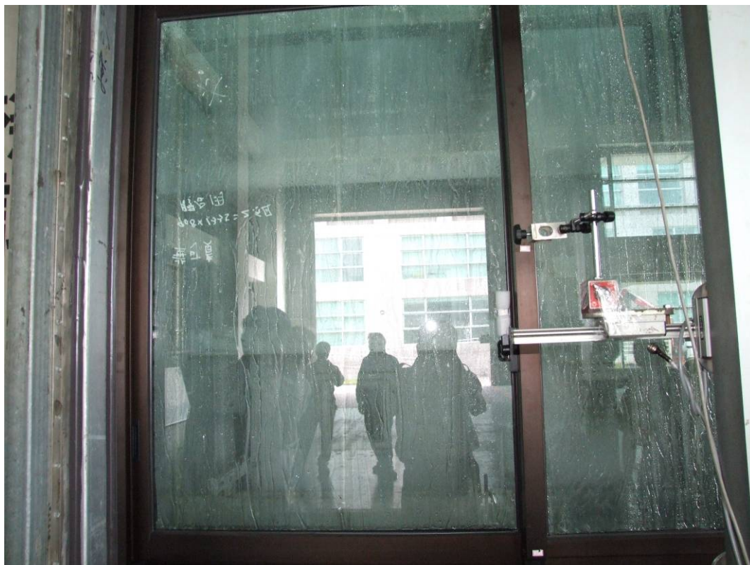
圖3-8 門窗水密試驗進行 資料來源：本研究整理
