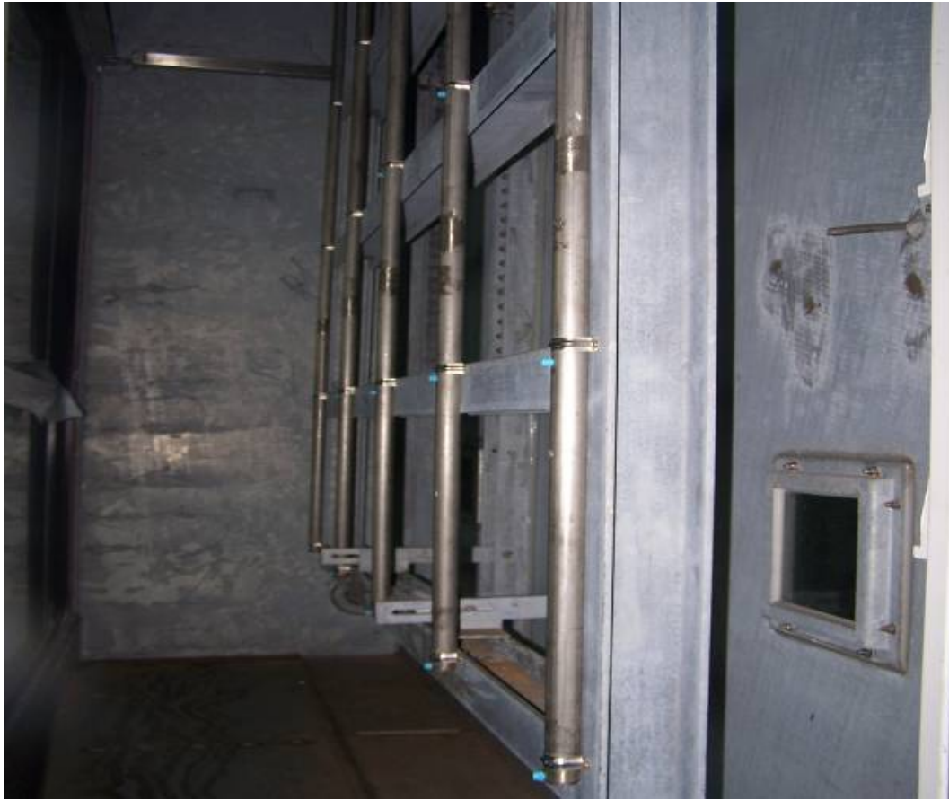
圖3-7 試艙內噴水架 資料來源：本研究整理
