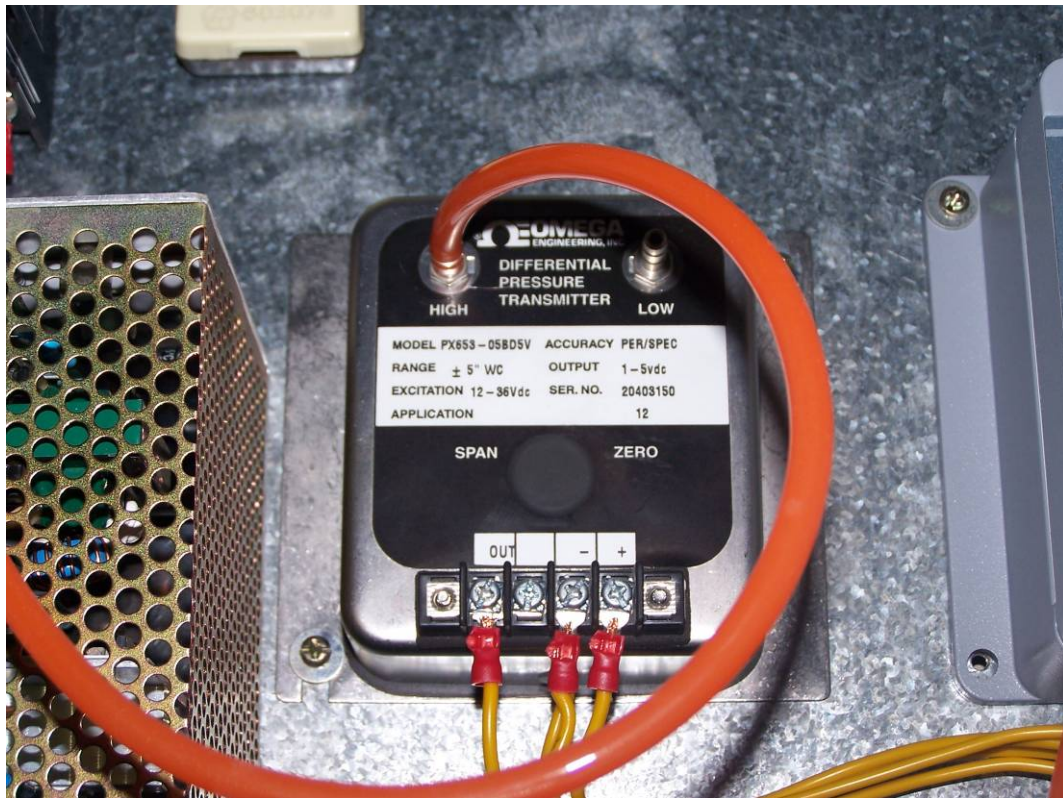
圖3-4 量測測試艙壓力之低壓傳感器
