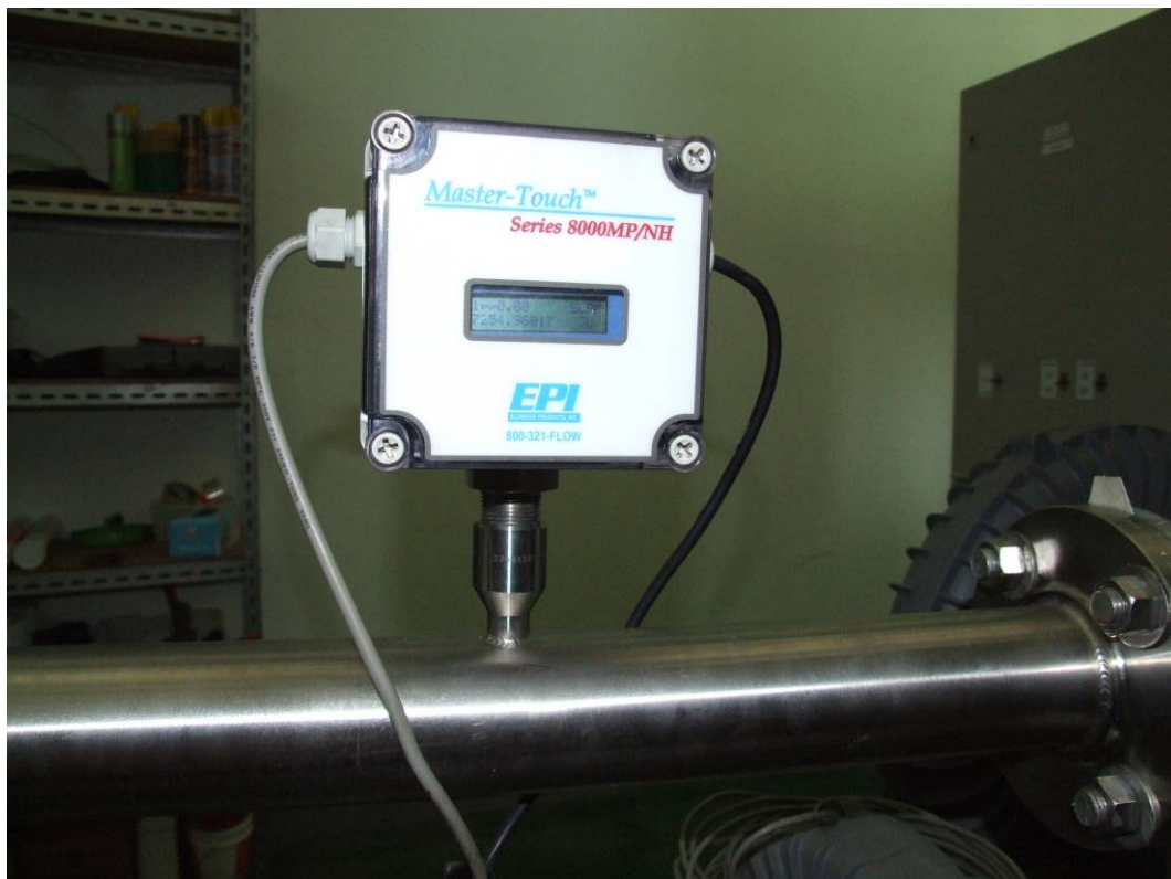
圖3-3 測試門窗漏氣量之空氣流量計
