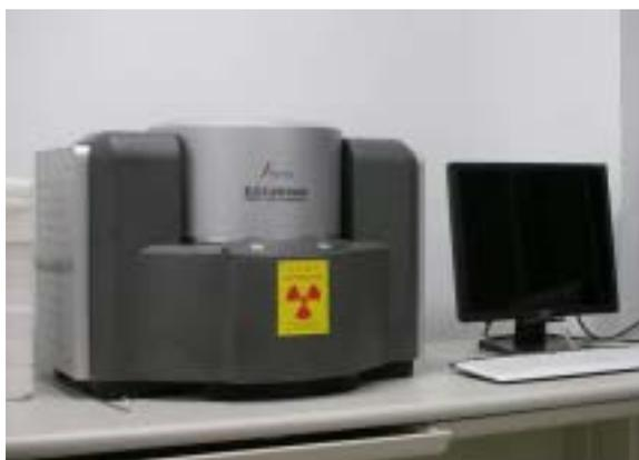
圖 2-5 能量分散式 X 射線螢光光譜分析儀
