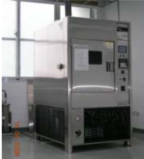
圖 2-4 氬弧燈式日光模擬機 - SUGA X75SC
