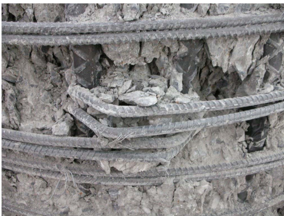
圖 4-14 RC5b-1 試體中央測試段破壞圖(2)
