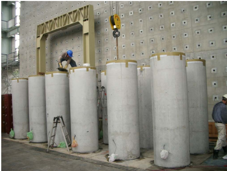
圖 3-31 RC 柱試體拆模後之照片(2)
