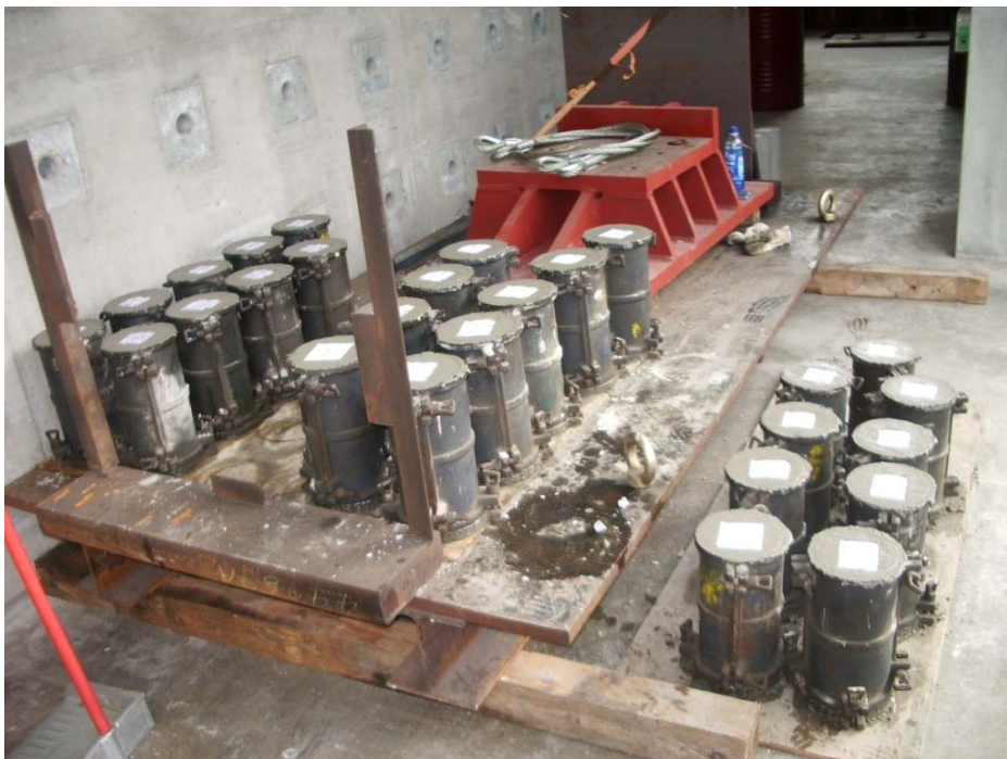
圖 3-28 混凝土圓柱試體製作圖(1)
