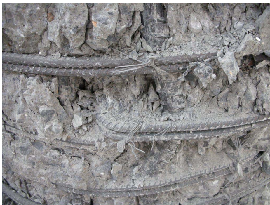
圖 4-22 RC6a-1 試體中央測試段破壞圖(2)
