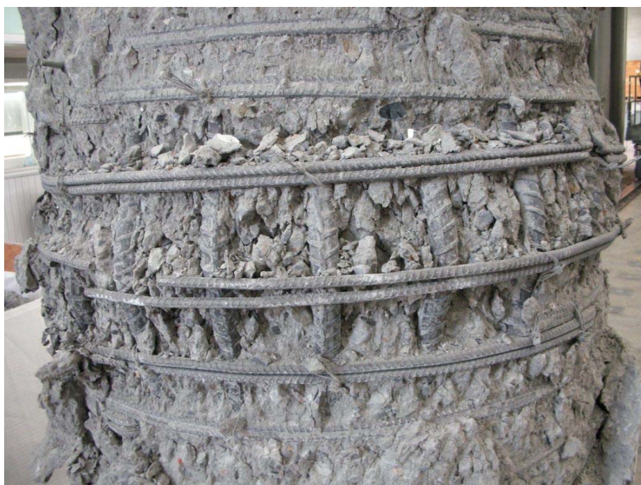
圖 4-18 RC5c-1 試體中央測試段破壞圖(2)
