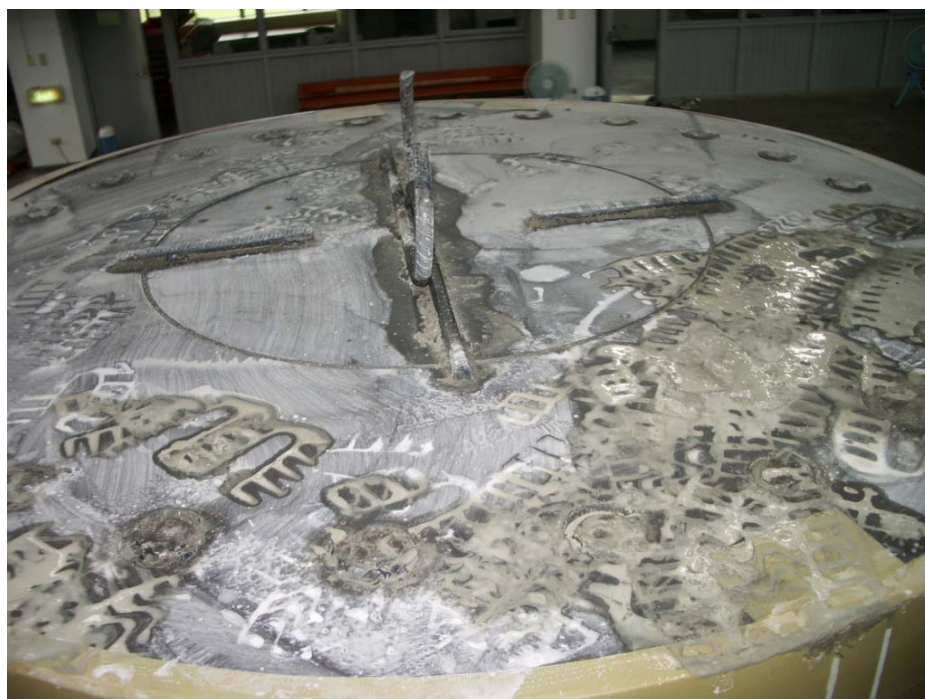
圖 3-33 試體頂部無收縮水泥漿施工圖(2)
