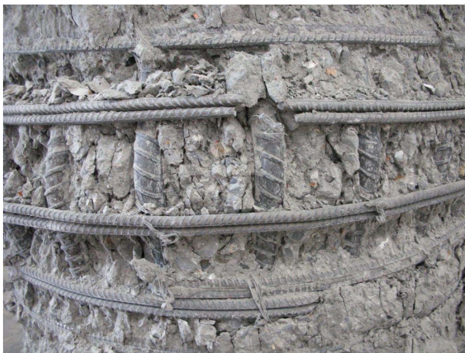
圖 4-17 RC5c-1 試體中央測試段破壞圖(1)
