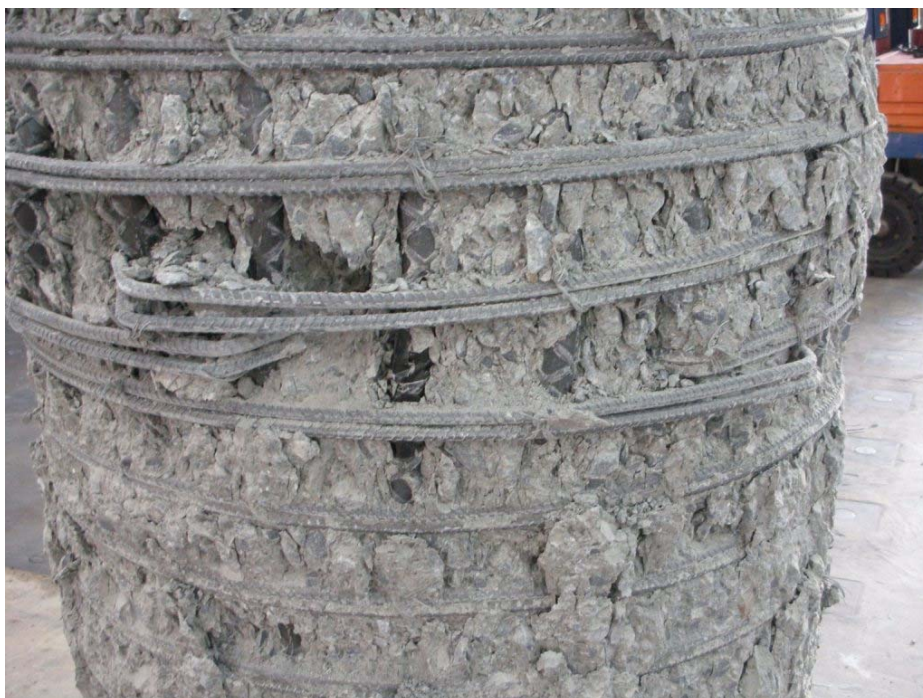
圖 4-13 RC5b-1 試體中央測試段破壞圖(1)
