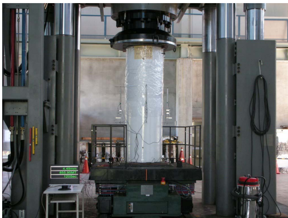
圖 4-1 圓形柱試體外掛軸向變位計圖
