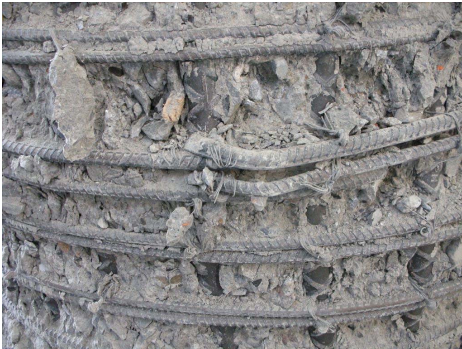
圖 4-15 RC5b-2 試體中央測試段破壞圖(1)
