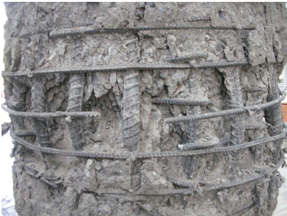
圖 4-28 RC9a-2 試體中央測試段破壞圖(2)
