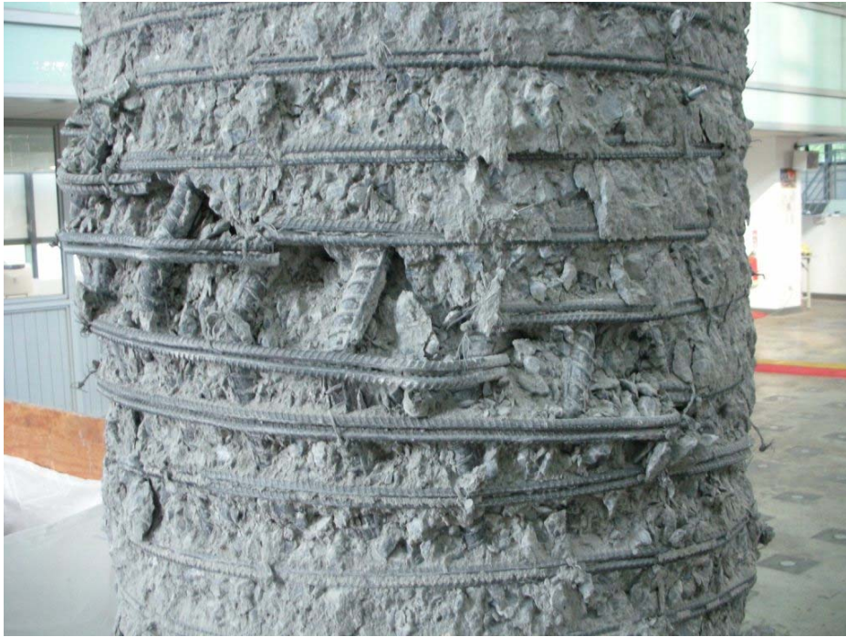
圖 4-7 RC4a-2 試體中央測試段破壞圖(1)
