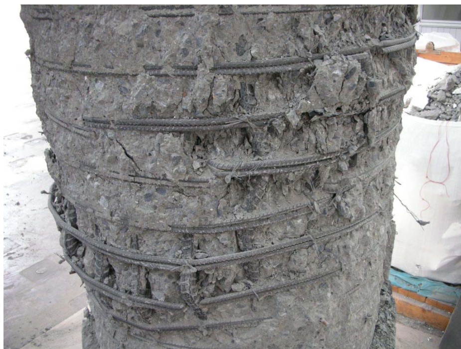
圖 4-21 RC6a-1 試體中央測試段破壞圖(1)
