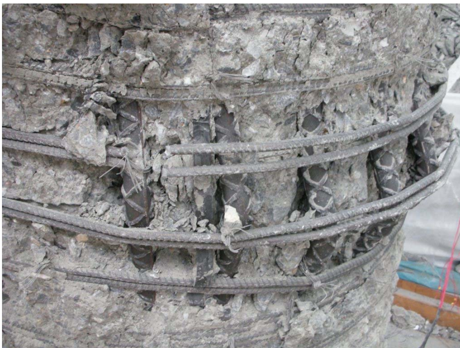
圖 4-12 RC5a-2 試體中央測試段破壞圖(2)
