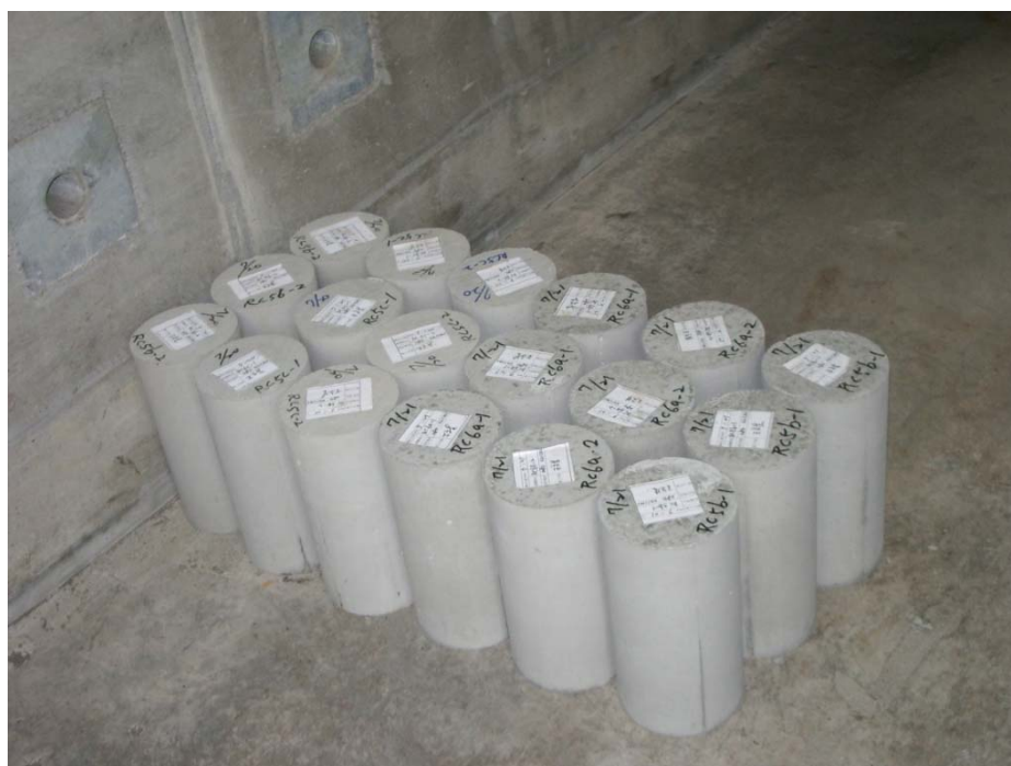
圖 3-29 混凝土圓柱試體製作圖(2)
