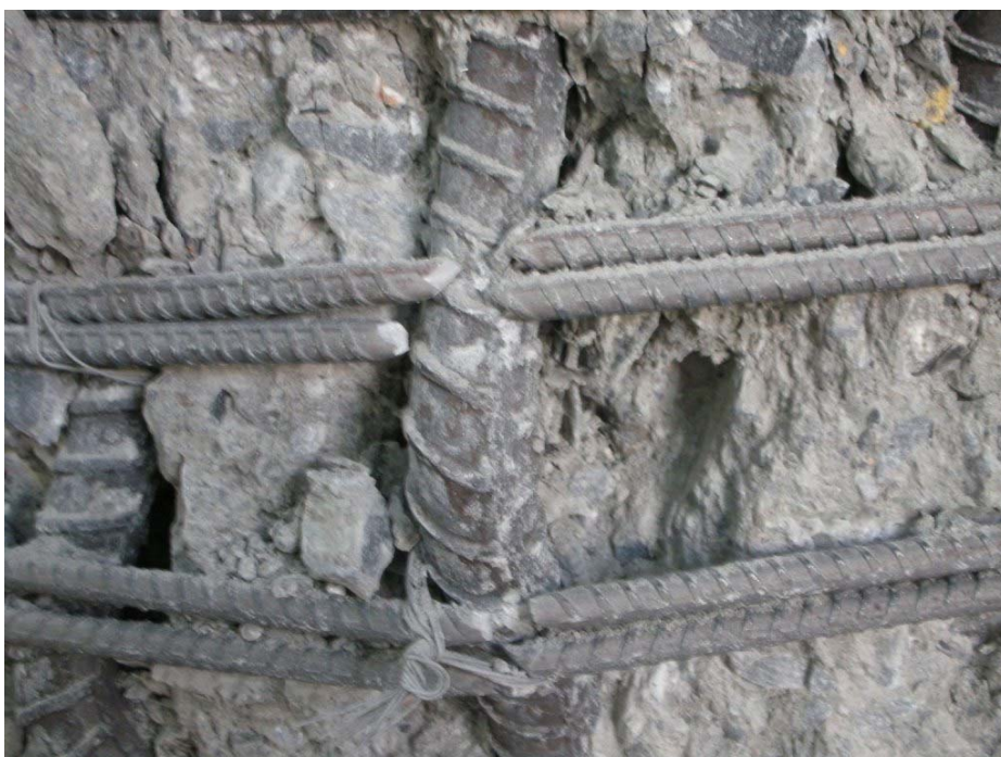
圖 4-10 RC5a-1 試體中央測試段破壞圖(2)
