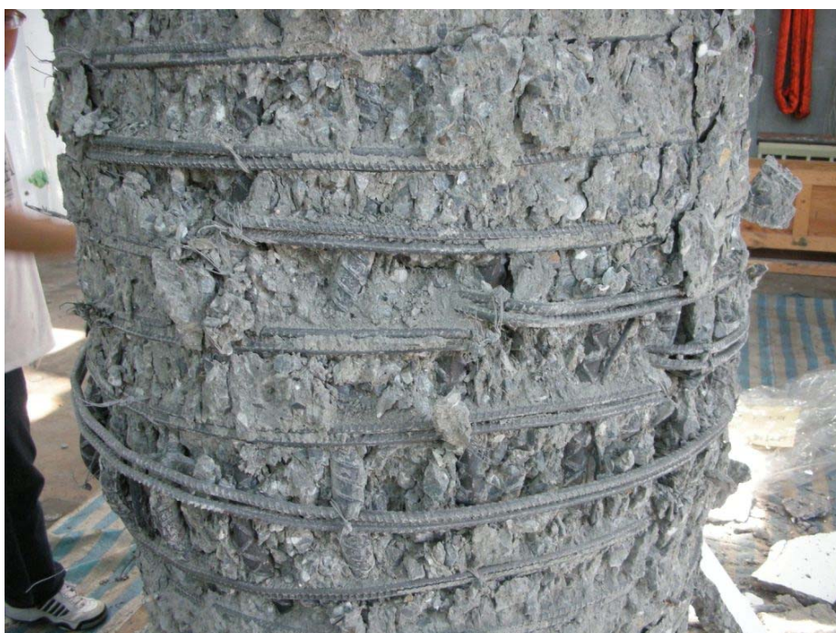
圖 4-6 RC4a-1 試體中央測試段破壞圖(2)
