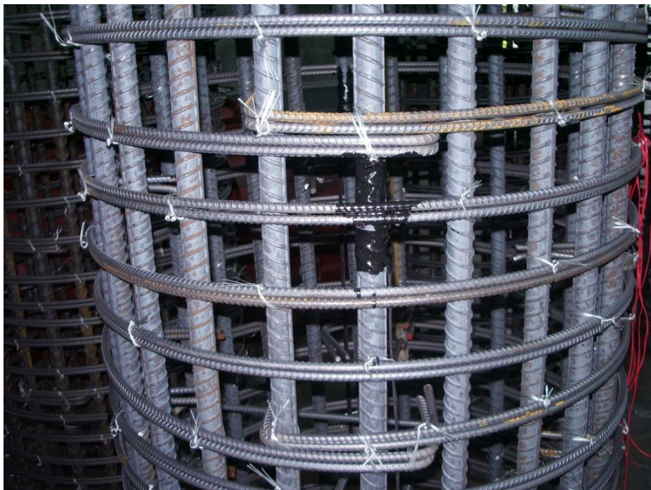
圖 3-16 RC5c-1 試體中央測試段鋼筋組立圖
