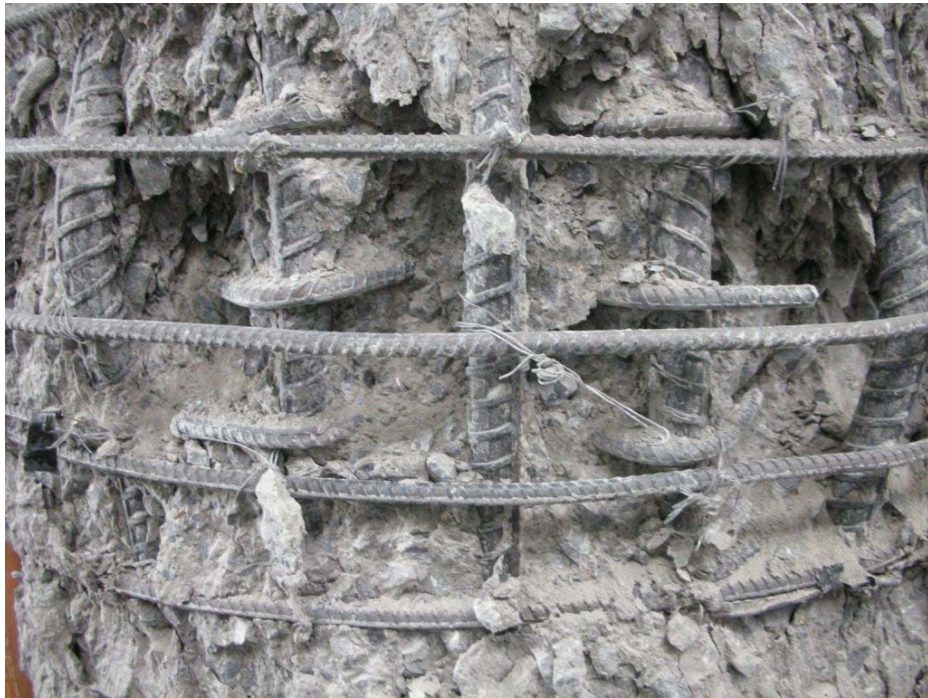
圖 4-27 RC9a-2 試體中央測試段破壞圖(1)
