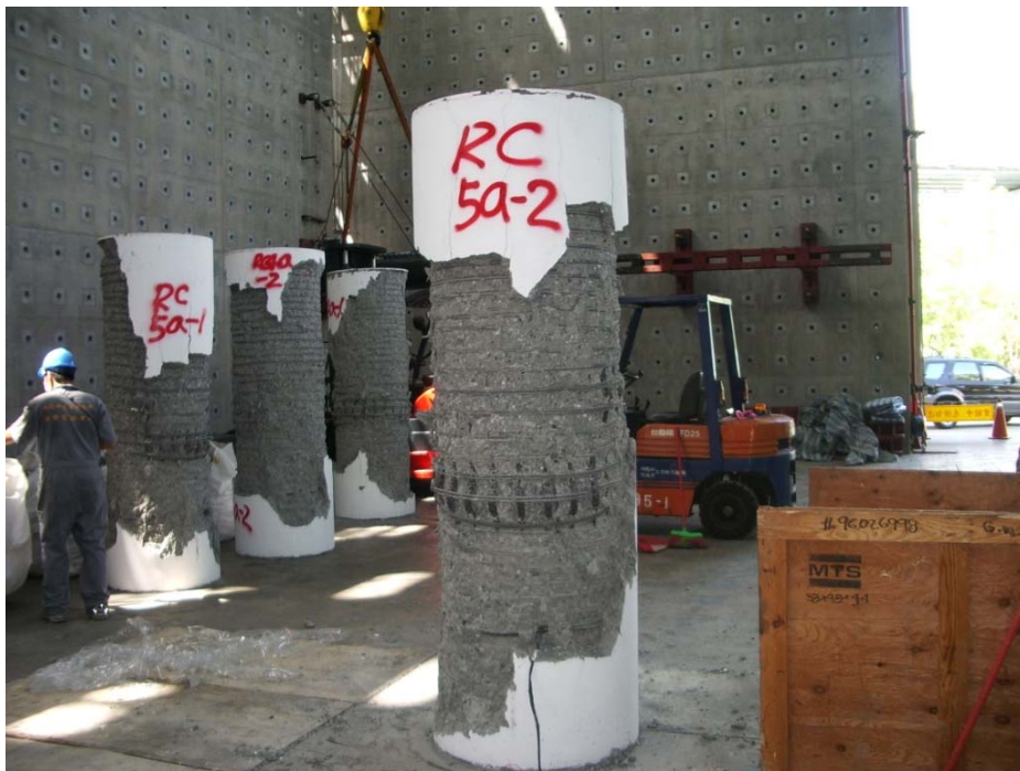
圖 4-3 圓形柱試體典型破壞圖(1)
