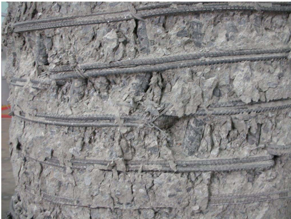
圖 4-24 RC6a-2 試體中央測試段破壞圖(2)
