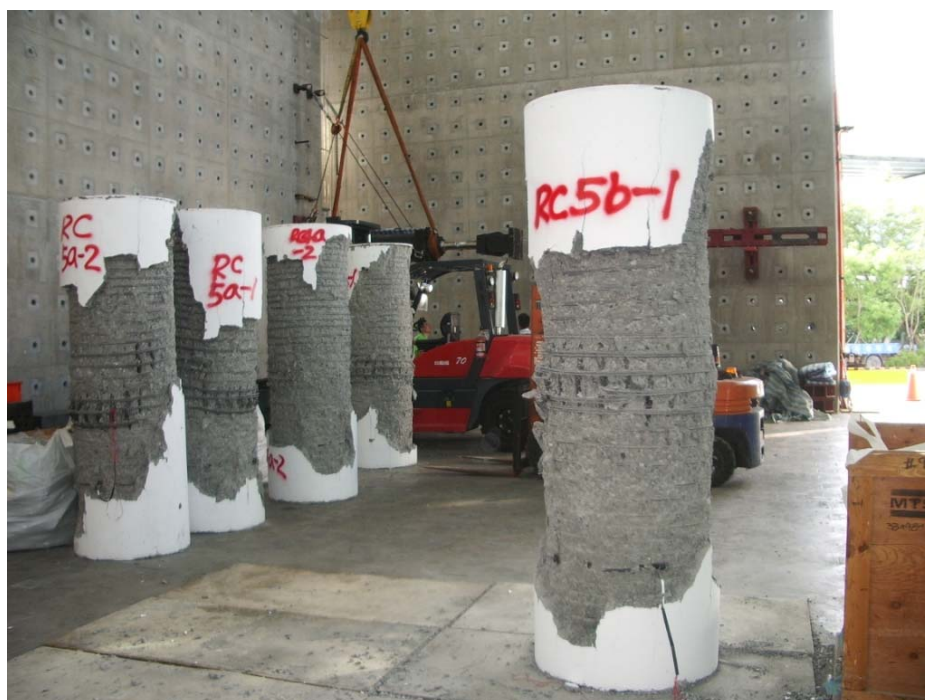
圖 4-4 圓柱試體典型破壞圖(2)
