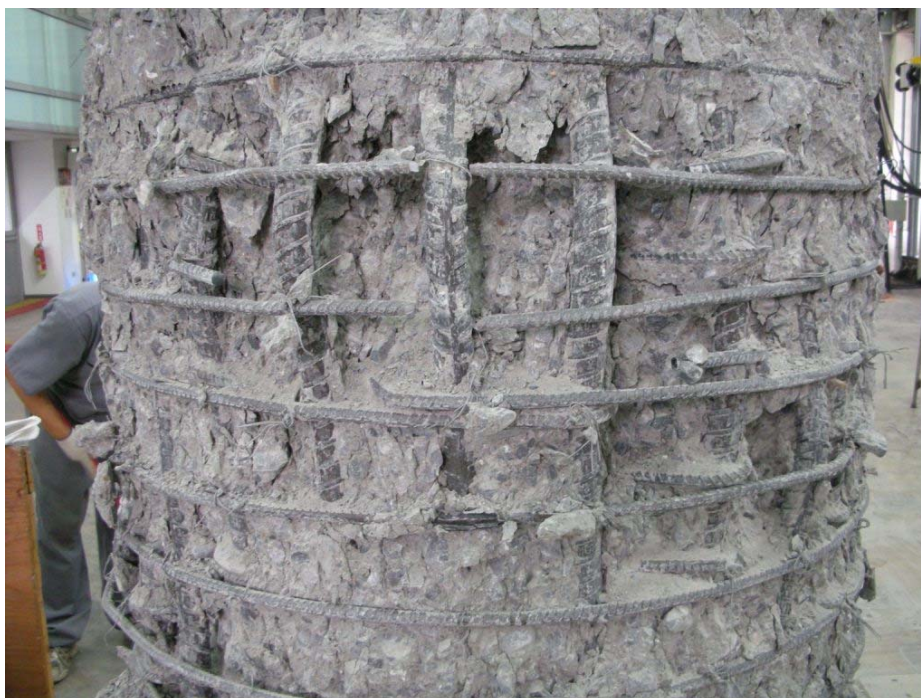
圖 4-25 RC9a-1 試體中央測試段破壞圖(1)
