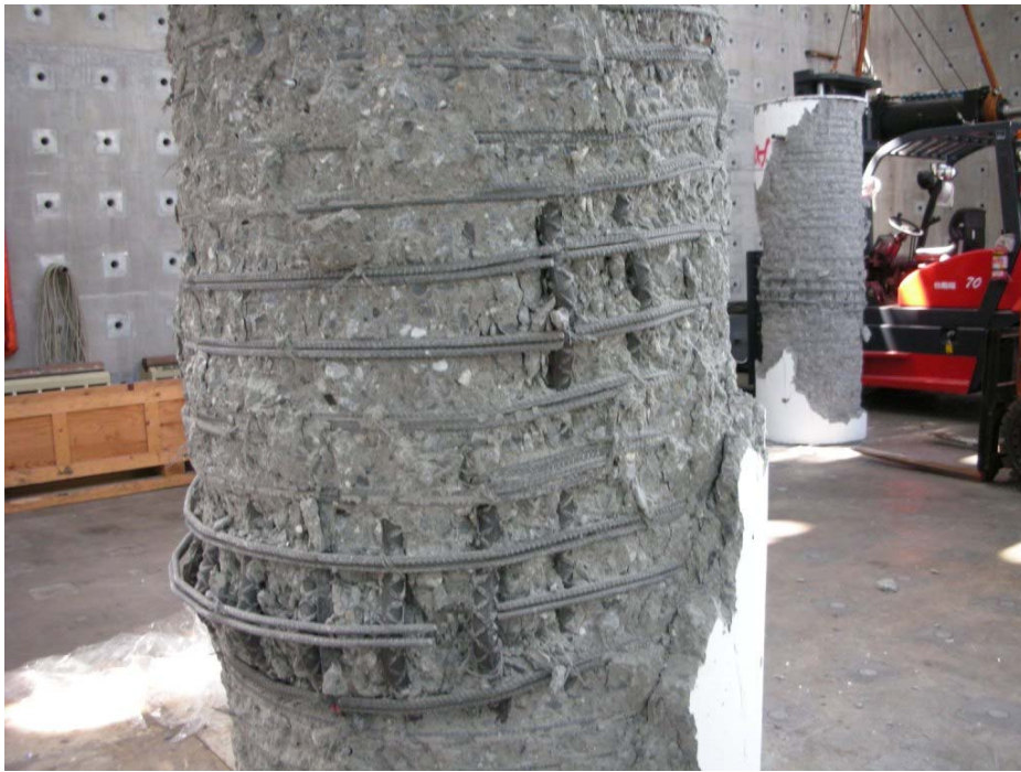
圖 4-11 RC5a-2 試體中央測試段破壞圖(1)
