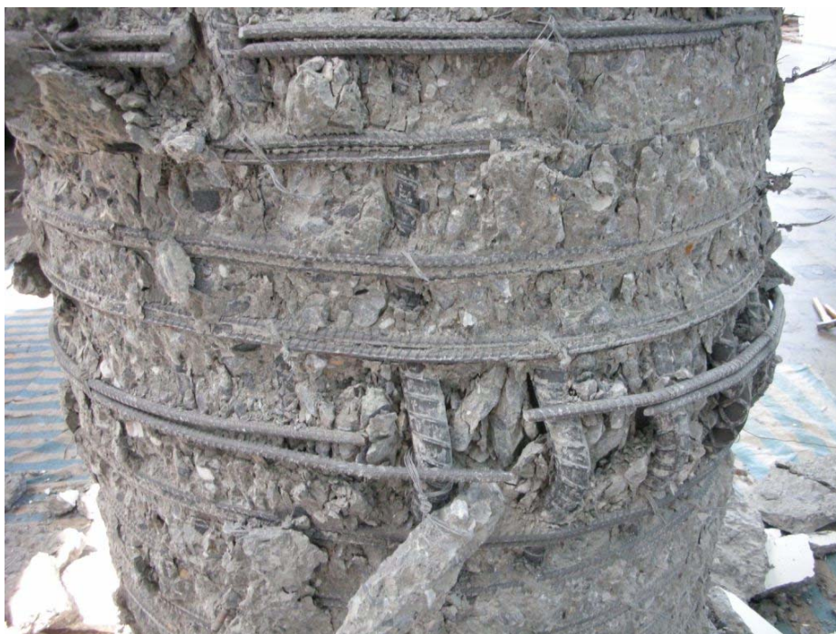
圖 4-5 RC4a-1 試體中央測試段破壞圖(1)
