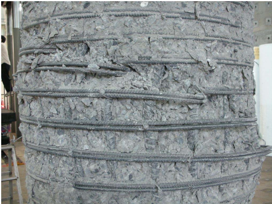
圖 4-8 RC4a-2 試體中央測試段破壞圖(2)
