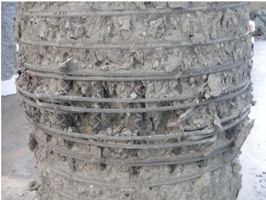
圖 4-16 RC5b-2 試體中央測試段破壞圖(2)
