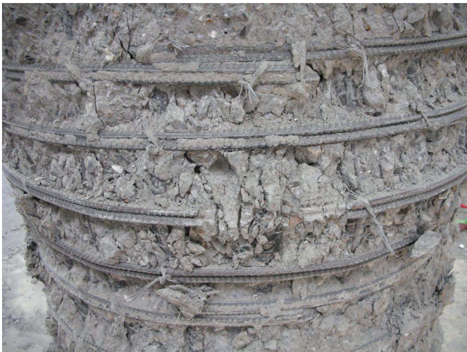
圖 4-20 RC5c-2 試體中央測試段破壞圖(2)
