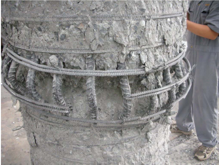
圖 4-23 RC6a-2 試體中央測試段破壞圖(1)
