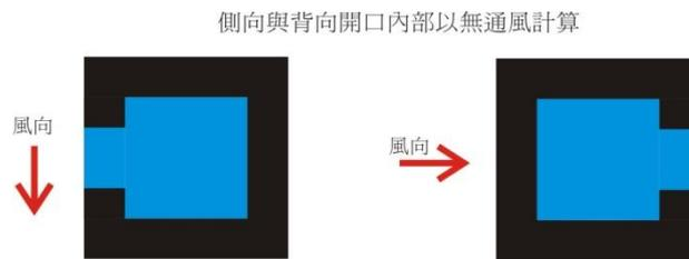
**圖 4- 30 側向與背向開口時通風計算示意(深色部分為不通風)局影響程度**
