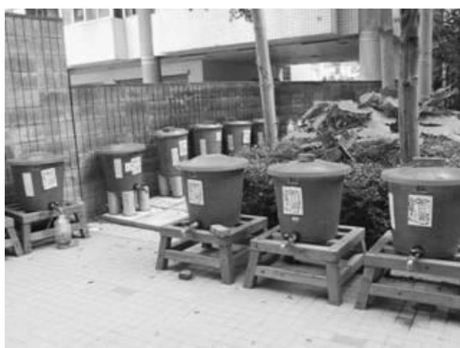
**圖 4-1 台中某社區採完全發酵方式之廚餘堆肥處理**
