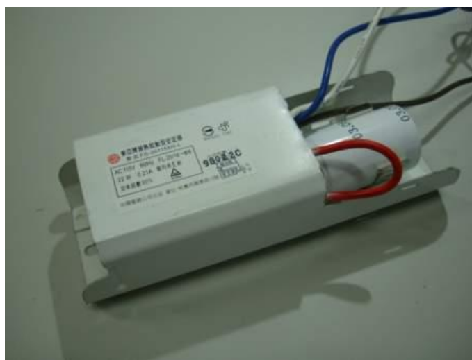
圖 2-31 預熱型傳統安定器外觀
