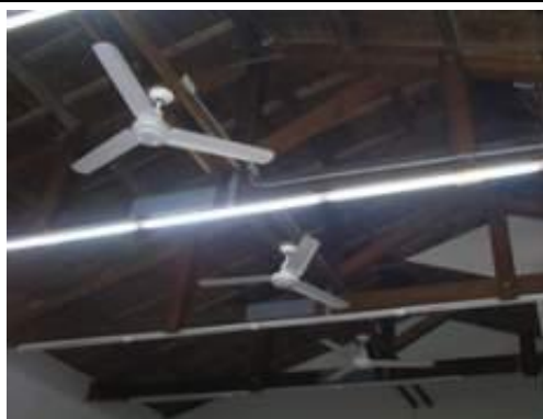
圖 1-8 室內輝度分佈不均示意照片 天花與燈具對比過於強烈，易造成眼睛不適與疲勞
