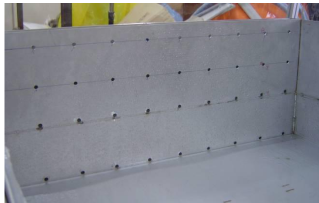
圖 5-5 試驗單元排水孔洞
