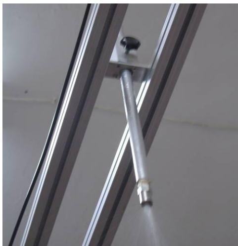
圖 5-2 人工降雨模擬器-噴頭
