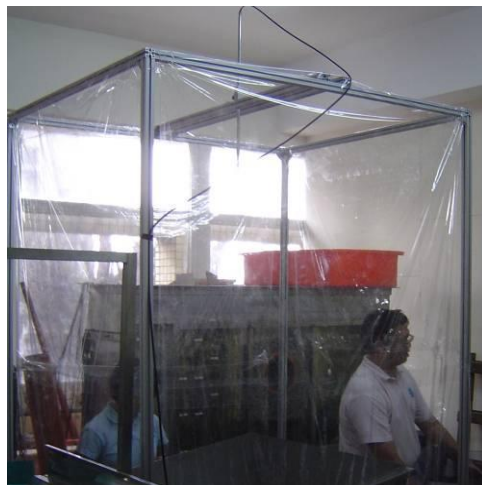
圖 5-1 人工降雨模擬系統
