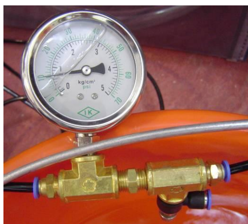
圖 5-3 人工降雨模擬器-水壓表及壓力閥
