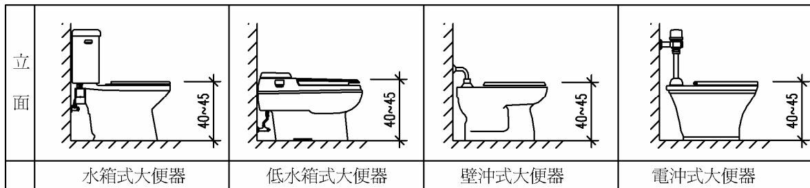
圖 4-7 各類型座式大便器平立圖(單位：cm)
