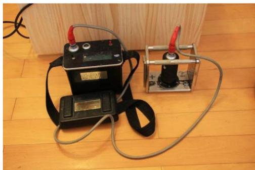
圖 1-4 攜帶式傾斜儀及測讀設備
